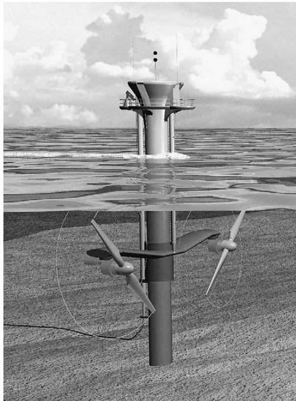
Slika 18. Turbine postavljene na stupu [3]
