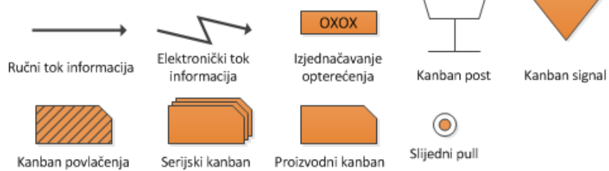
Slika 15 – Prikaz osnovnih simbola mapiranja toka vrijednosti [16]
