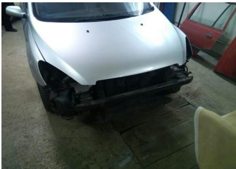
Slika 22 – Osobni automobil nakon demontaže prednjeg branika
