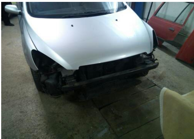
Slika 22 – Osobni automobil nakon demontaže prednjeg branika
