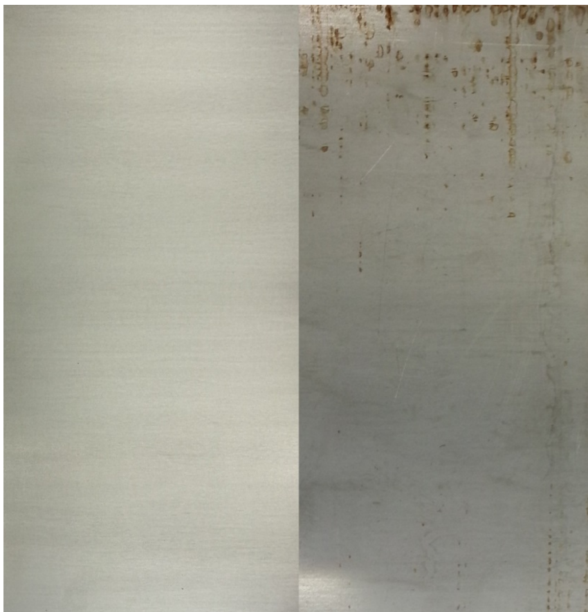
Slika 53. Prikaz površinske pripreme osnovnog materijala, lijevo-očišćeno, desno-neočišćeno
