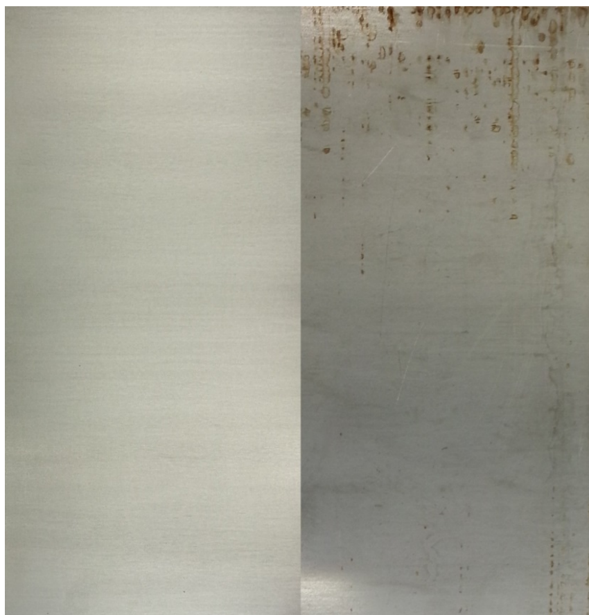
Slika 53. Prikaz površinske pripreme osnovnog materijala, lijevo-očišćeno, desno-neočišćeno
