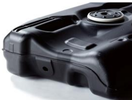
Slika 12. Rezervoar za gorivo izrađen od PE-HD s membranom od EVOH kopolimera [11]
