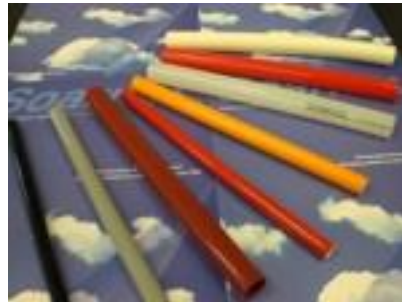
Slika 11. Cijevi za podno grijanje od različitih polimera s membranom EVOH kopolimera. [11]
