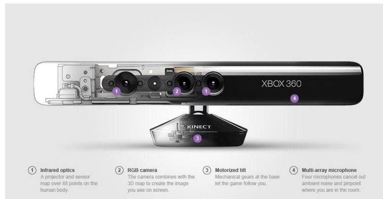
Slika 8 MS Kinect opis komponenata
