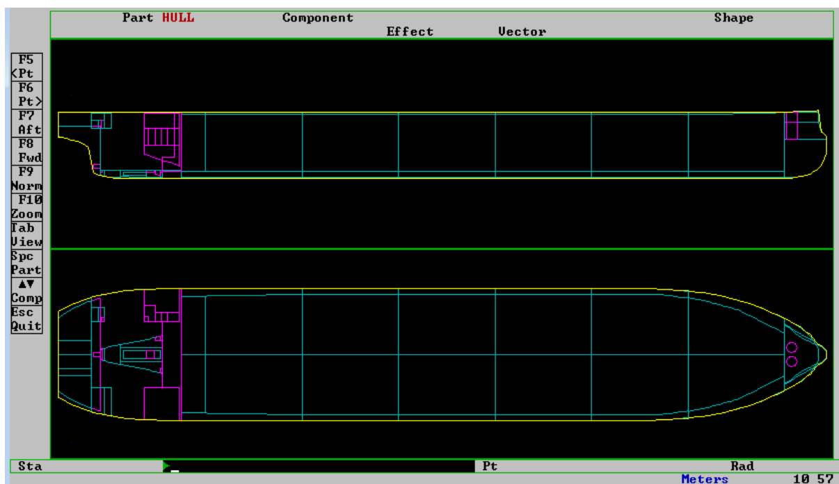
Slika 6. Geometrijski model tankera u programu GHS
