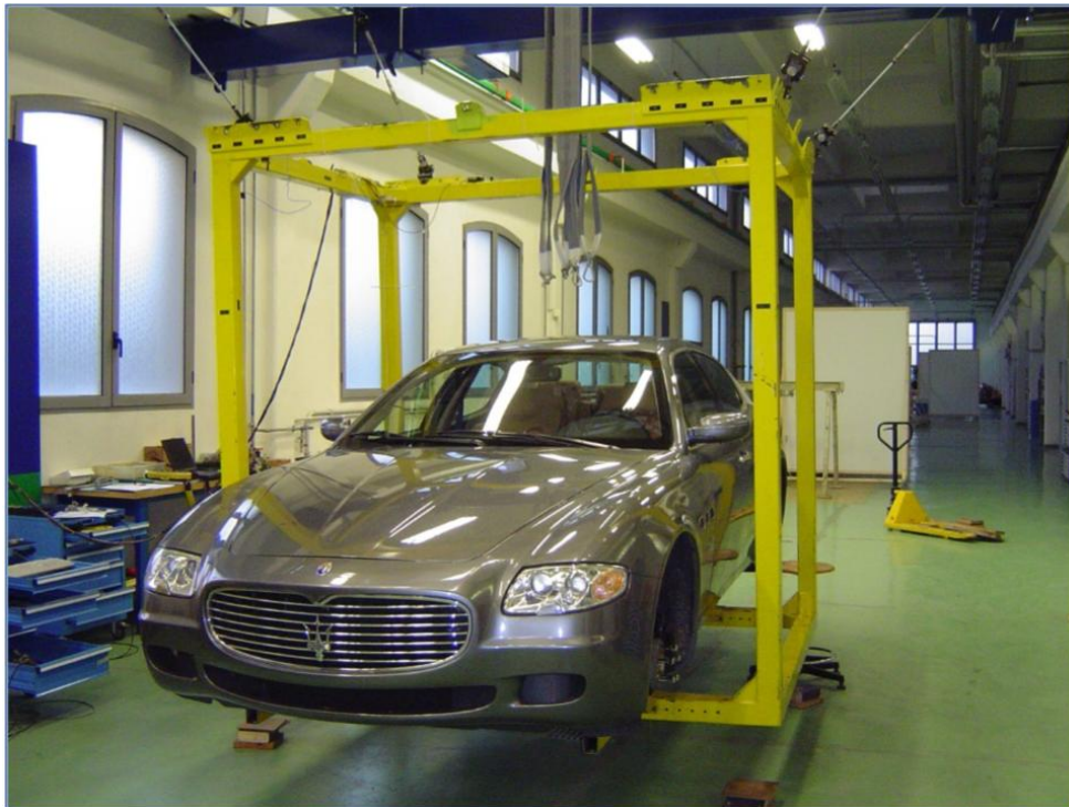
Slika 34. Mjerenje momenta tromosti - InTenso
