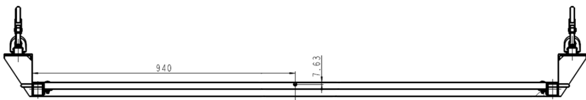
Slika 59. Položaj težišta platforme
