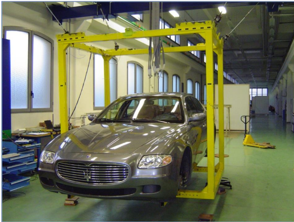
Slika 34. Mjerenje momenta tromosti - InTenso
