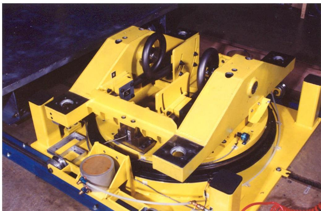
**Slika 36. Sklop za mjerjenje momenta tromosti oko osi X i Z**
