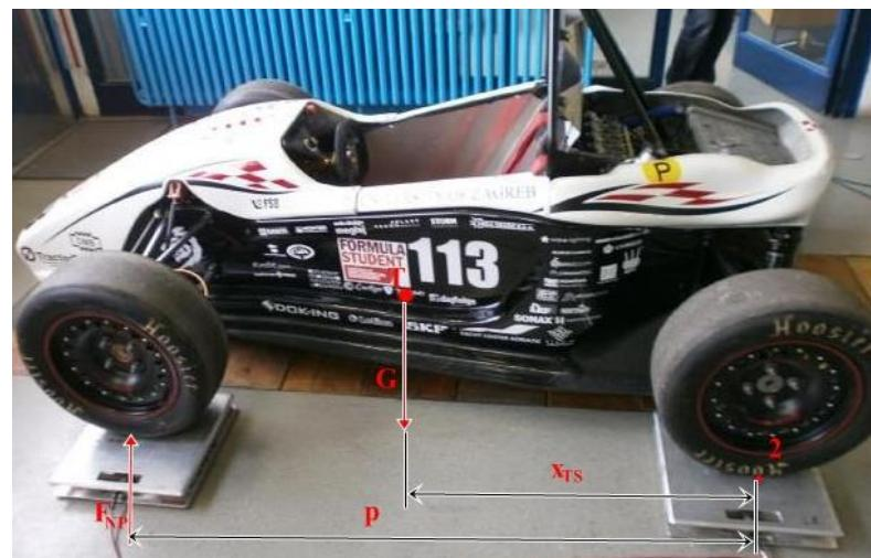
Slika 41. Položaj težišta trkaćeg automobila u smjeru osi X
