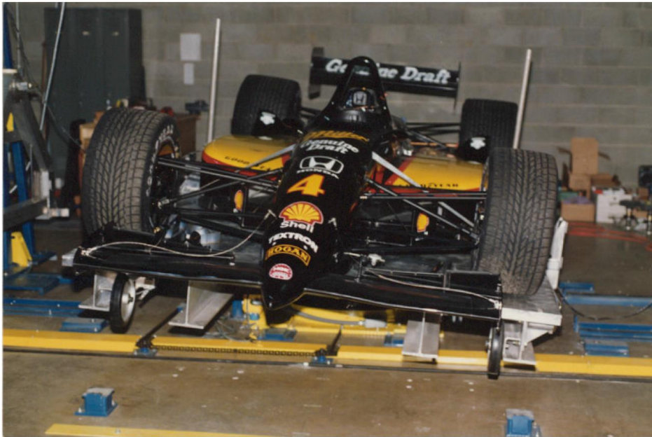
Slika 37. Mjerenje momenta tromosti oko osi X - VIMF
