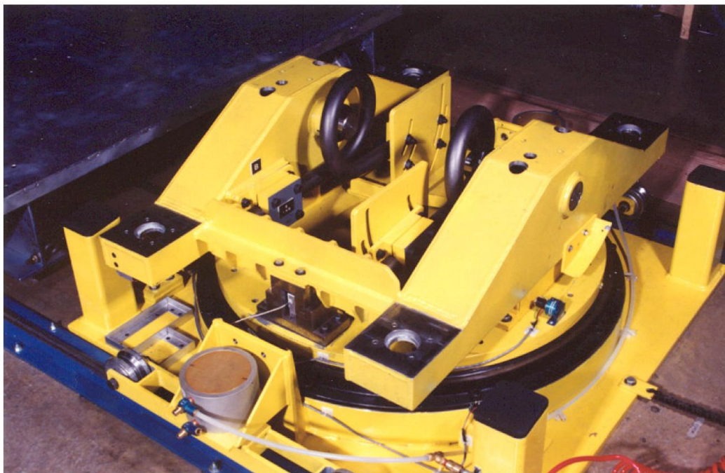
Slika 36. Sklop za mjerenje momenta tromosti oko osi X i Z
