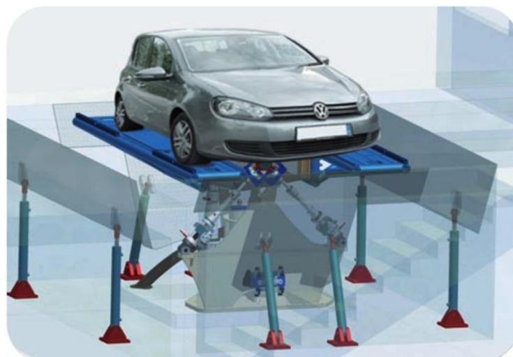
Slika 32. Mjerenje momenta tromosti - VIMM
