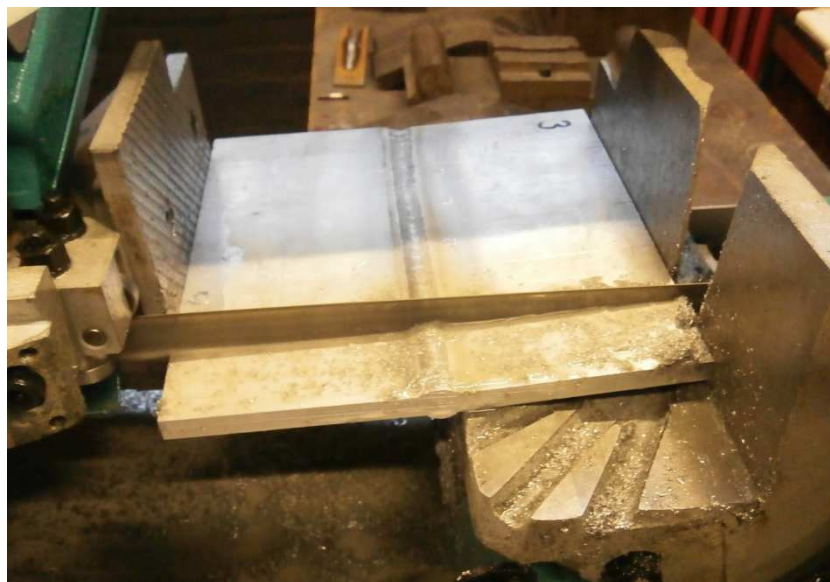
Slika 36. Rezanje uzoraka na tračnoj pili
