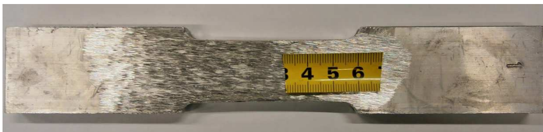
Slika 52. Epruveta za statički vlačni pokus
