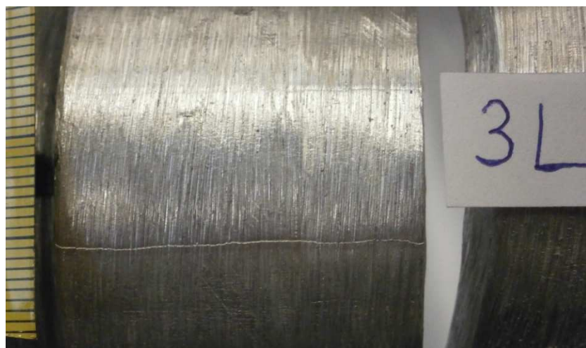
Slika 42. Uzorak 3 – lice zavara opterećeno na vlak
