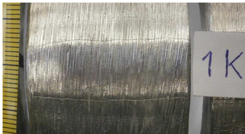
Slika 39. Uzorak 1 – korijen zavora opterećen na vlak
