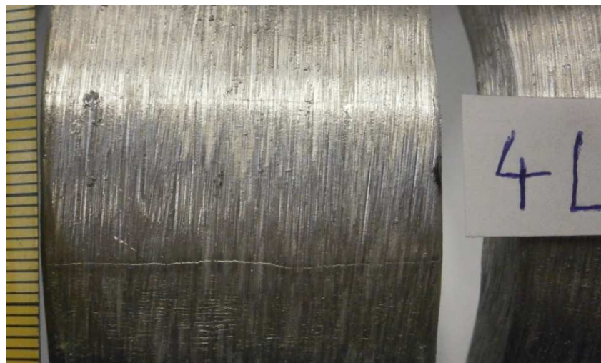
Slika 44. Uzorak 4 – lice zavara opterećeno na vlak
