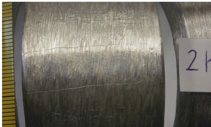
Slika 41. Uzorak 2 – korijen zavara opterećen na vlak
