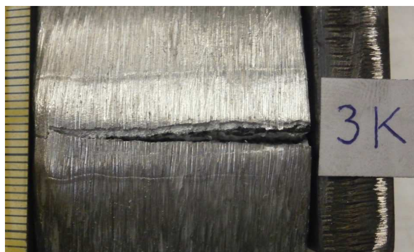
Slika 43. Uzorak 3 – korijen zavara opterećen na vlak
