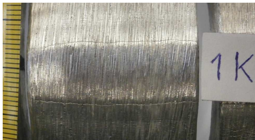
Slika 39. Uzorak 1 – korijen zavora opterećen na vlak
