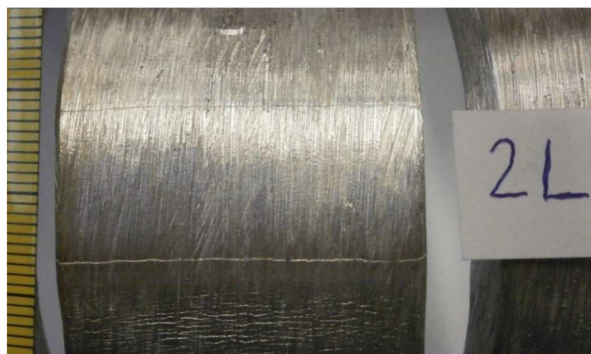
Slika 40. Uzorak 2 – lice zavora opterećeno na vlak
