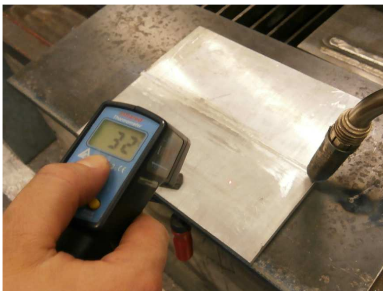
Slika 30. Mjerenje temperature između prolaza
