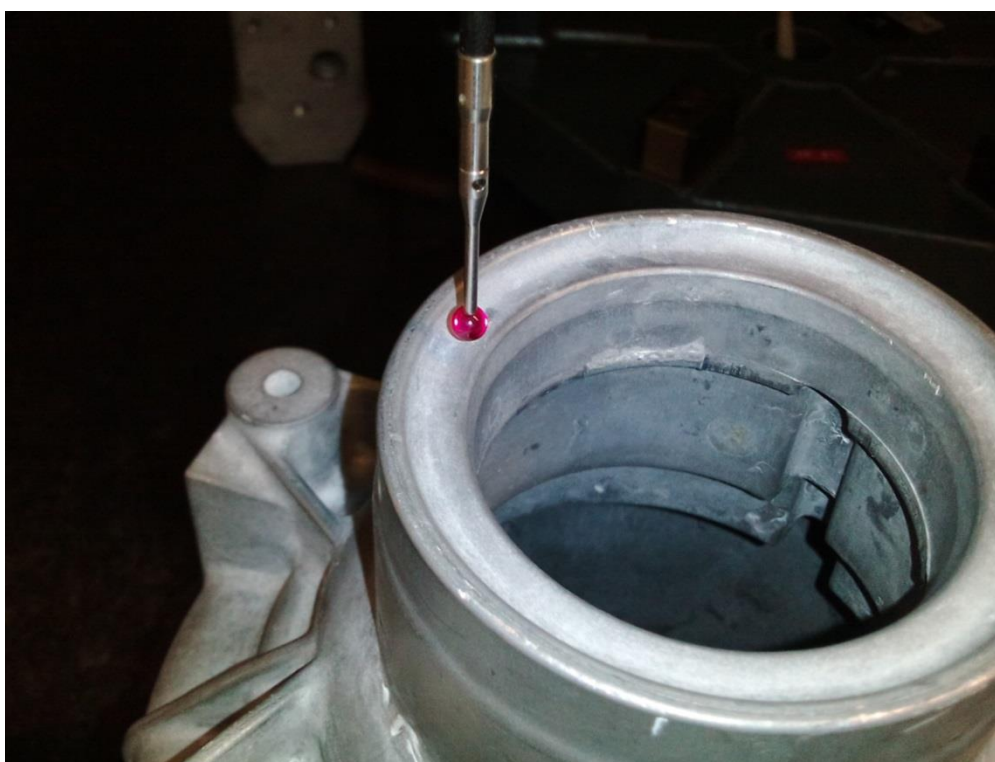
Slika 32. Postupak uzimanja mjerne točke na površini mjernog uzorka
