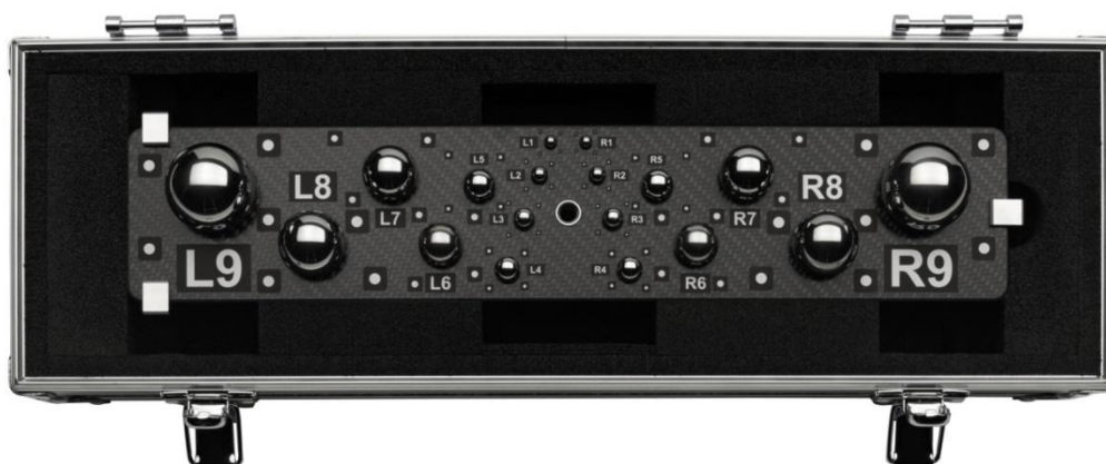
Slika 20. Propisani testni uzorci za određivanje odstupanja u mjerenju duljina prema VDI/VDA propisu 2634 dio 3 – kontrola kružnosti, udaljenosti i ravnosti
