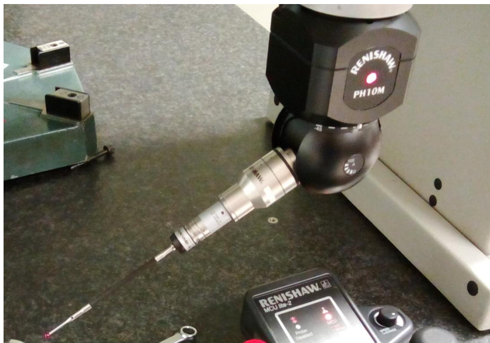
Slika 11. Mjerna glava Renishaw PH10M sa sustavom ticala TP20
