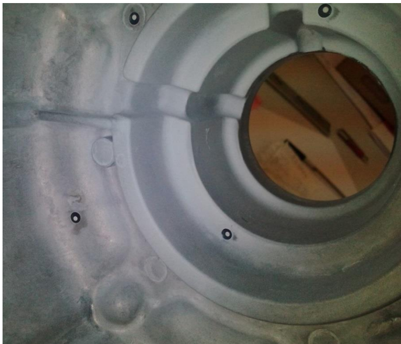
Slika 26. Detalj matiranog uskog utora u unutrašnjosti mjernog uzorka
