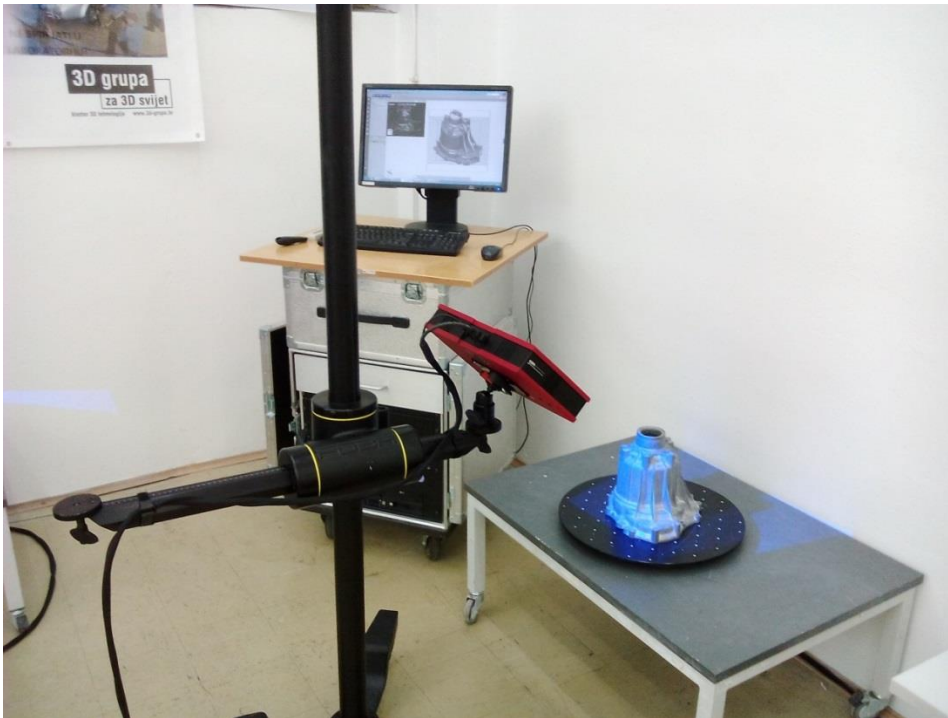
Slika 44. Postavljanje objekta mjerenja u mjerni volumen 3D skenera
