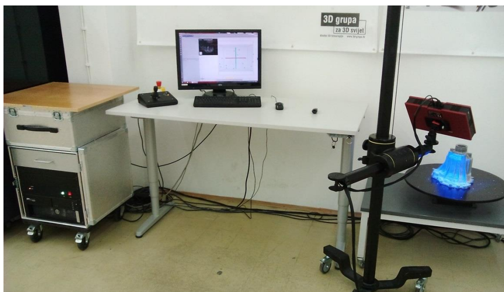
Slika 84. 3D skeniranje pomoću automatiziranog rotacijskog stola
