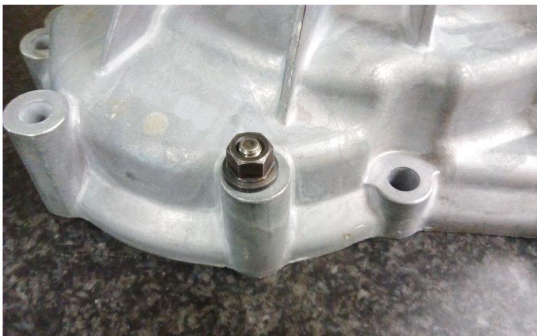
Slika 30. Učvršćenje mjernog uzorka za mjerni stol
