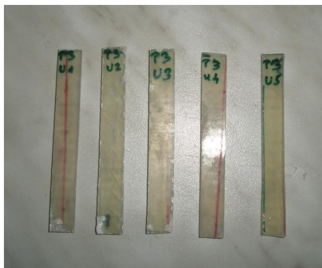
Slika 36. Epruvete za ispitivanje udarnog rada loma
