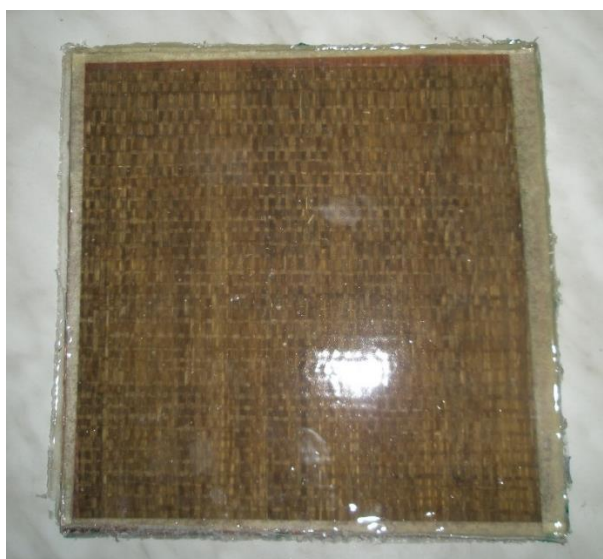
Slika 50. Kompozit ojačan s dva staklena i lanenom tkaninom
