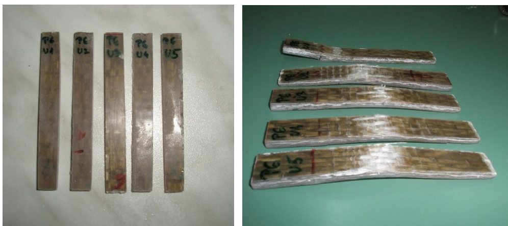
Slika 53. Epruvete prije i poslije ispitivanja savojne čvrstoće uzorka 5
