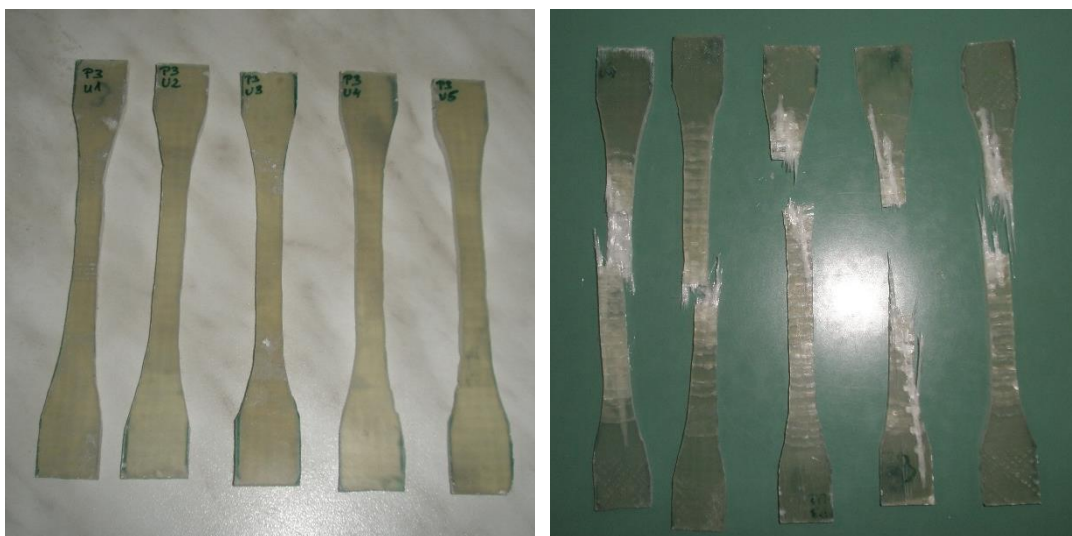
Slika 30. Epruvete prije i poslije rasteznog ispitivanja
