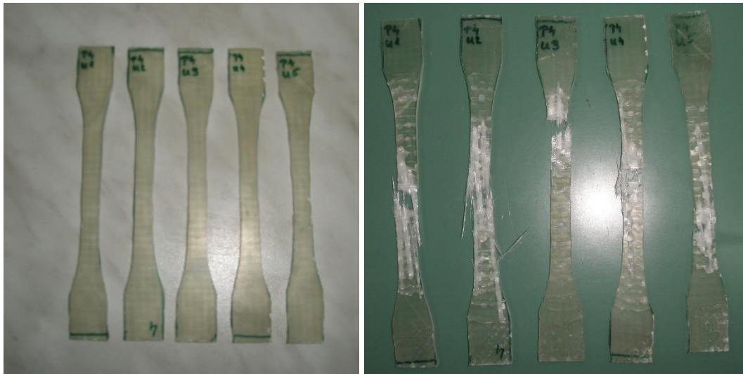
Slika 38. Epruvete prije i poslije ispitivanja rastezne čvrstoće
