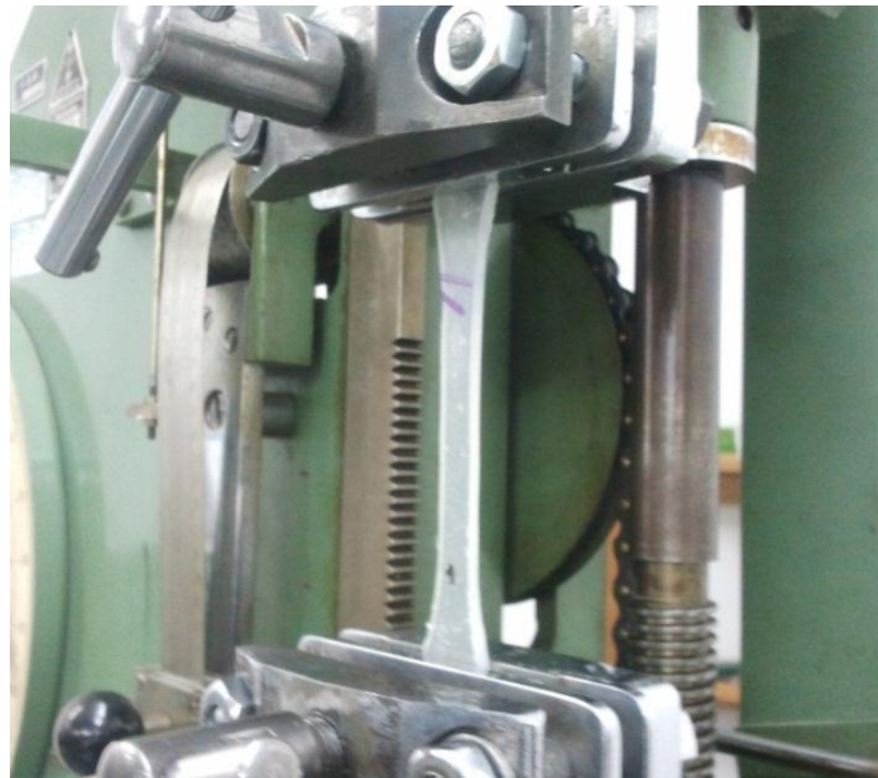
Slika 39. Kidanje epruvete prilikom statičkog rasteznog pokusa
