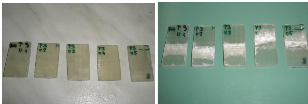
Slika 34. Epruvete prije i poslije ispitivanja međuslojne čvrstoće
