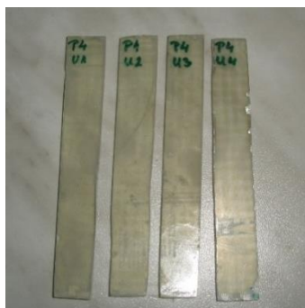
Slika 41. Epruvete za ispitivanje savojne čvrstoće
