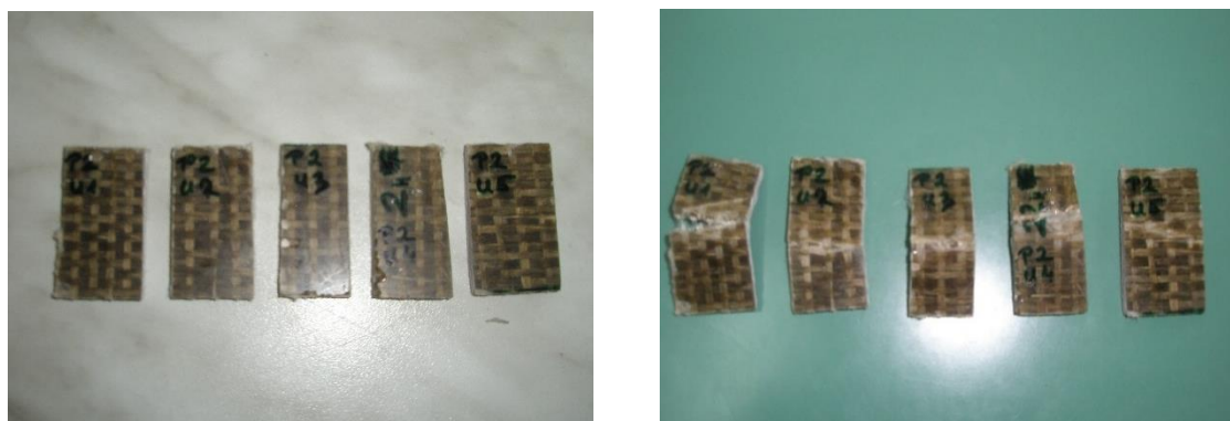
Slika 26. Epruvete prije i poslije ispitivanja međuslojne čvrstoće
