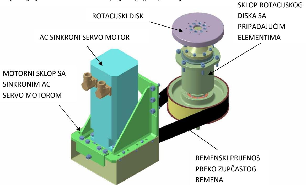
*Slika 3.2.1 Rotacijski modul tribometra i osnovni podmoduli*
