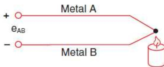
*Slika 5.3.1 Princip djelovanja termopara*
