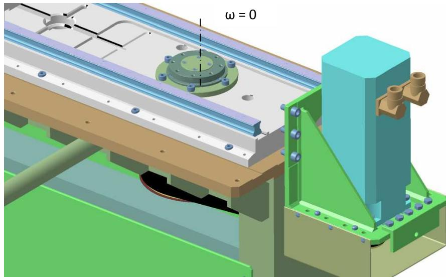
*Slika 3.6.4 Modul rotacijskog diska postavljen na postolje – pasivno stanje*
