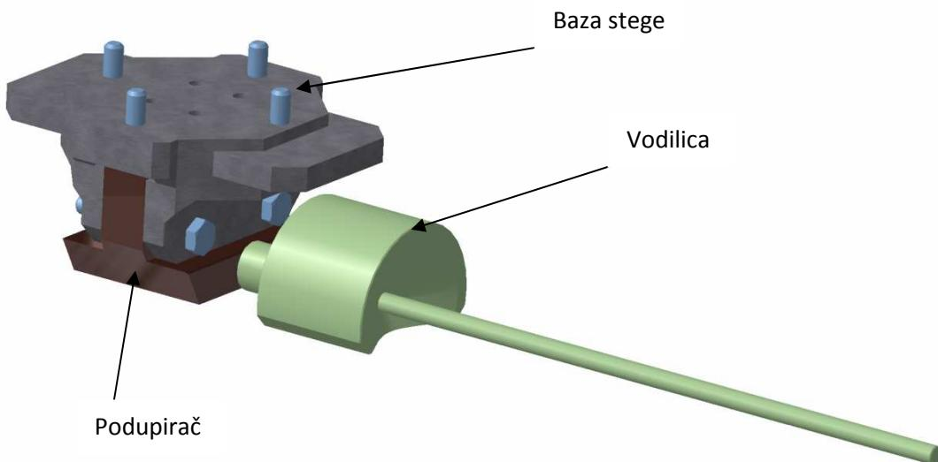
*Slika 7.2.1 Naprava za prihvatanje tlačnih opruga unutarnjih promjera 5 – 10 mm*
