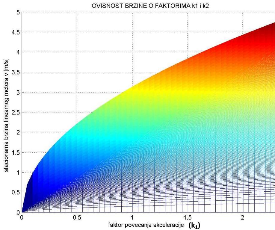
*Slika 6.1.12 Ovisnost stacionarne brzine linearног motora o faktoru povećanja akceleracije  $k_1$*
