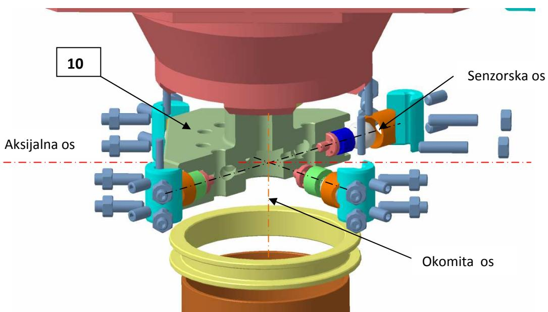
*Slika 3.3.11 Presjek plovka senzorske glave sa senzorskim podsklopovima*
