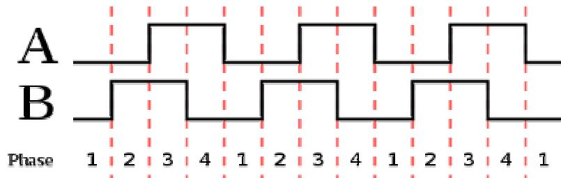
Slika 5.2.3 Izlazni signal inkrementalnog enkodera
