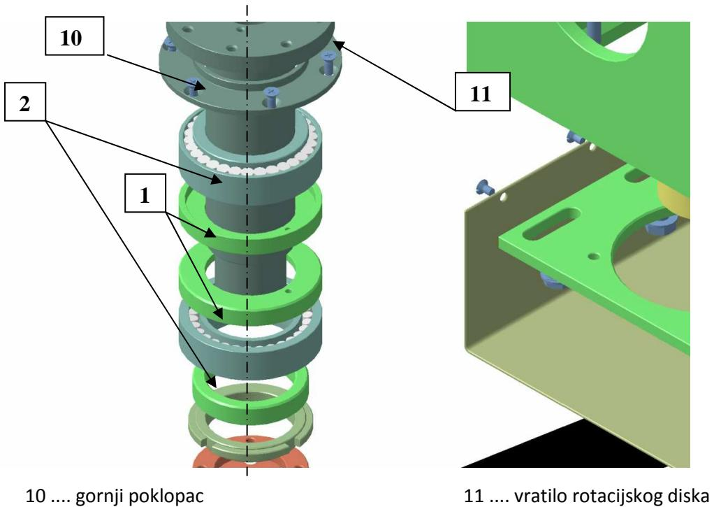
*Slika 3.2.4 Prikaz sklapanja srednjeg dijela sklopa rotacijskog diska*
