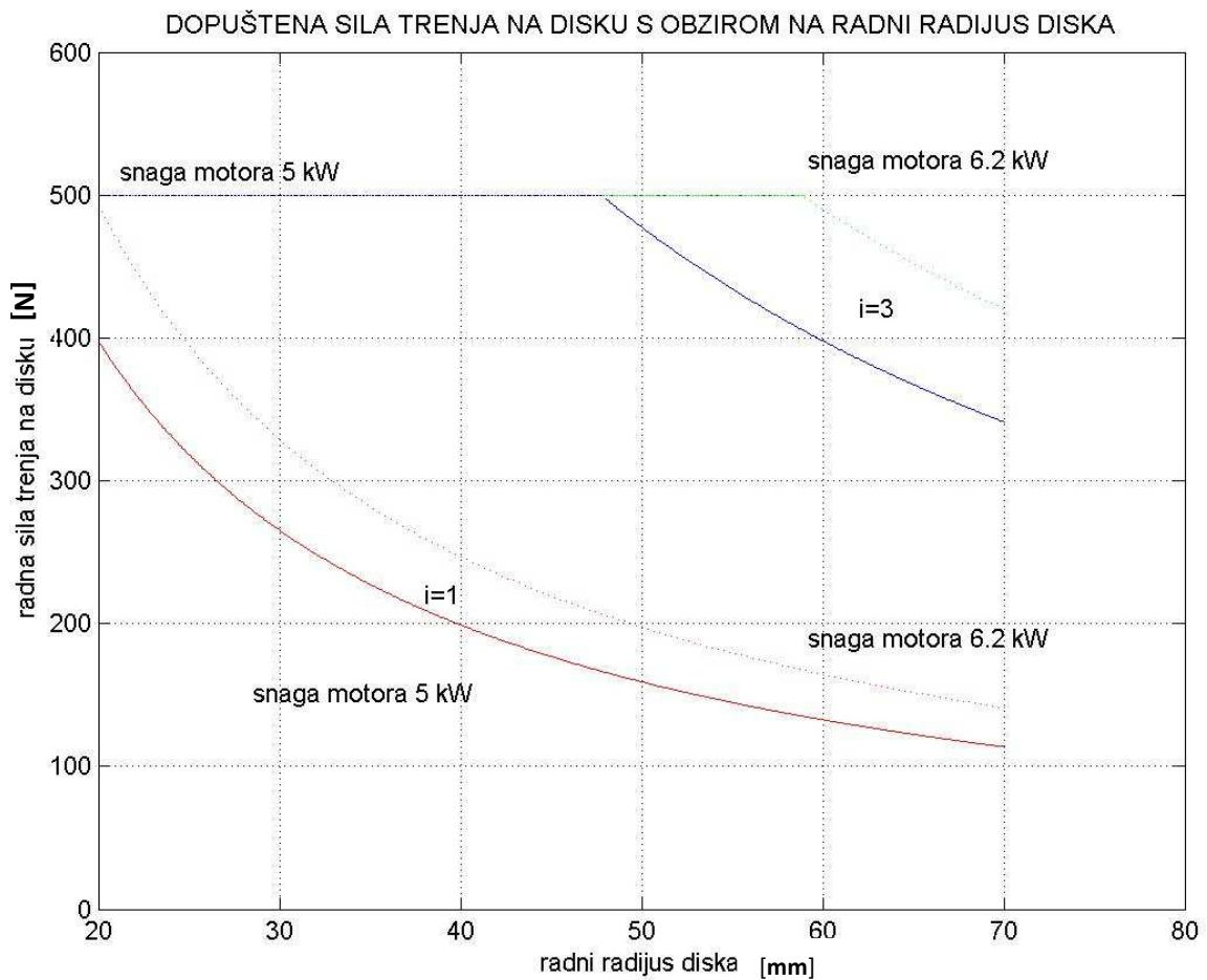
**Slika 4.2.2** Dijagramska prikaz ovisnosti maksimalne sile trenja na disku o radnom radijusu za oba prijenosna omjera
