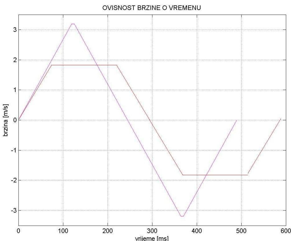
*Slika 6.1.7 Ovisnost brzine linearнog motora o vremenu – maksimalna brzina*
