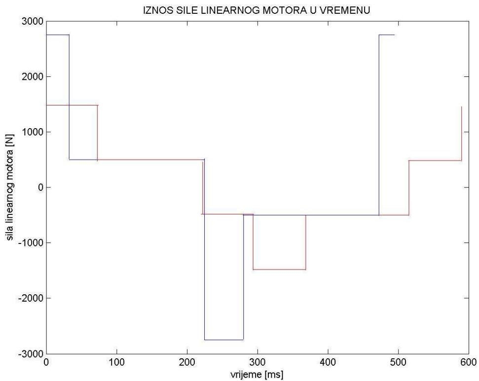
*Slika 6.1.1 Ovisnost sile linearnog motora o vremenu*
