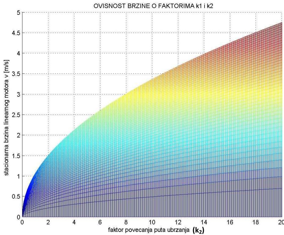
*Slika 6.1.11 Ovisnost stacionarne brzine linearног motora o faktoru puta ubrzanja  $k_2$*
