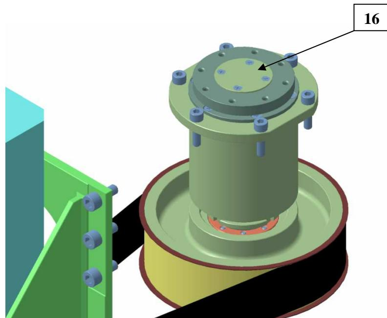
*Slika 3.2.7 Prikaz pasivnog sklopa modula rotacijskog diska*
