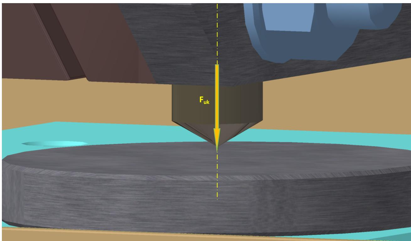
*Slika 7.4.2 Uzorak opterećen silom utiskivača*
