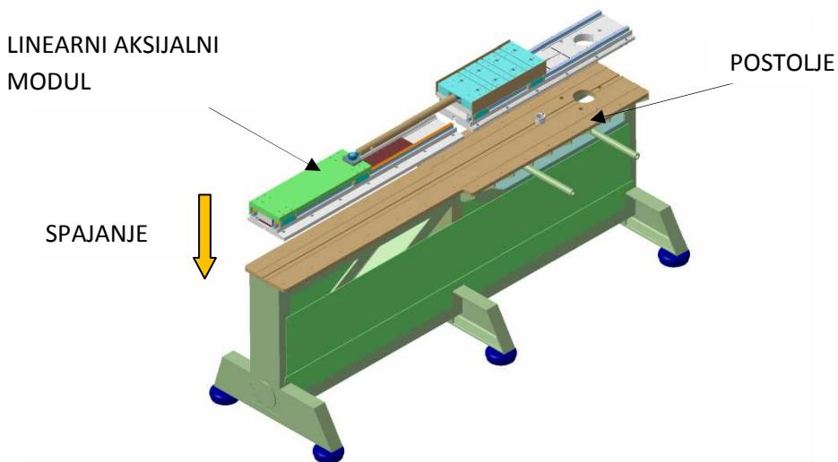
*Slika 3.6.1 Postavljanje linearnog aksijalnog modula na postolje*
