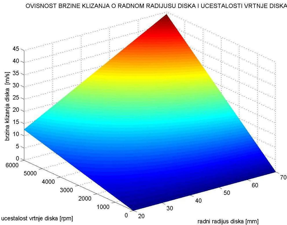
**Slika 6.1.17** Ovisnost brzine klizanja rotacijskog diska o radnom radijusu i ucestalosti vrtnje diska
