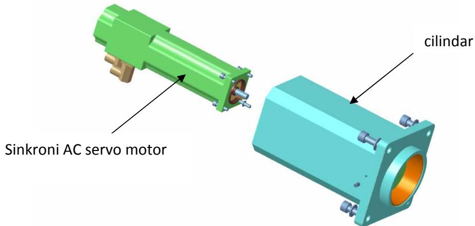
*Slika 3.3.2 Cilindar sa sinkronim AC servo motorom*
