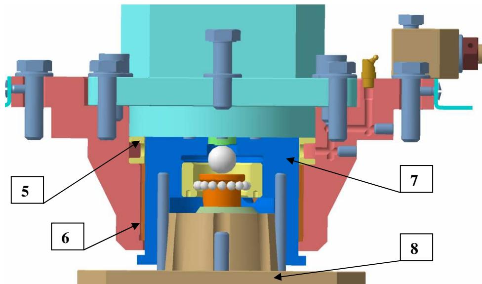
*Slika 3.3.9 Pogled kroz presjek na senzor vertikalne sile*
