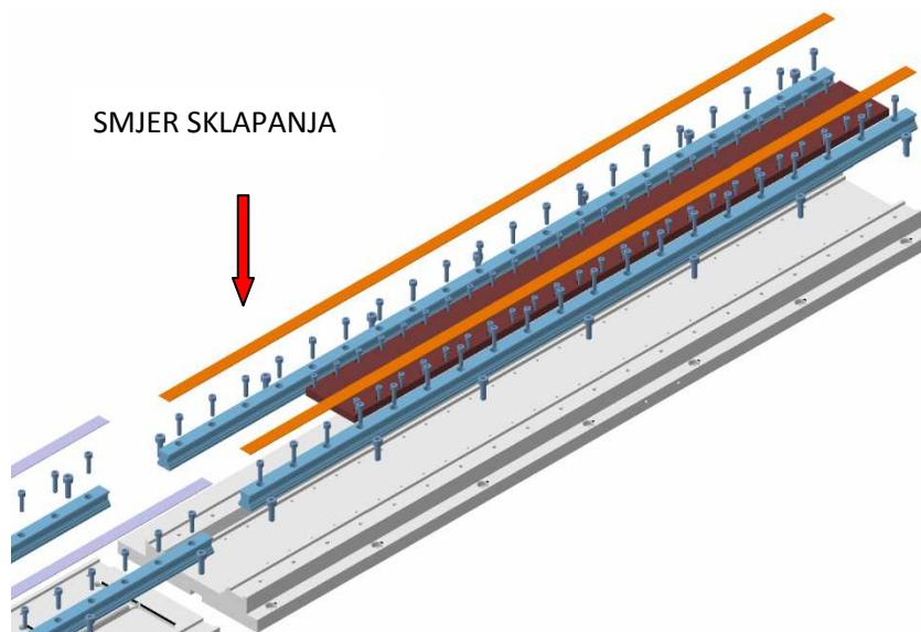
*Slika 3.1.4 Postavljanje vodilica i sekunadara na monoblok linearog motora*
