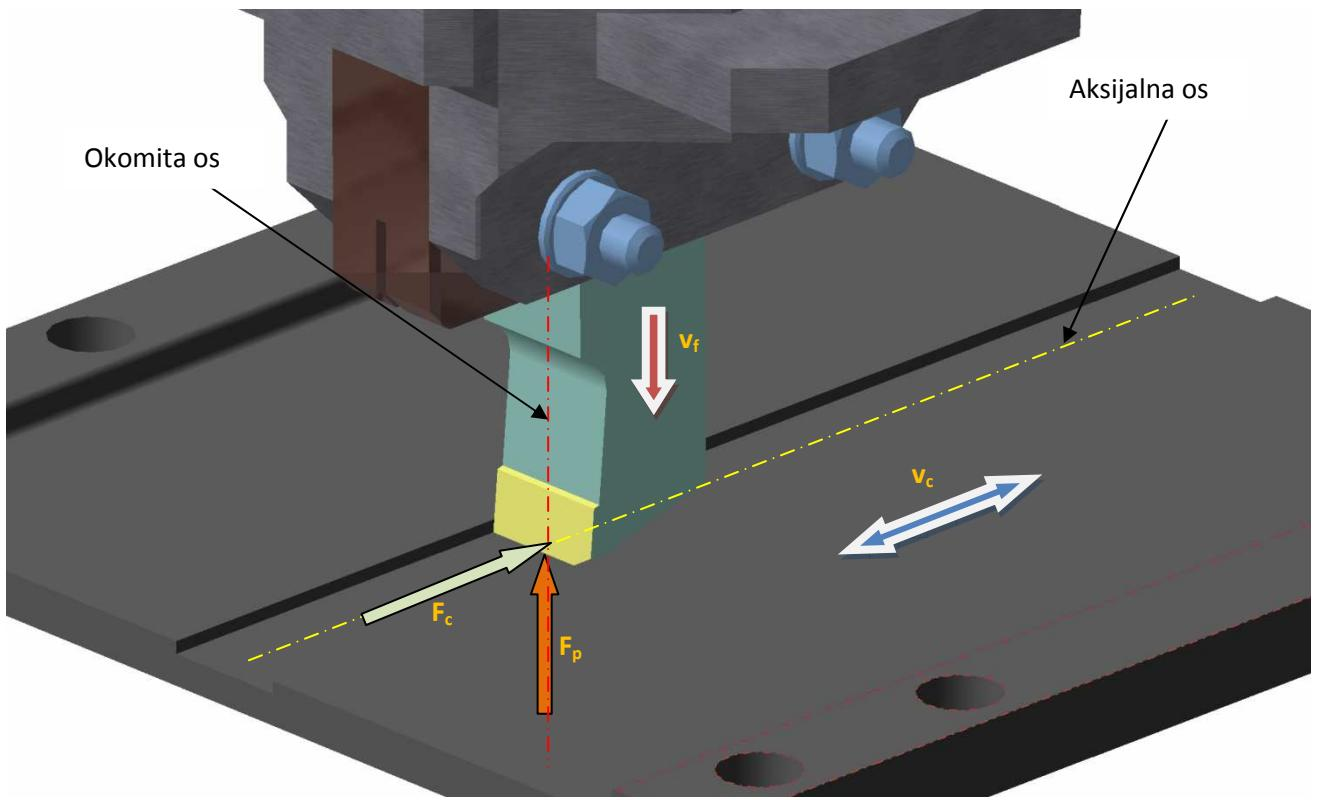
*Slika 7.3.2 Proces ispitivanja sile rezanja na obratku*
