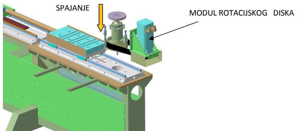
*Slika 3.6.2 Postavljanje modula rotacijskog diska na postolje*
