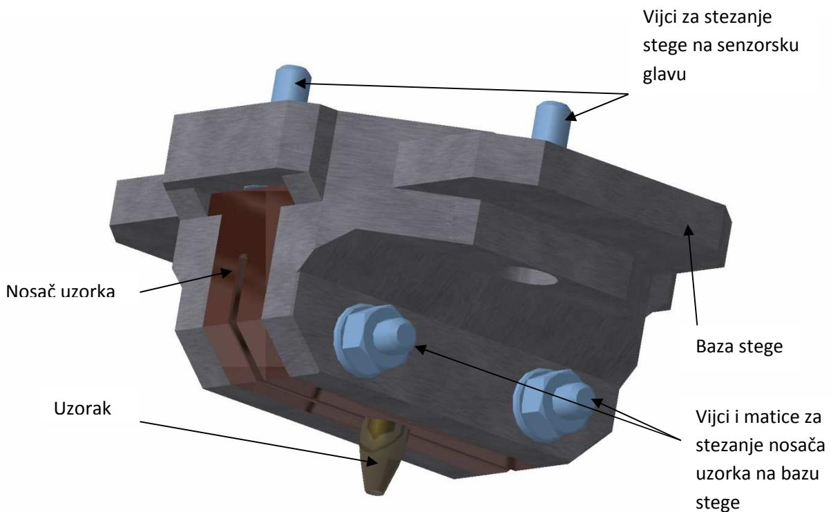
*Slika 7.1.2 Prikaz mehaničke stegе sa nosačem i uzorkom u obliku kline*
