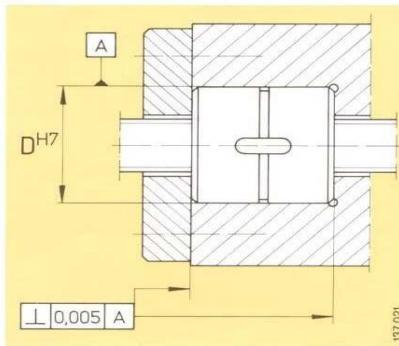
Bild 3 Einbautoleranzen
