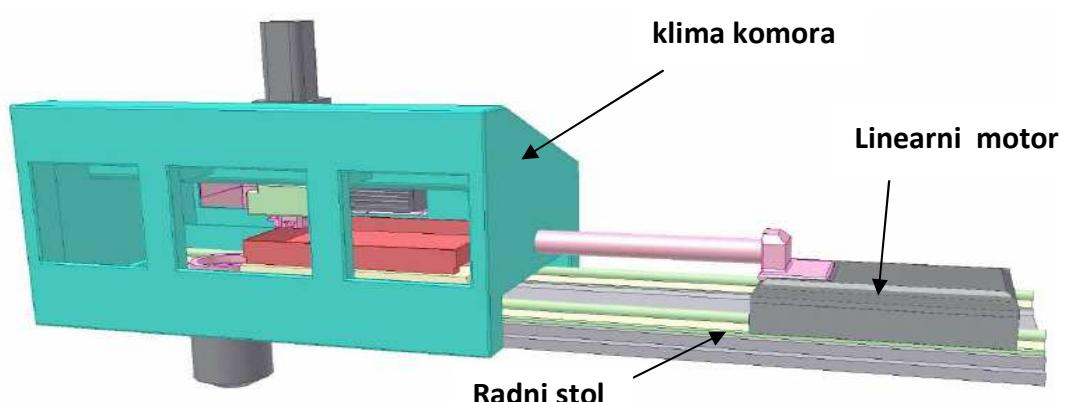
*Slika 2.1.3 Model tribometra – linearni motor i zatvorena klima komora*
