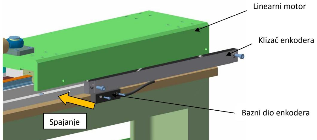
*Slika 5.2.4 Montiranje linearног apsolutnog enkodera na linearni modul*
