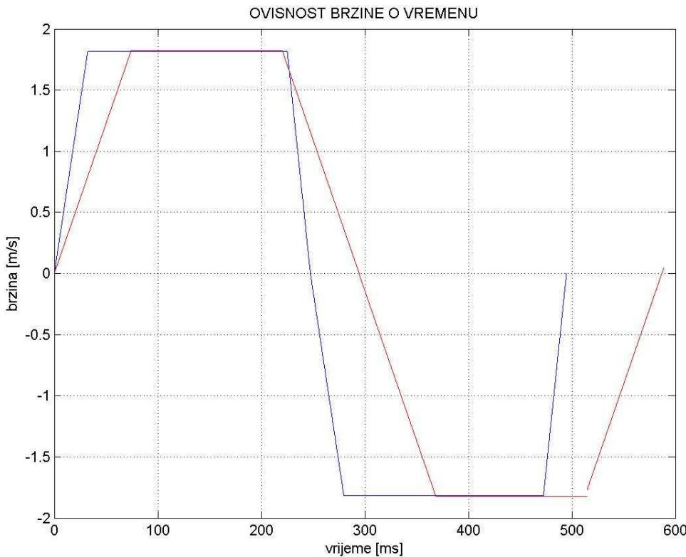
*Slika 6.1.3 Ovisnost brzine linearног motora o vremenu*
