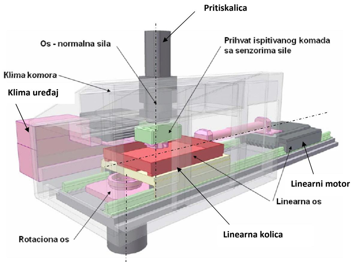
*Slika 2.1.2 Model tribometra sa osnovnim dijelovima*
