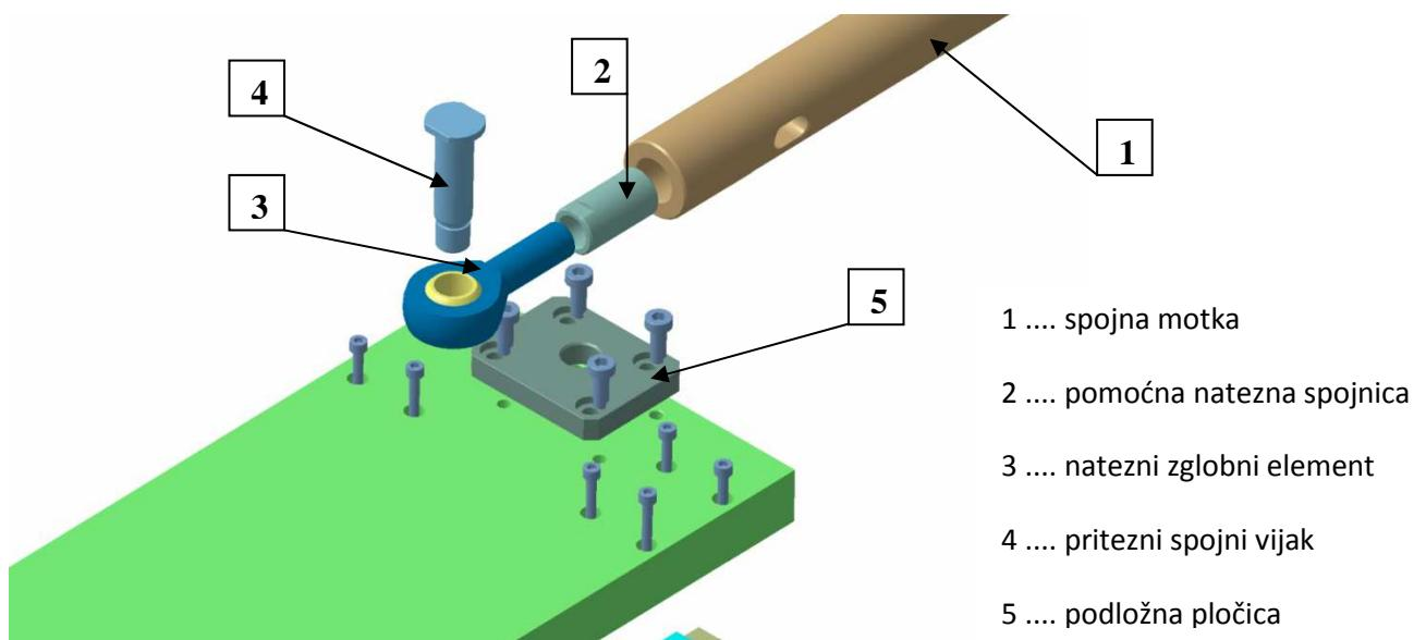
*Slika 3.1.6 Prikaz spajanja spojne motke na nosač linearног motora*
