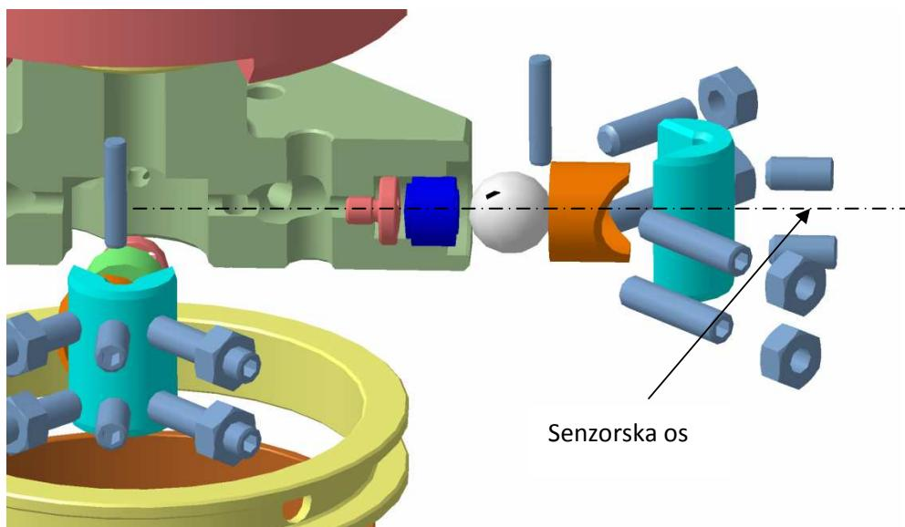
*Slika 3.3.12 Prikaz slaganja senzorskih elemenata u sklop*
