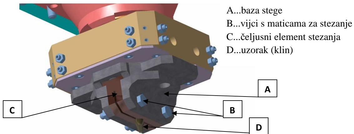
*Slika 3.3.14 Prikaz mehaničke stege sa uzorkom (klin)*
