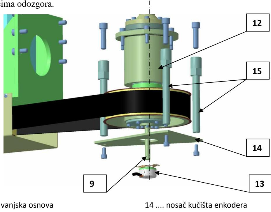
*Slika 3.2.5 Prikaz postavljanja enkodera na vratilo i nosač enkodera*
