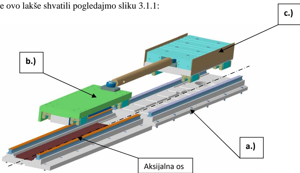
*Slika 3.1.1 Prikaz modula za ostvarivanje horizontalnog pravocrtnog gibanja*
