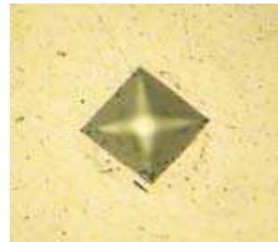
*Slika 7.4.3 Otisak na površini materijala nakon ispitivanja tvrdoće*
