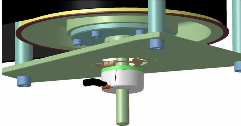
*Slika 3.2.6 Rotacijski enkoder postavljen na nosaču*
