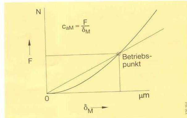
Bild 9 Federkennlinie der Gewindemutter
