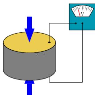
*Slika 5.1.1 Shema rada tenzometarskog senzora*
