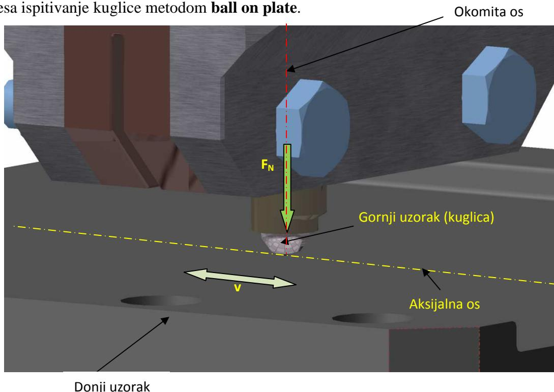
*Slika 7.1.8 Prikaz rada metode kuglica na ploči*
