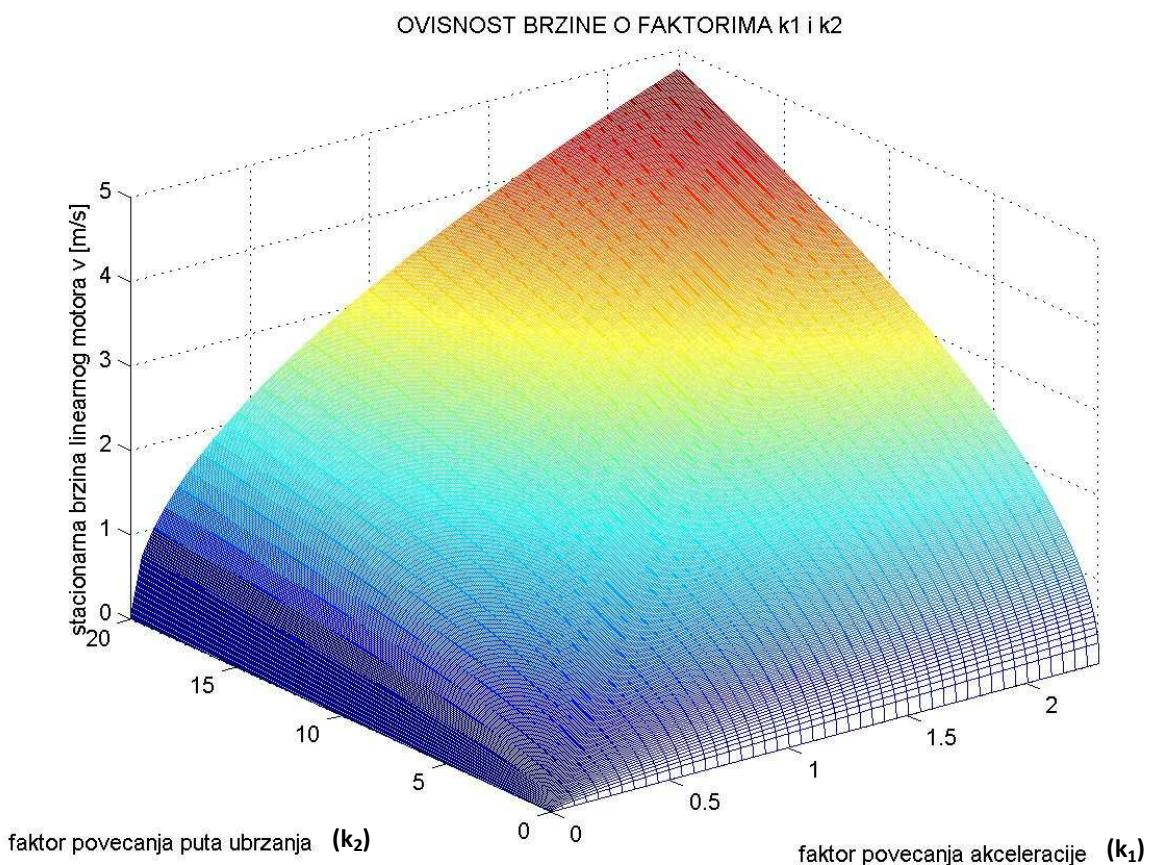
**Slika 6.1.10** Ovisnost stacionarne brzine linearnega motora o faktorima  $k_1$  i  $k_2$
