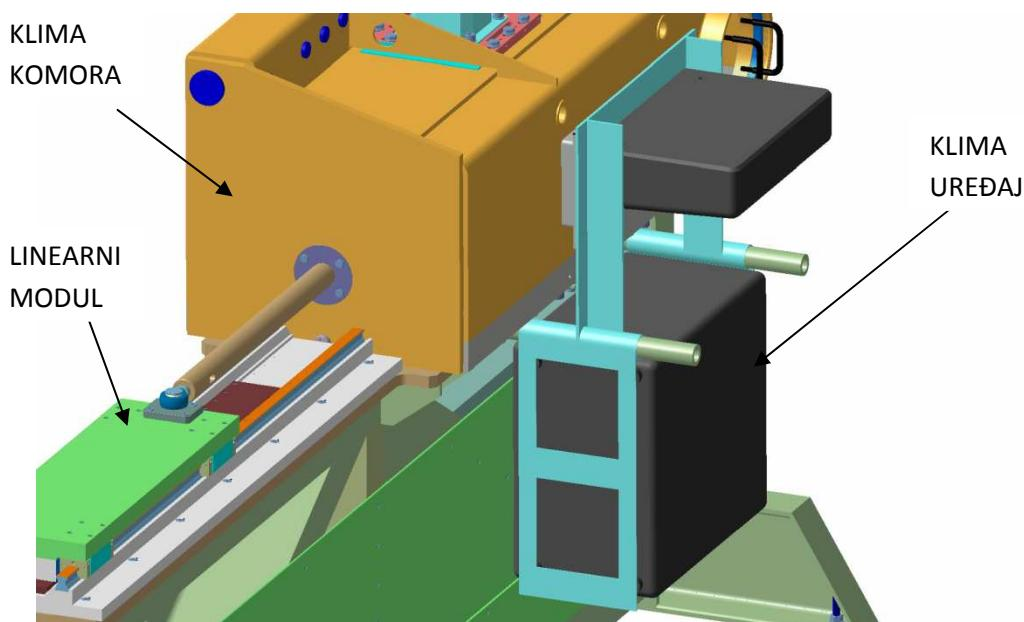
*Slika 3.4.6 Klima komora i klima uređaj smještene na tribometru*
