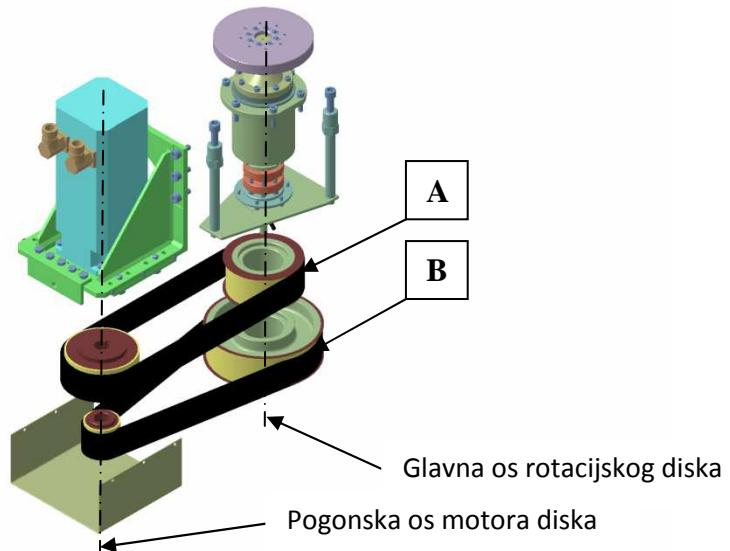
*Slika 3.2.9 Prikaz modula rotacijskog diska sa oba diobena para remenica*
