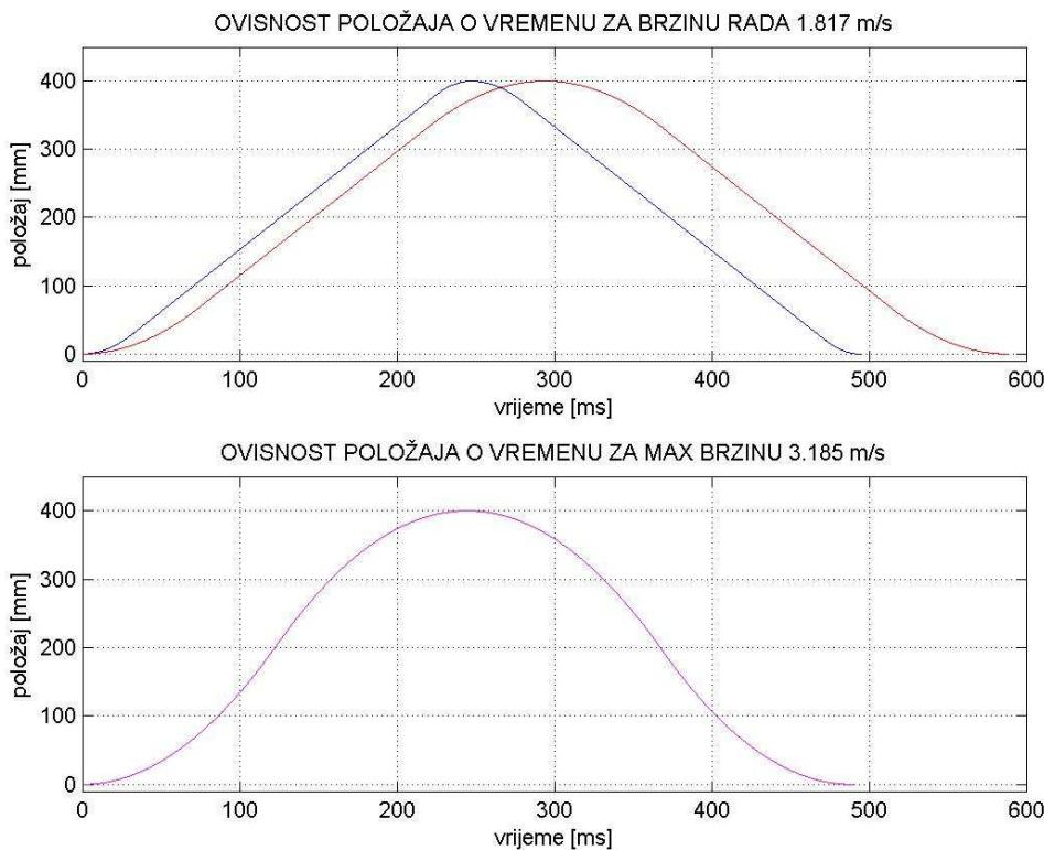
*Slika 6.1.8 Ovisnost položaja linearног motora o vremenu – maksimalna brzina i brzina kod maksimalne sile*
