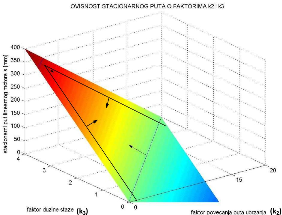
**Slika 6.1.13** Ovisnost stacionarne brzine linearog motora o faktorima  $k_2$  i  $k_3$
