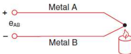
Slika 5.3.1 Princip djelovanja termopara
