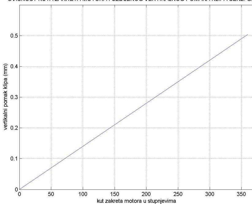
*Slika 4.3.2 Dijagramski prikaz ovisnosti zakreta motora i vertikalnog pomaka klipa*
