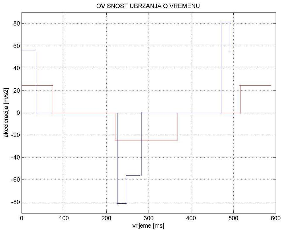
*Slika 6.1.2 Ovisnost ubrzanja linearnog motora o vremenu*
