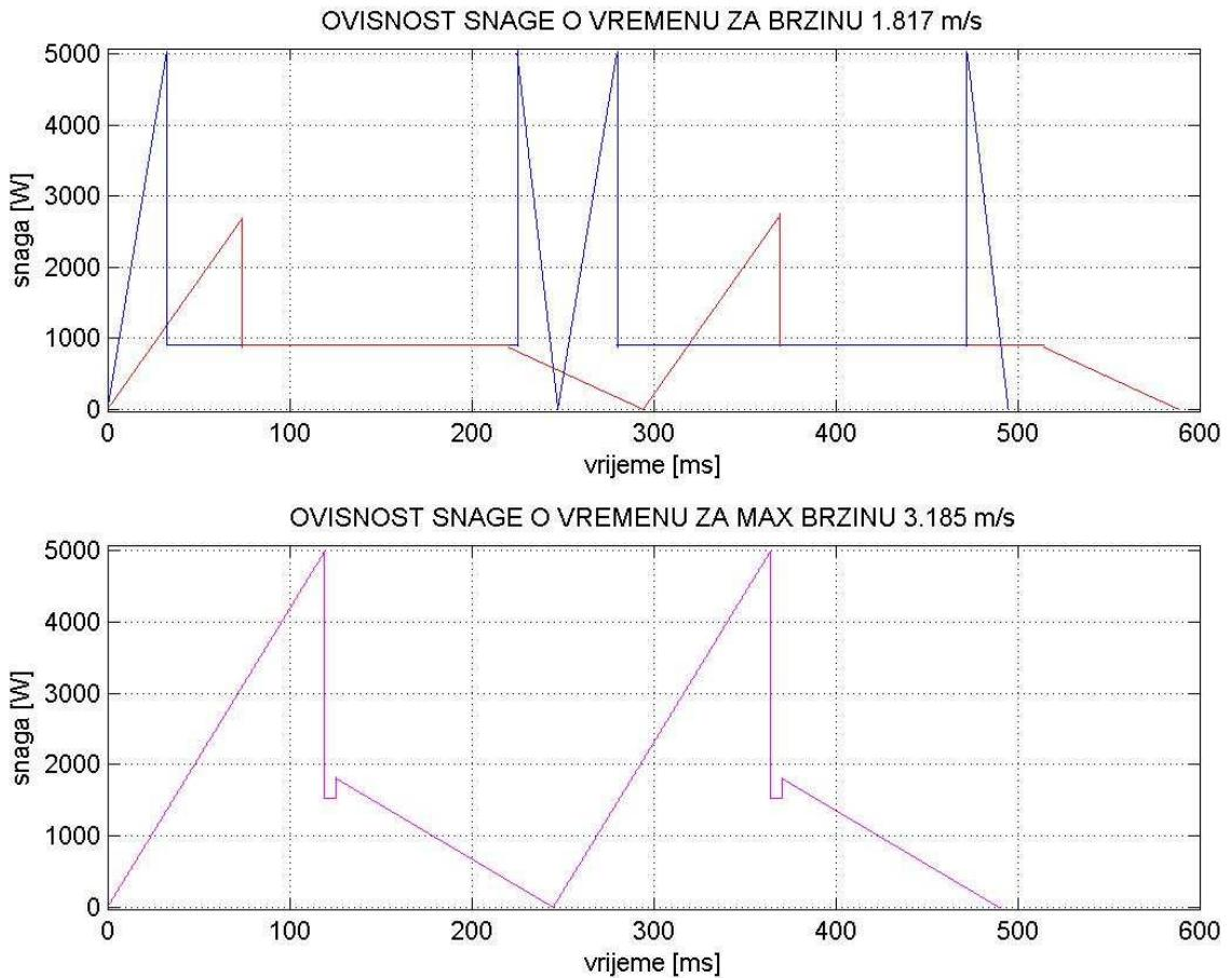
*Slika 6.1.9 Ovisnost snage linearног motora o vremenu*
