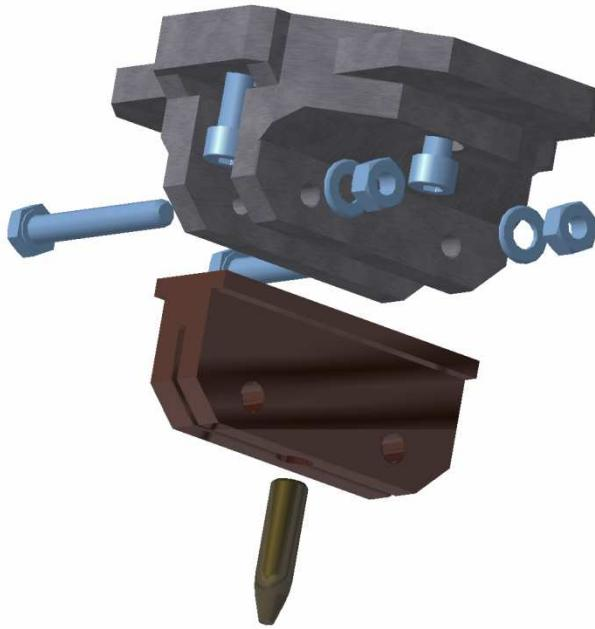
*Slika 7.1.3 Mehanička stega sa nosačem i uzorkom u obliku kline u rastavljenom stanju*
