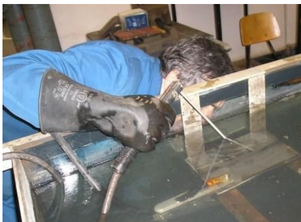
Slika 3.5.6 Pozicioniranje pištolja na početak ispitnog Y-spoja
