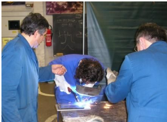
Slika 3.5.4 Zavarivanje pomoćnih zavora MAG postupkom
