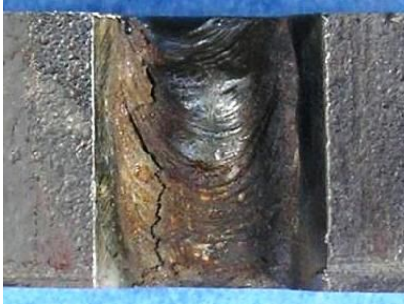
Slika 4.2.1 Lice zavara uzorka 11 sa unosom topline 12 kJ/cm
