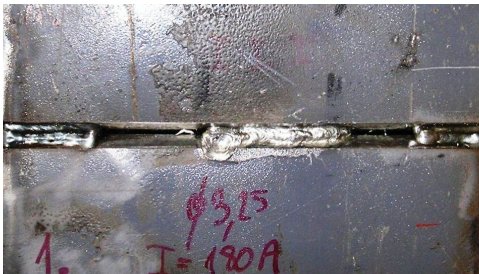
Slika 3.5.9 Izgled zavarenog uzorka 1 za Tekken-test s unosom topline 12 kJ/cm
