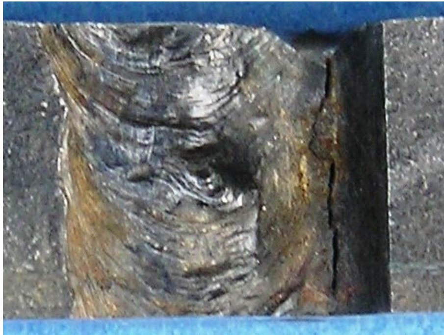
Slika 4.2.7 Lice zavara uzorka 22 sa unosom topline 15 kJ/cm
