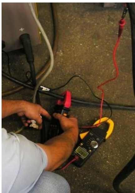
Slike 3.5.1 Mjerenje parametara zavarivanja
