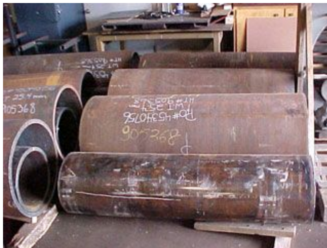
Slika 2.7.2 Cijevi raznih promjera i tipova (X70, X90, X100) [45]
