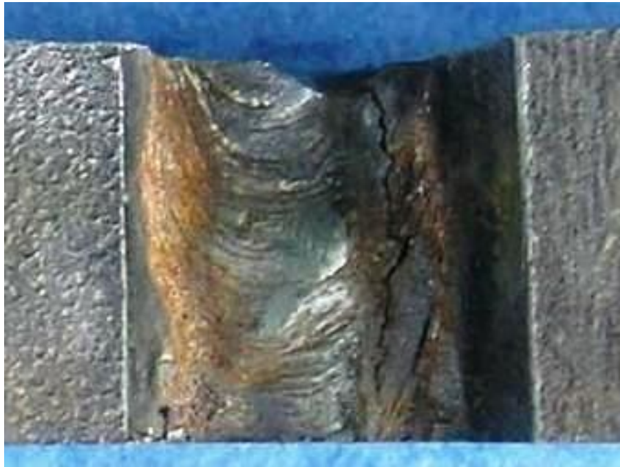
Slika 4.2.3 Lice zavara uzorka 12 sa unosom topline 12 kJ/cm
