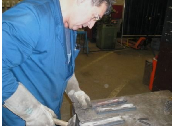
Slika 3.5.14 Numeriranje i zacrtavanje iglom
