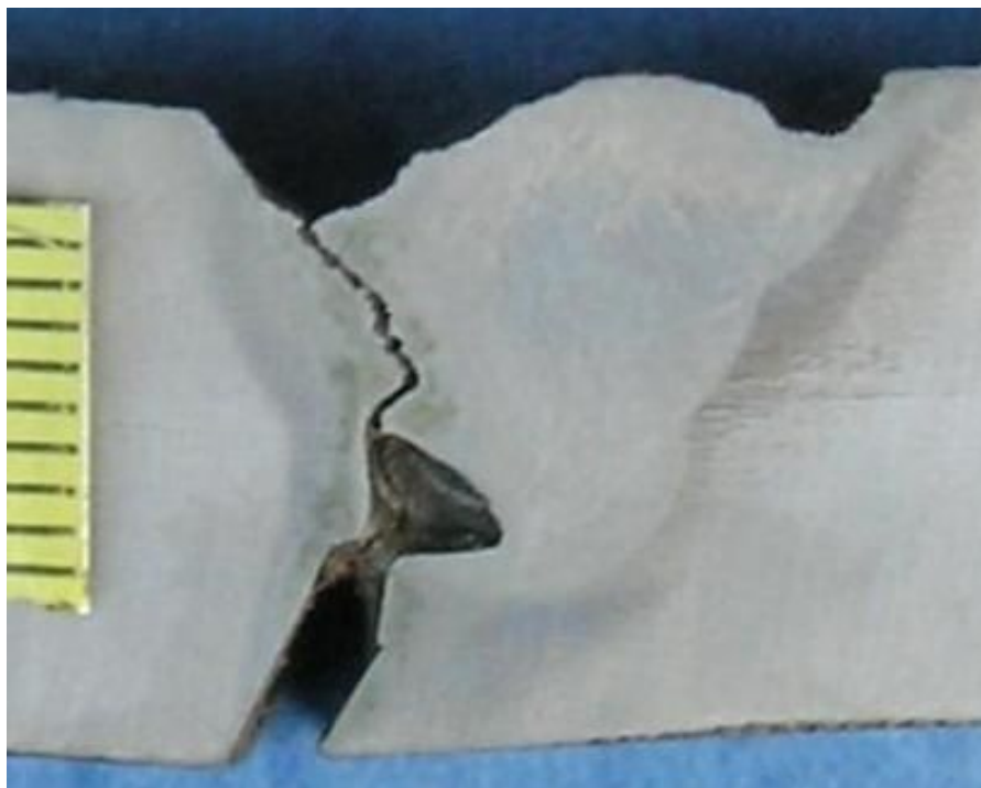
Slika 4.2.6 Makroizbrusak uzorka 21 sa unosom topline 15 kJ/cm
