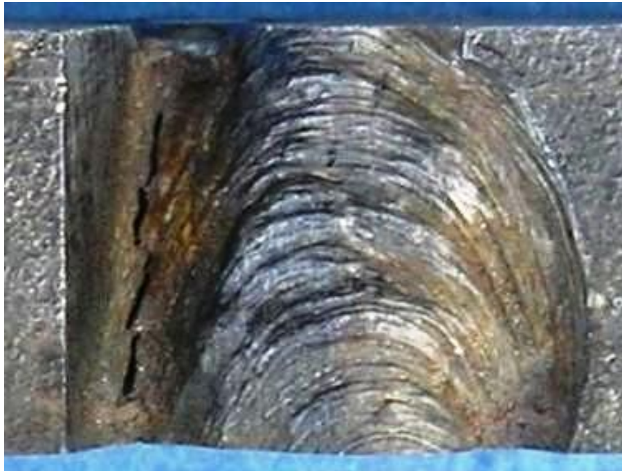
Slika 4.2.5 Lice zavara uzorka 21 sa unosom topline 15 kJ/cm
