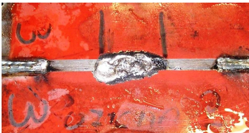
Slika 3.5.11 Izgled zavarenog uzorka 3 za Tekken-test s unosom topline 18 kJ/cm
