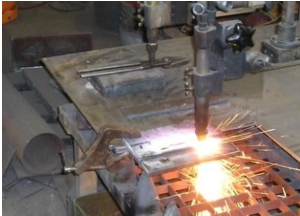
Slika 3.5.13 Plinsko rezanje na trake
