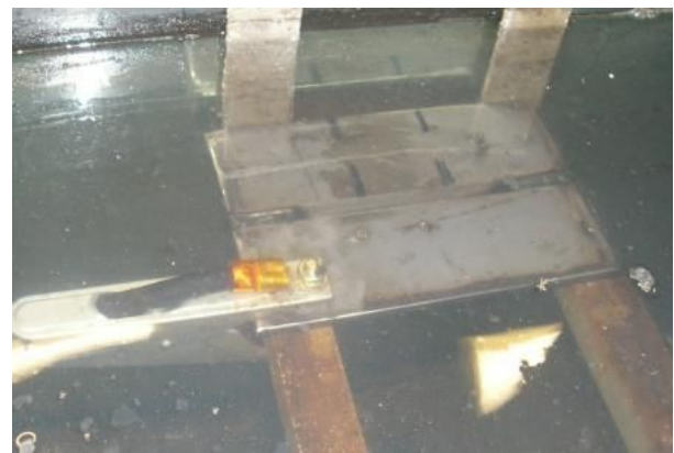
Slika 3.5.5 Uzorak pripremljen za zavarivanje ispitnog zavora
