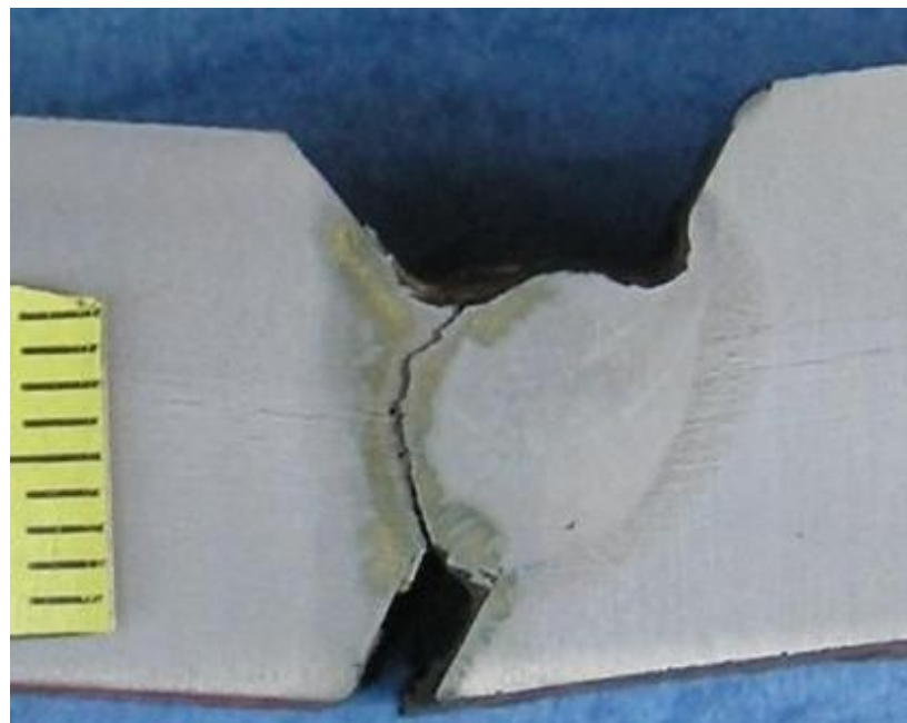
Slika 4.2.2 Makroizbrusak uzorka 11 sa unosom topline 12 kJ/cm
