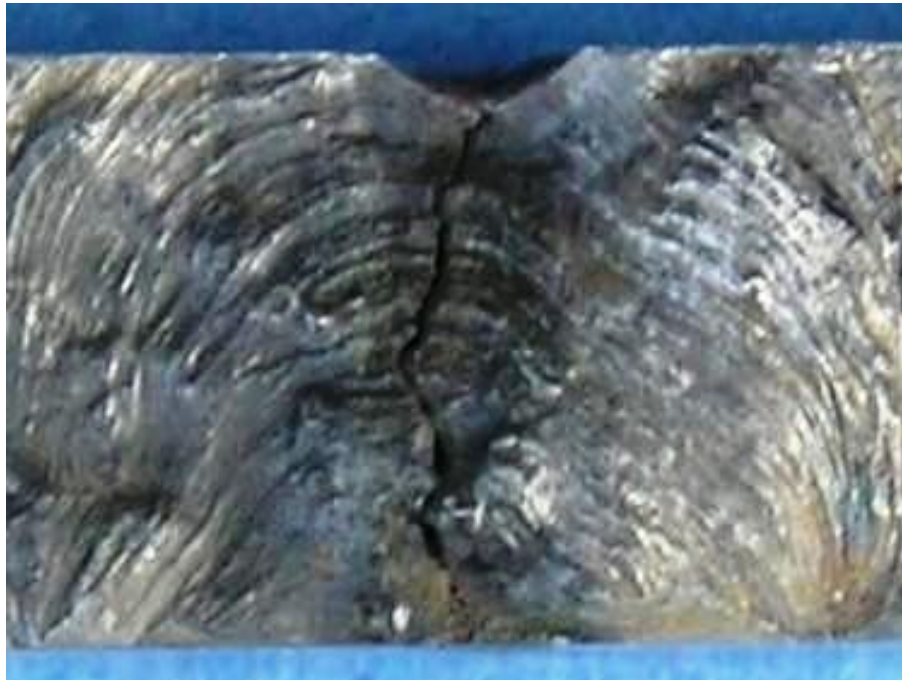
Slika 4.2.11 Lice zavara uzorka 33 sa unosom topline 18 kJ/cm
