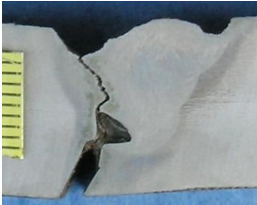
Slika 4.2.6 Makroizbrusak uzorka 21 sa unosom topline 15 kJ/cm
