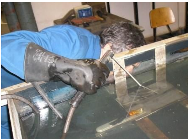
Slika 3.5.6 Pozicioniranje pištolja na početak ispitnog Y-spoja
