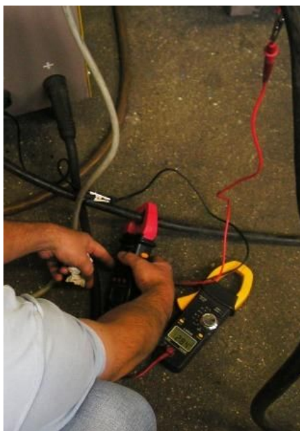
Slike 3.5.1 Mjerenje parametara zavarivanja
