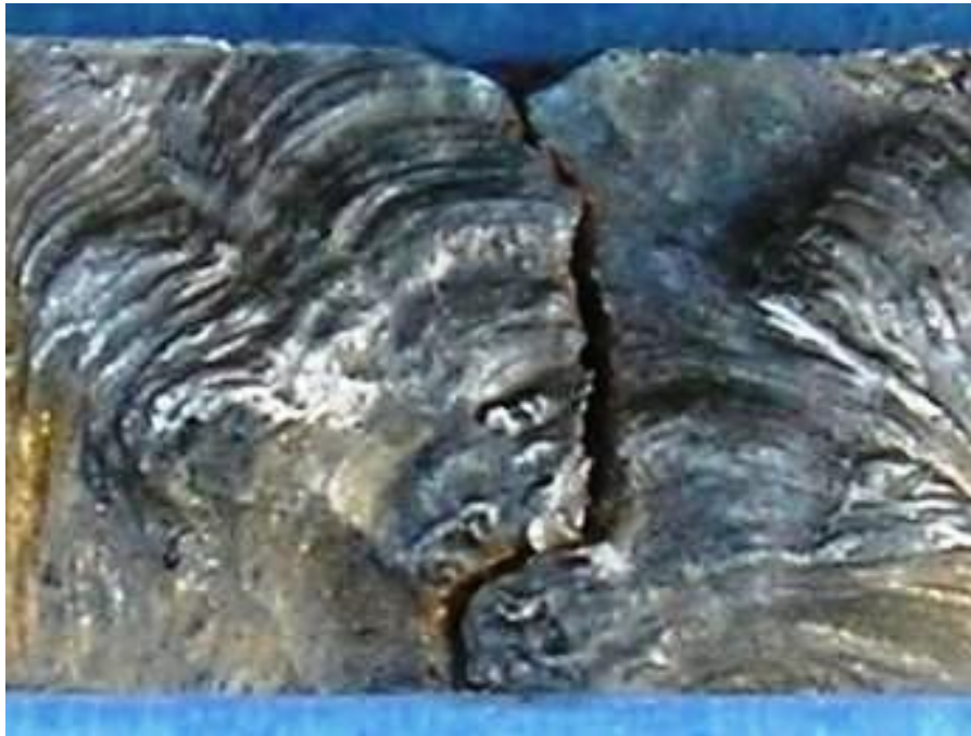
Slika 4.2.9 Lice zavara uzorka 32 sa unosom topline 18 kJ/cm
