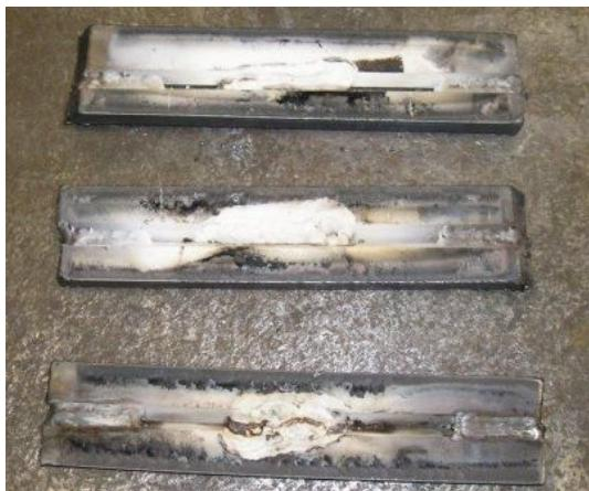
**Slike 3.5.15 Uzorci pripremljeni za hladno rezanje uz pomoć pile**
