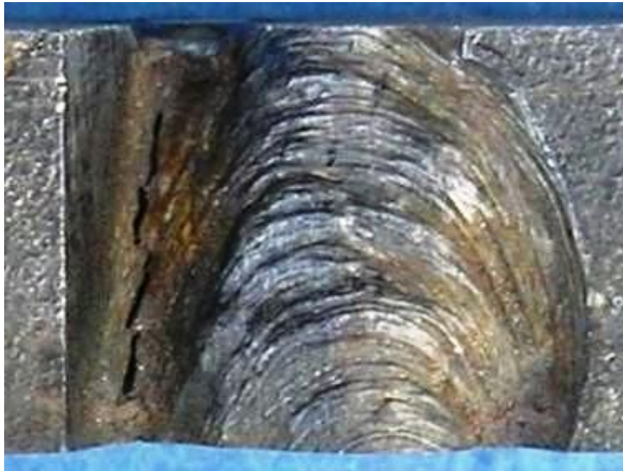
Slika 4.2.5 Lice zavara uzorka 21 sa unosom topline 15 kJ/cm
