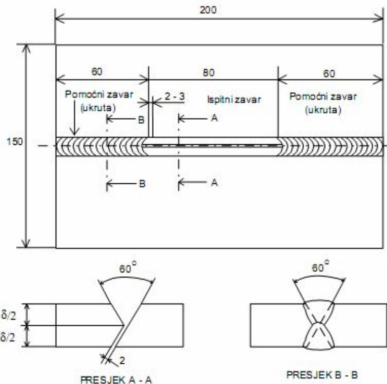
Slika 2.8.5 Priprema spojeva za Tekken metodu [39]
