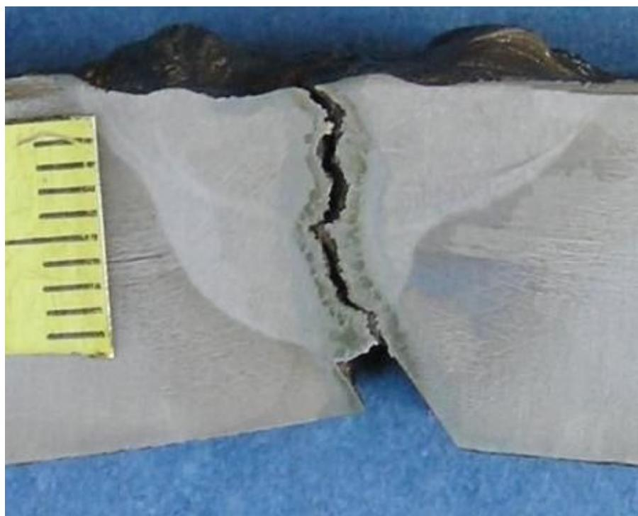
**Slika 4.2.10 Makroizbrusak uzorka 32 sa unosom topline 18 kJ/cm**
