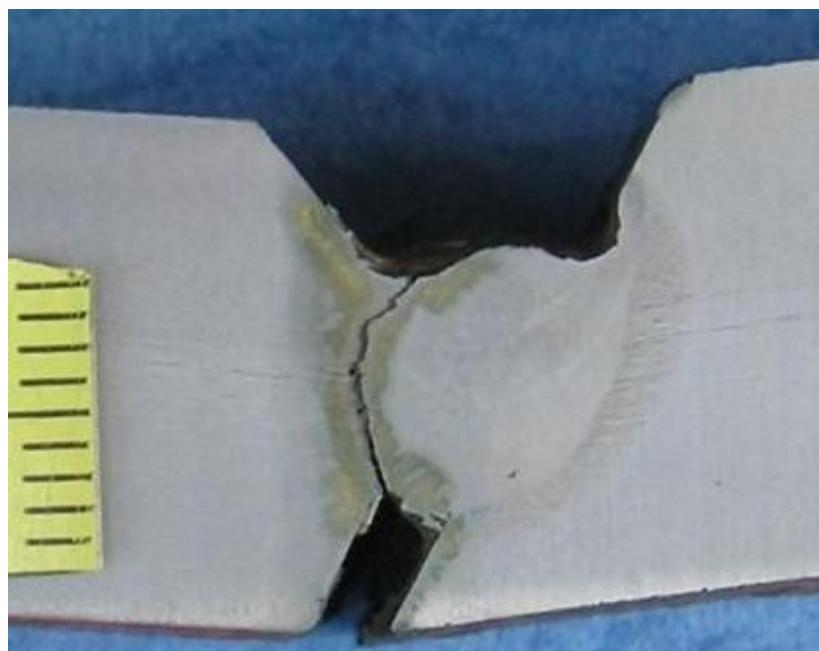
Slika 4.2.2 Makroizbrusak uzorka 11 sa unosom topline 12 kJ/cm
