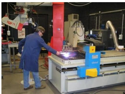
**Slika 3.5.2 Rezanje ploča zračnom plazmom na grube mjere**
