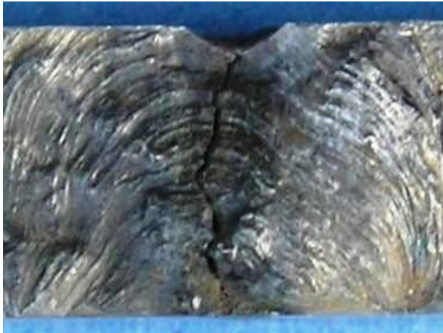
Slika 4.2.11 Lice zavara uzorka 33 sa unosom topline 18 kJ/cm
