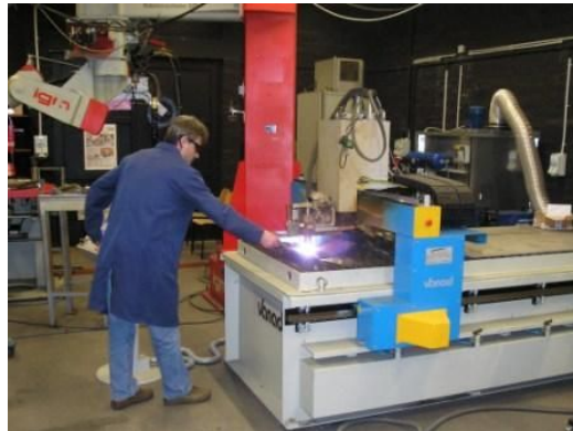
Slika 3.5.2 Rezanje ploča zračnom plazmom na grube mjere
