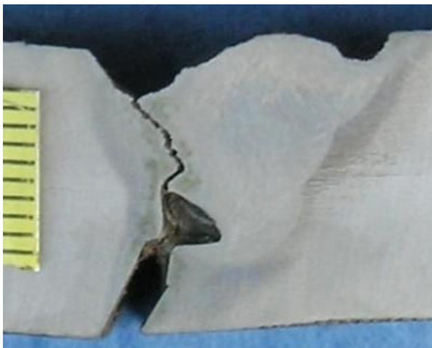
Slika 4.2.6 Makroizbrusak uzorka 21 sa unosom topline 15 kJ/cm
