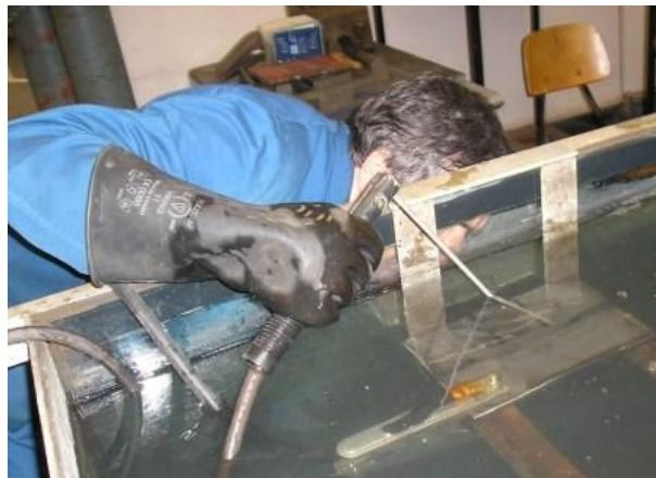
Slika 3.5.6 Pozicioniranje pištolja na
