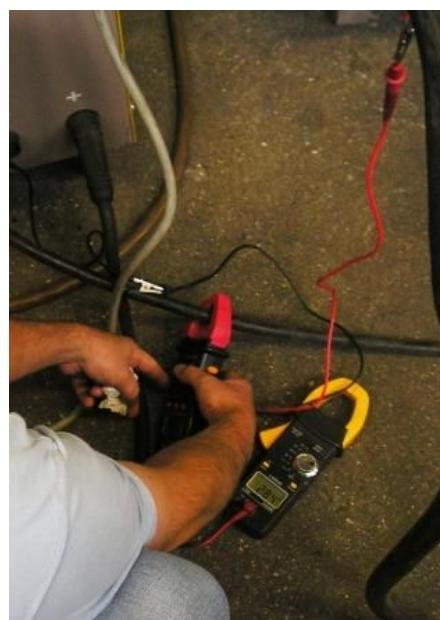
**Slike 3.5.1 Mjerenje parametara zavarivanja**
