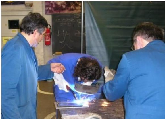
Slika 3.5.4 Zavarivanje pomoćnih zavara
