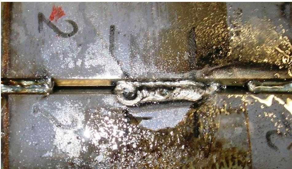
Slika 3.5.10 Izgled zavarenog uzorka 2 za Tekken-test s unosom topline 15 kJ/cm
