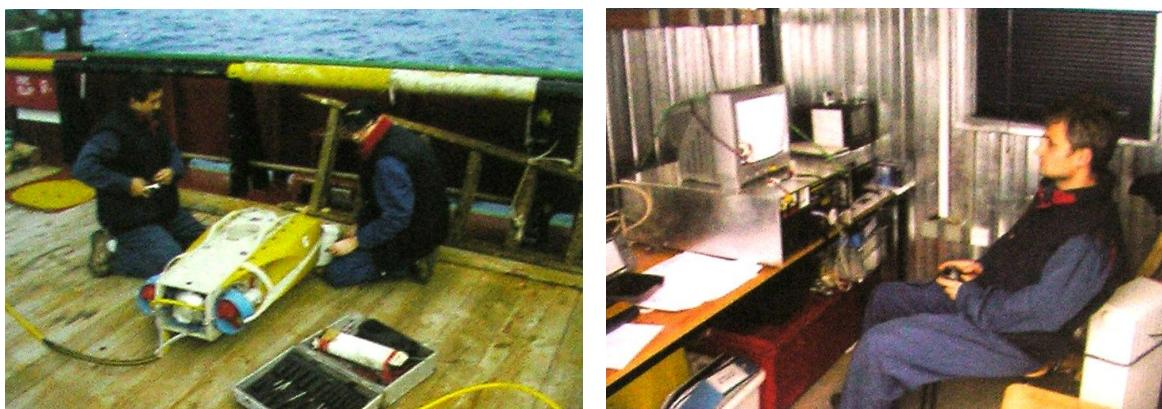
**Slika 2.2.10 Priprema ronilice za uron [43] Slika 2.2.11 Praćenje ronilice tijekom ispitivanja [43]**
