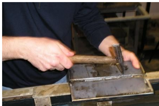
Slike 3.5.8 Čišćenje ispitnog zavora žičanom četkom i čekićem
