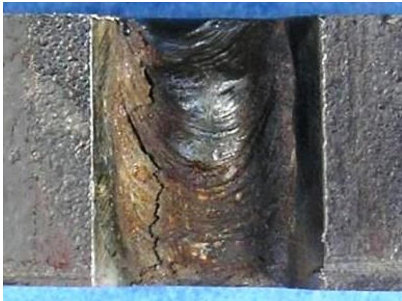
Slika 4.2.1 Lice zavara uzorka 11 sa unosom topline 12 kJ/cm
