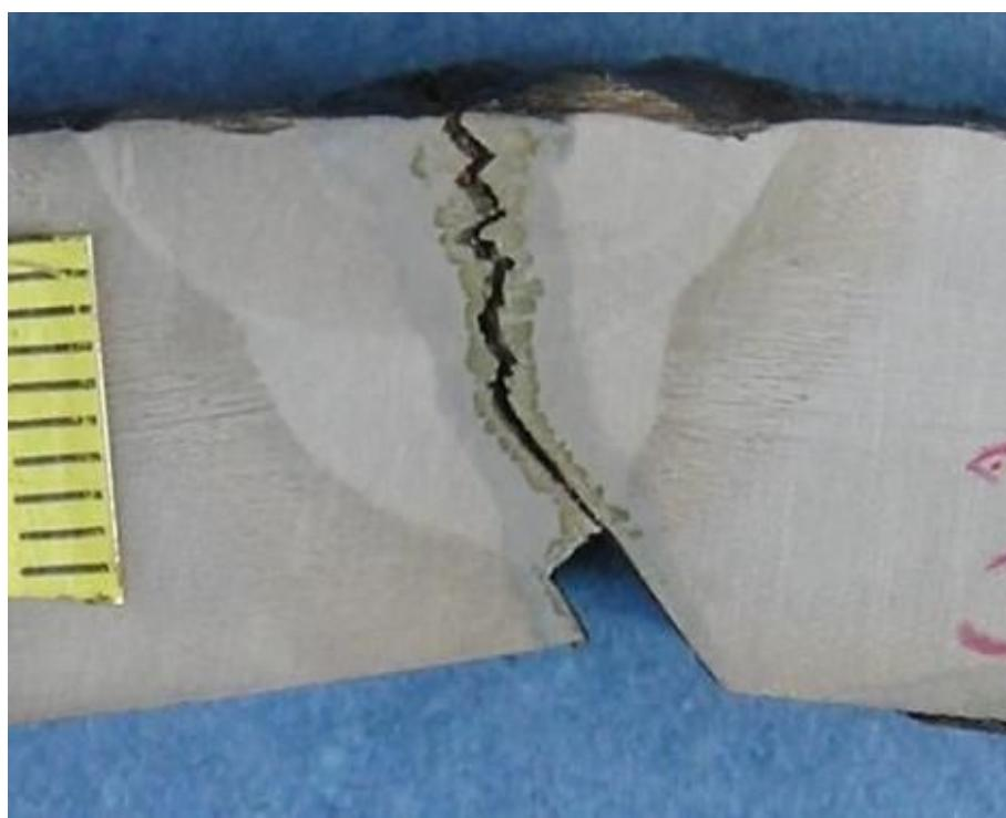
**Slika 4.2.12 Makroizbrusak uzorka 33 sa unosom topline 18 kJ/cm**
