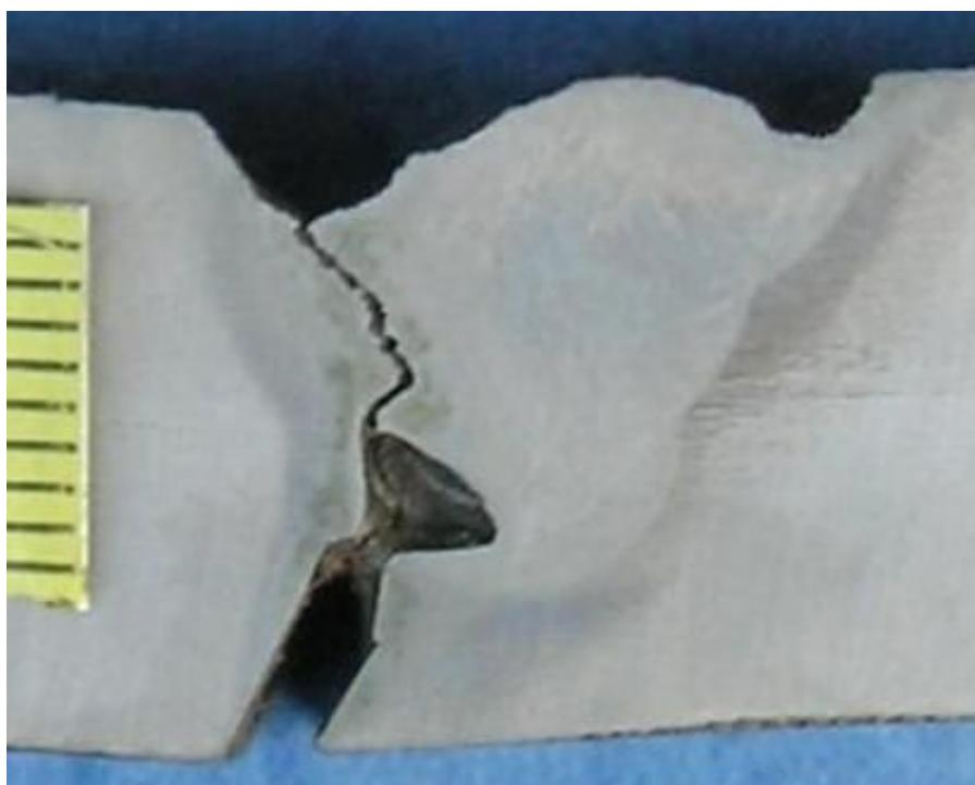
**Slika 4.2.6 Makroizbrusak uzorka 21 sa unosom topline 15 kJ/cm**
