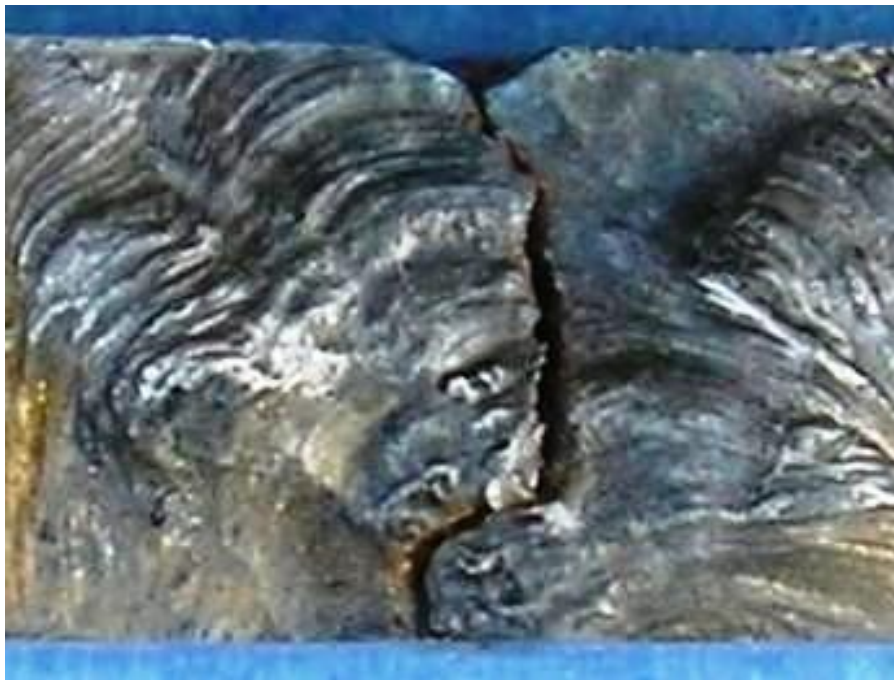
Slika 4.2.9 Lice zavara uzorka 32 sa unosom topline 18 kJ/cm
