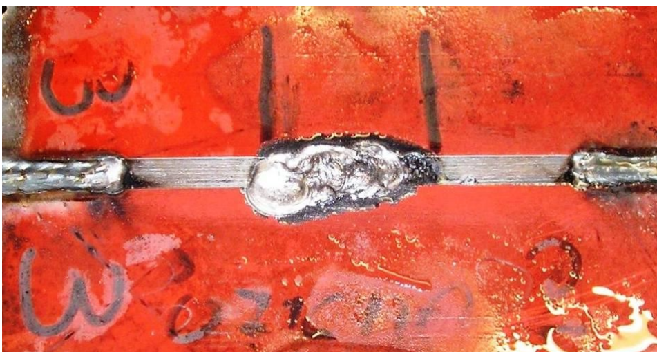
Slika 3.5.11 Izgled zavarenog uzorka 3 za Tekken-test s unosom topline 18 kJ/cm
