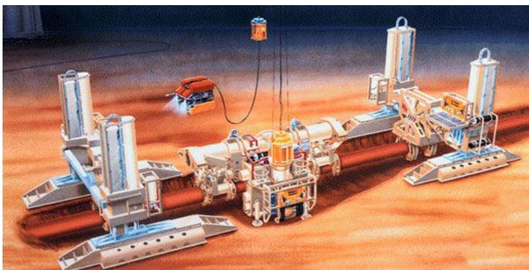
Slika 2.3.2 Podvodni habitat; sustav za popravak cjevovoda uključuje takozvane habitat module koji omogućuju roniocima rad u suhom okruženju na dnu mora [37]
