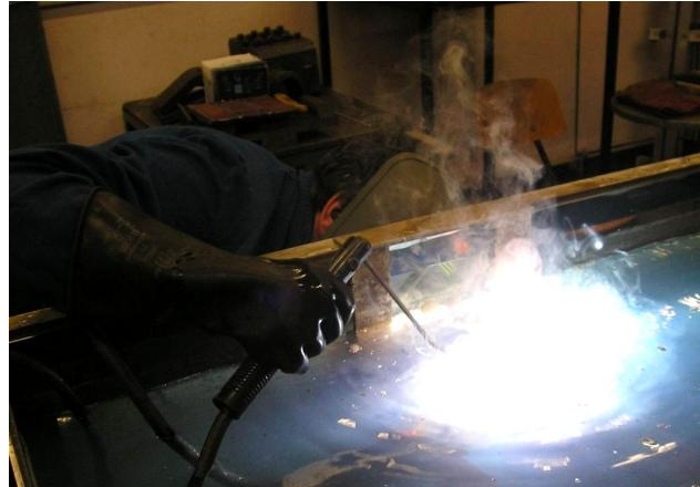
Slika 3.5.7 Podvodno REL zavarivanje
