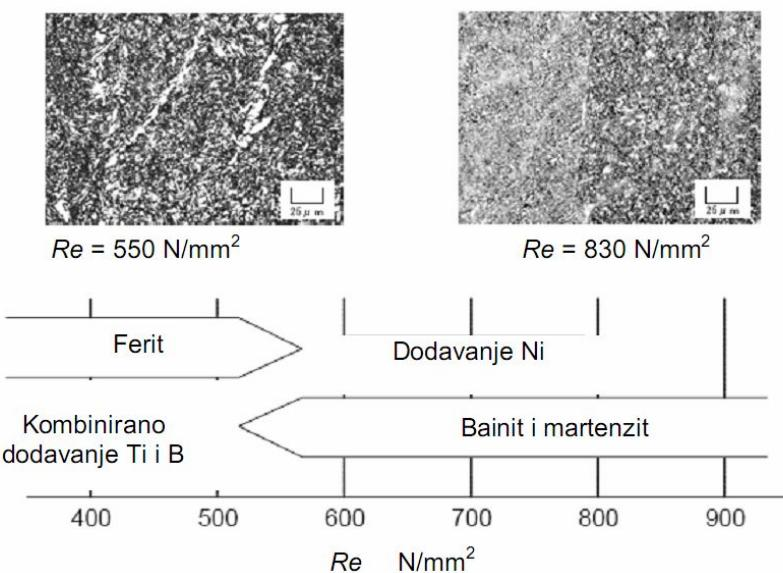
**Slika 2.7.7 Metode legiranja za povećanje čvrstoće metala zavara [16]**
