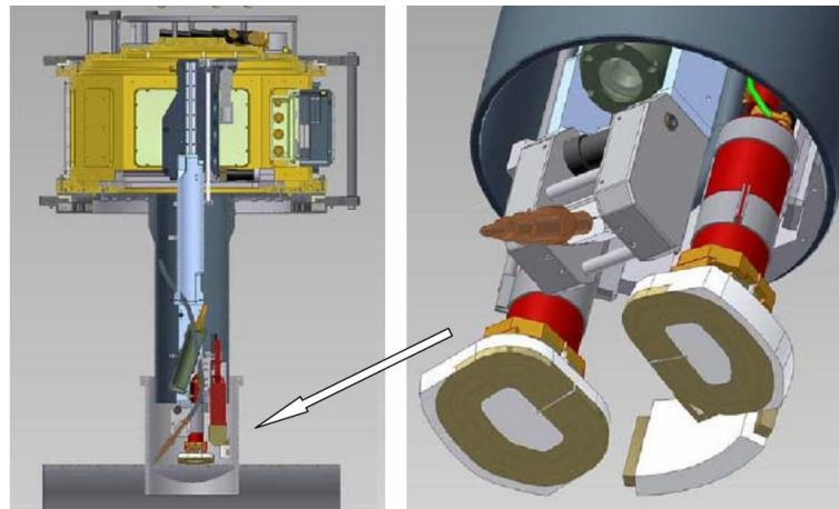
**Slika 2.2.1 Sustav za pozicioniranje cijevnog priključka s glavom za zavarivanje koja je opremljena kamerom, pištoljem za zavarivanje i induktivskim zavojnicama za predgrijavanje [32]**
