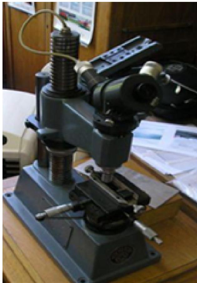
Slika 4.3.1 Tvrdomjer Reicherter TM12
