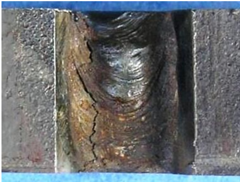
Slika 4.2.1 Lice zavora uzorka 11 sa unosom topline 12 kJ/cm
