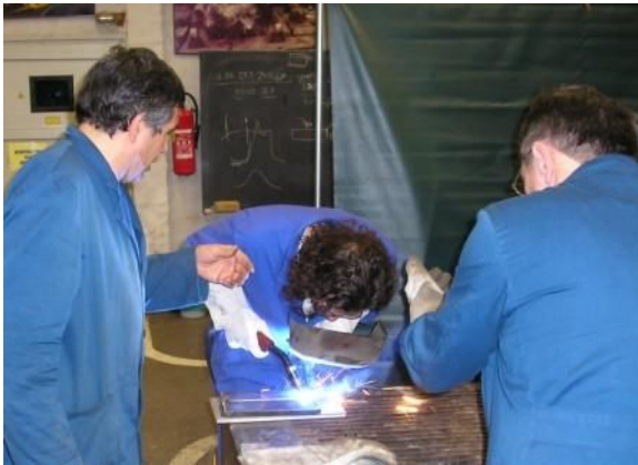
Slika 3.5.4 Zavarivanje pomoćnih zavora MAG postupkom
