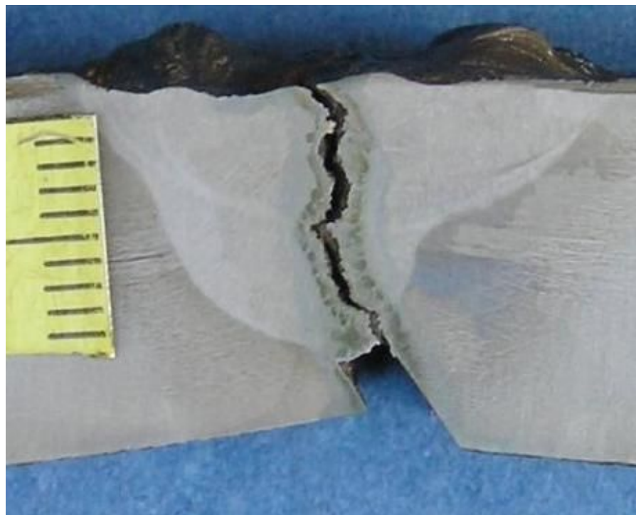
Slika 4.2.10 Makroizbrusak uzorka 32 sa unosom topline 18 kJ/cm
