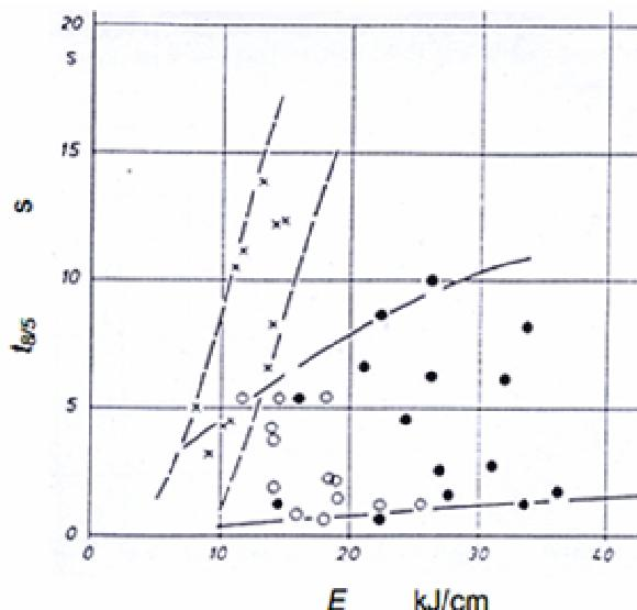
**Slika 2.4.1 Dijagram ovisnosti  $t_{8/5}$  o unosu topline za zavarivanje u normalnim uvjetima i pri mokrom podvodnom zavarivanju obloženom elektrodom; osnovni materijal St 37-2, debljina 20mm;**
