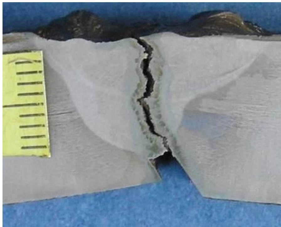
Slika 4.2.10 Makroizbrusak uzorka 32 sa unosom topline 18 kJ/cm
