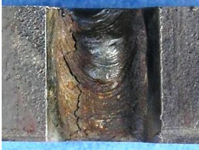
Slika 4.2.1 Lice zavara uzorka 11 sa unosom topline 12 kJ/cm
