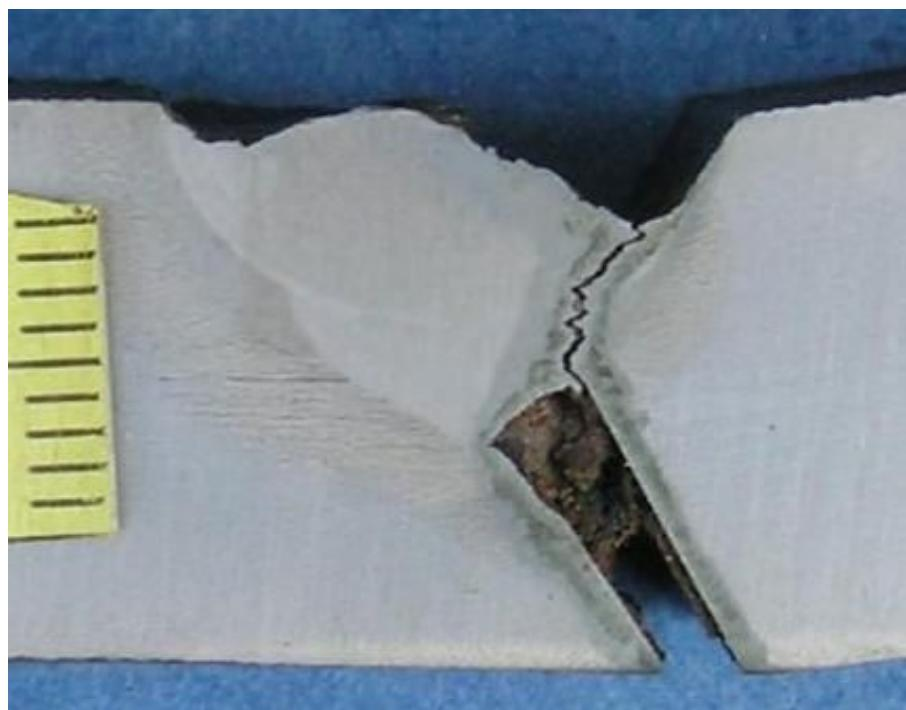
**Slika 4.2.8 Makroizbrusak uzorka 22 sa unosom topline 15 kJ/cm**
