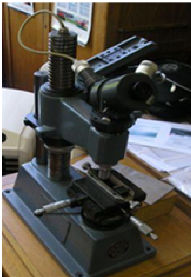
Slika 4.3.1 Tvrdomjer Reicherter TM12
