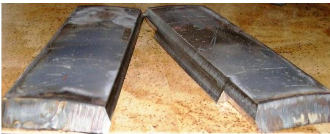
**Slike 3.5.3 Nacrt za obradu ploča glodanjem i prikaz pripreme uzorka nakon strojne obrade**
