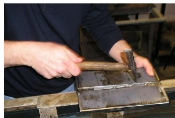
Slike 3.5.8 Čišćenje ispitnog zavara žičanom četkom i čekićem
