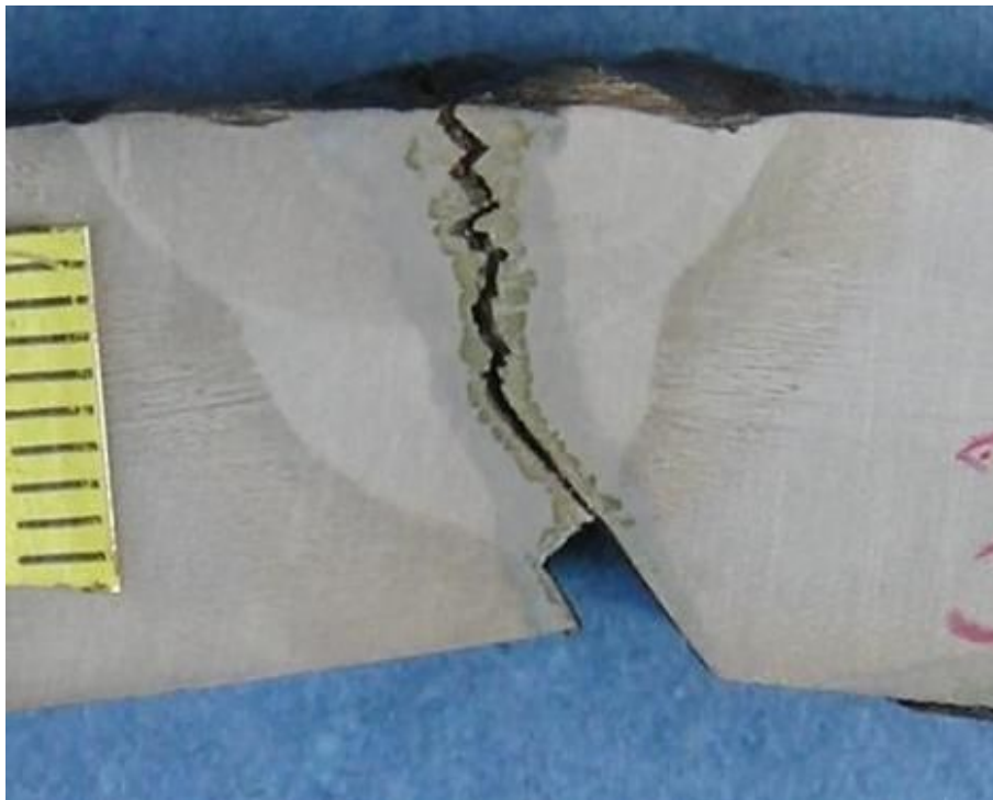
Slika 4.2.12 Makroizbrusak uzorka 33 sa unosom topline 18 kJ/cm
