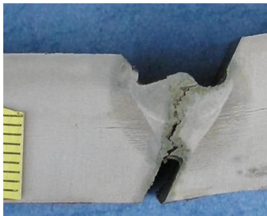
**Slika 4.2.4 Makroizbrusak uzorka 12 sa unosom topline 12 kJ/cm**
