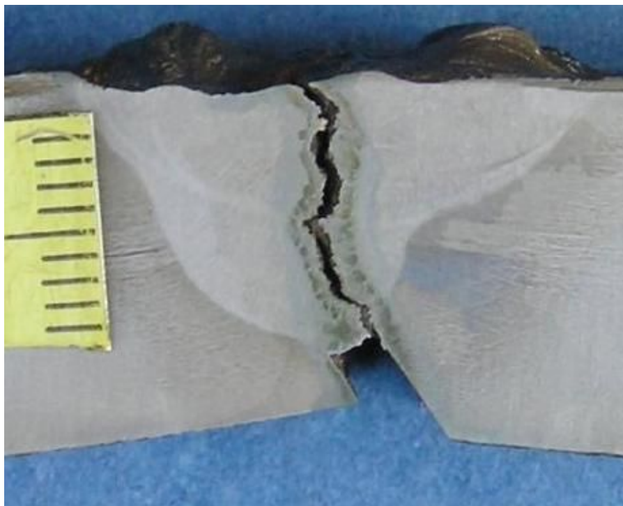
Slika 4.2.10 Makroizbrusak uzorka 32 sa unosom topline 18 kJ/cm
