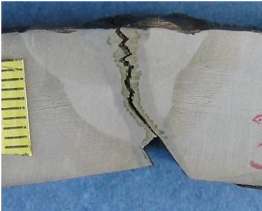
Slika 4.2.12 Makroizbrusak uzorka 33 sa unosom topline 18 kJ/cm
