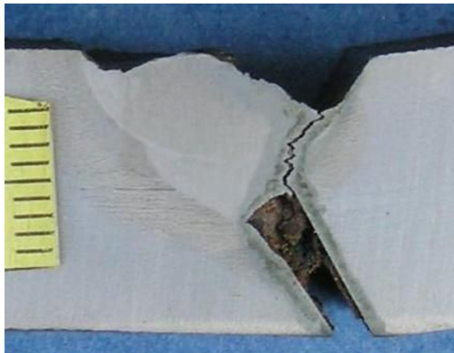
Slika 4.2.8 Makroizbrusak uzorka 22 sa unosom topline 15 kJ/cm
