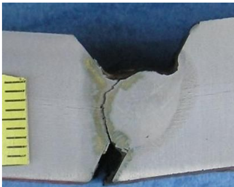
Slika 4.2.2 Makroizbrusak uzorka 11 sa unosom topline 12 kJ/cm
