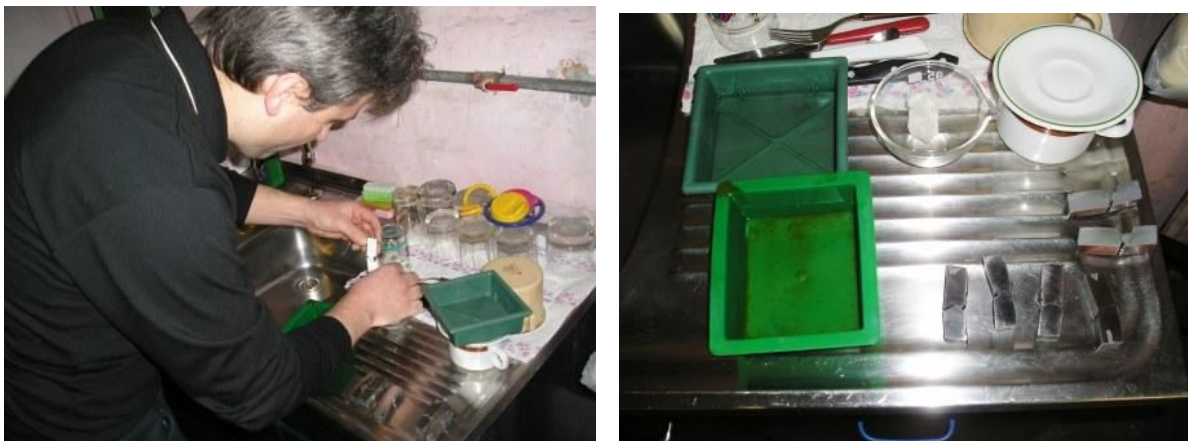
Slike 3.5.16 Nagrizanje brušenih uzoraka u otopini dušične kiseline
