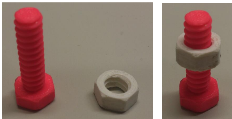
Slika 5.17 Vijak i matica MakerBota
