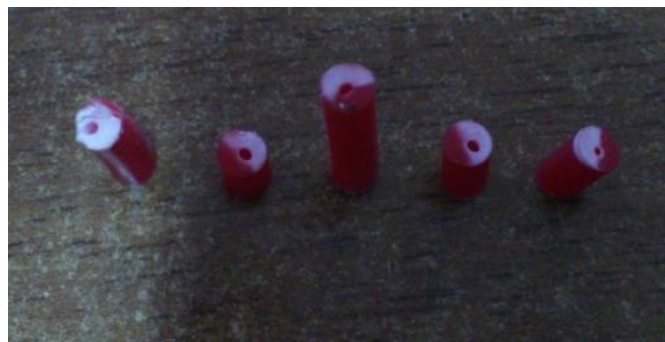
Slika 3.23 Rupice uslijed apsorbirane vlage u materijalu [40]
