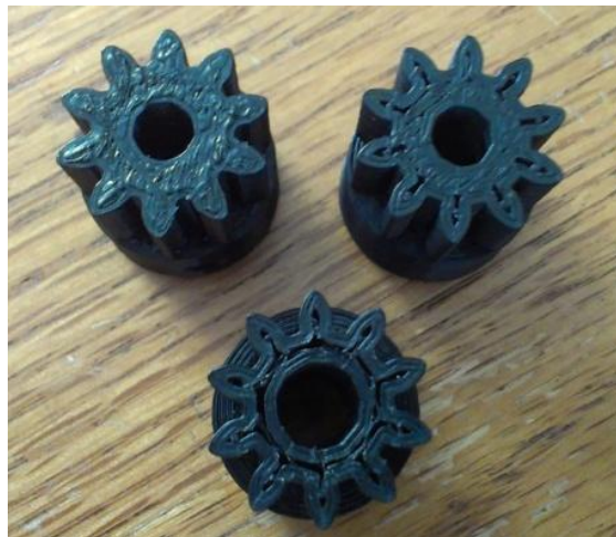
Slika 3.33 Neispunjavanje materijalom do kraja [51]
