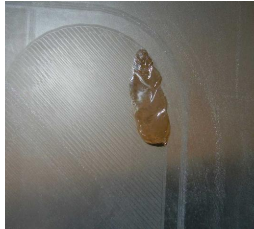
Slika 3.26 Pretjerano prijanjanje na podlogu [43, 44]
