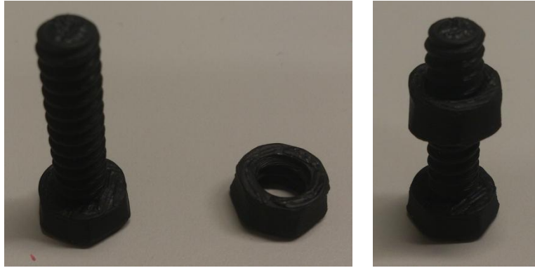
Slika 5.18 Vijak i matica Ultimakera
