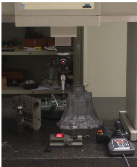
Slika 5.25 Mjerenje promjera držača osovine (SHF 16)
