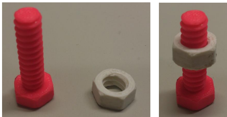
Slika 5.17 Vijak i matica MakerBota
