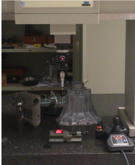
Slika 5.25 Mjerenje promjera držača osovine (SHF 16)
