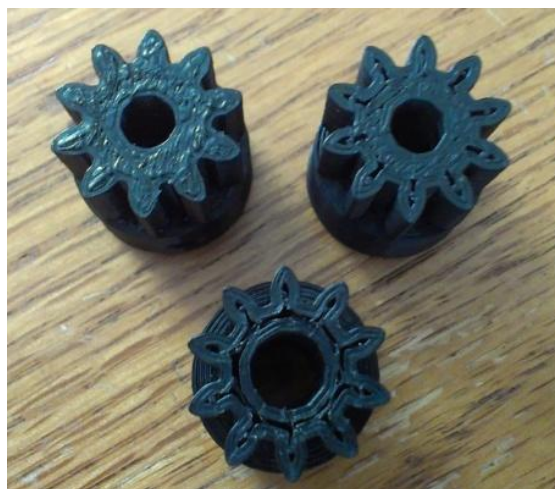
Slika 3.33 Neispunjavanje materijalom do kraja [51]
