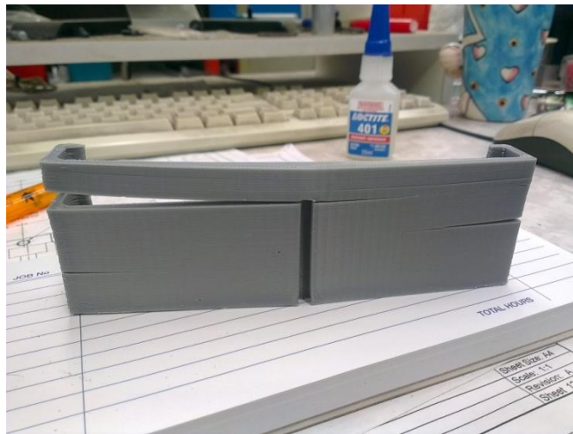
Slika 3.32 Raslojavanje modela zbog preniske temperature [50]
