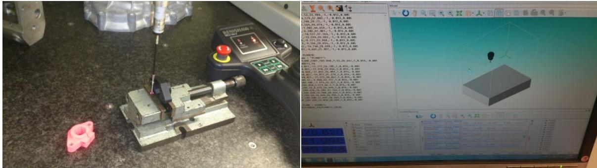
Slika 5.26 Mjerenje debljine držača osovine (SHF 16)
