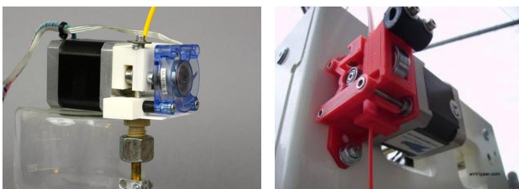
Slika 3.6 Mehanizmi ovisno o položaju motora [13,14]
