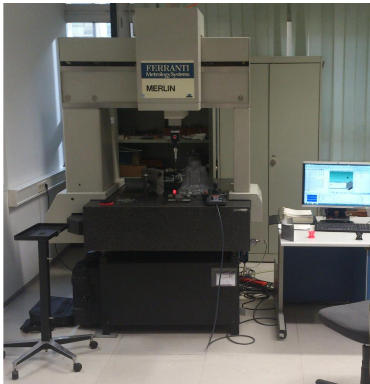
Slika 5.23 Trokoordinatni mjerni uređaj Ferranti 750
