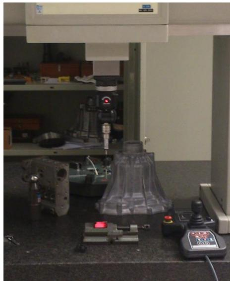
Slika 5.25 Mjerenje promjera držača osovine (SHF 16)
