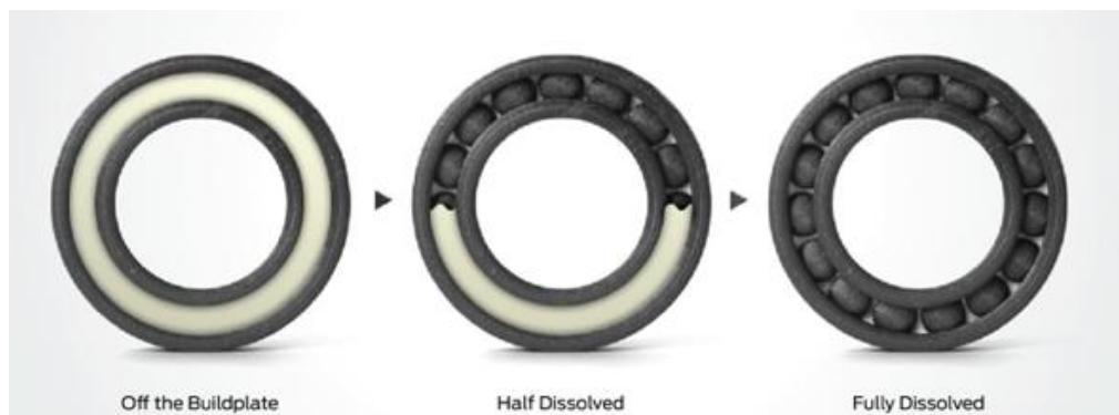
Slika 3.19 PS-HI potpora 3D isprintanog ležaja [35]
