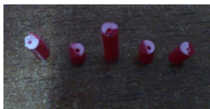
Slika 3.23 Rupice uslijed apsorbirane vlage u materijalu [40]
