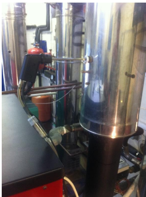
Slika 28. Mjerenje temperature i potlaka te uzimanje uzorka dimnih plinova
