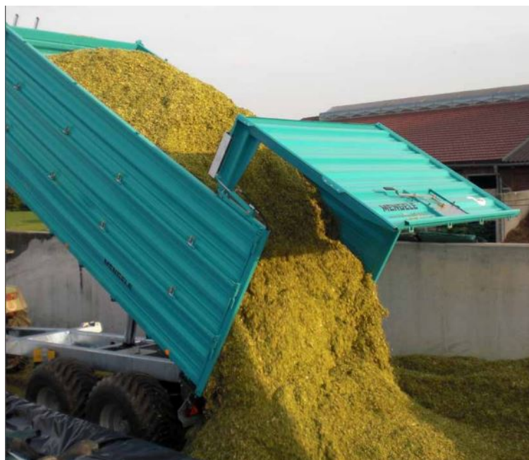
Slika 5. Prikolica sa hidrauličnim otvaranjem stražnje strane teretnog prostora [2]
