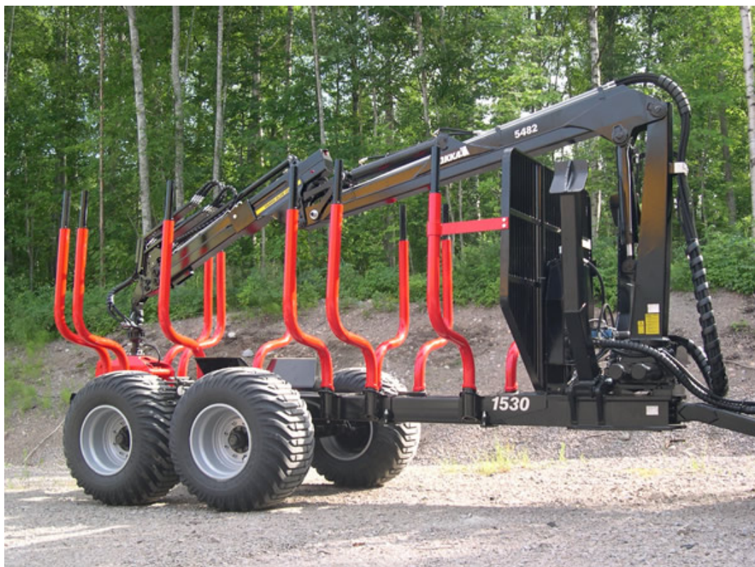
Slika 11. Šumska traktorska prikolica s dizalicom za prijevoz drvenih trupaca [6]
