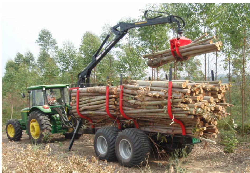
Slika 12. Šumska traktorska prikolica s dizalicom u radu [6]
