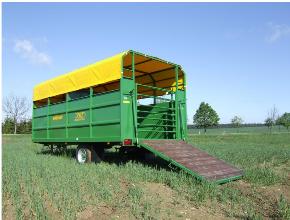
Slika 9. Prikolica za prijevoz stoke [4]
