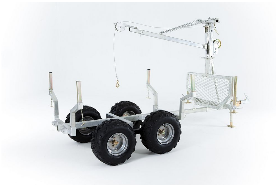
Slika 22. Traktorska prikolica T-Rex u izvedbi za prijevoz drvenih trupaca [15]
