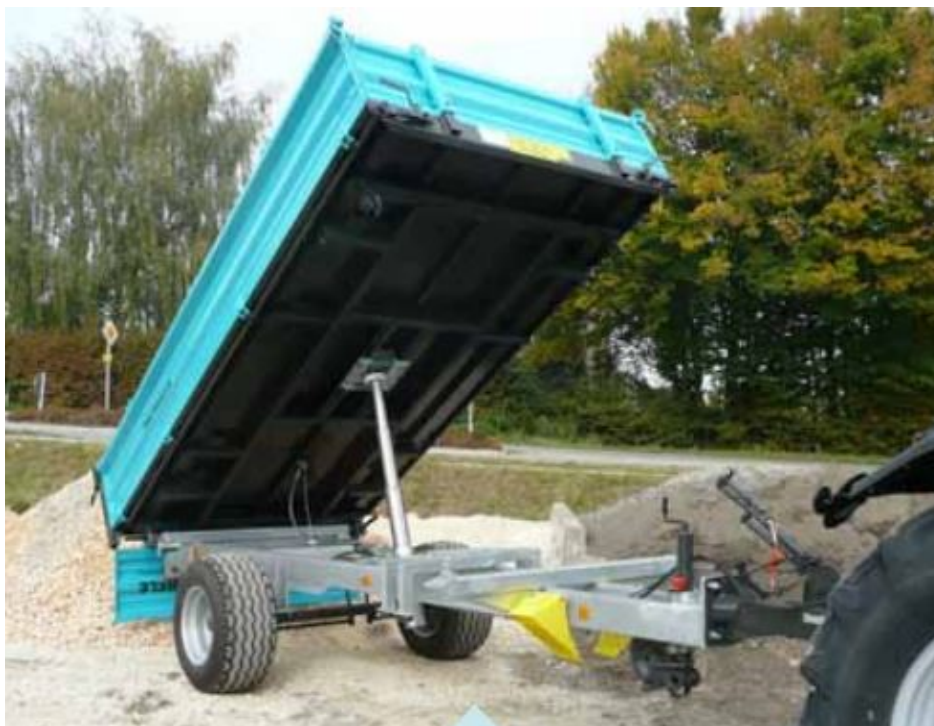
Slika 2. Prikolica u položaju stražnjeg istovara [2]
