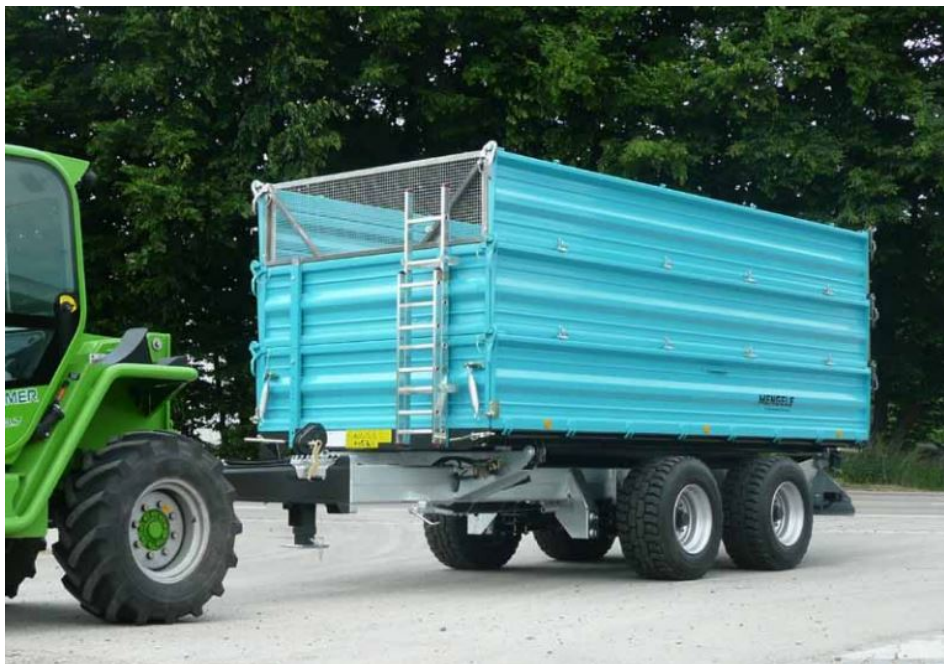
Slika 4. Dvoosovinska prikolica tvrtke Mengele model MEDK 16000 [2]
