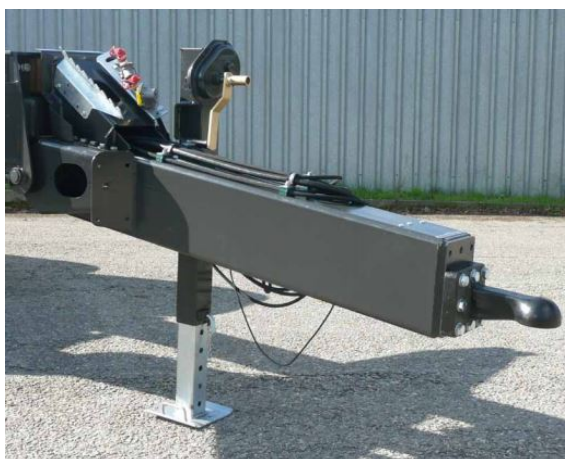
Slika 7. Ovješanje vučnog ruda prikolice [2]
