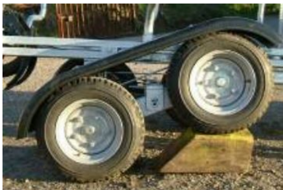
Slika 26. Ovjes s hodajućim gredama na prikolici Riko Fast Tow Forwarding trailer [16]
