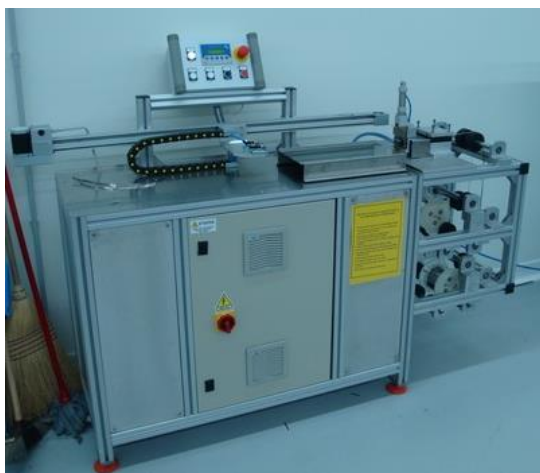
Slika 8. Stroj RC05A – stroj za rezanje spojnih traka [19]
