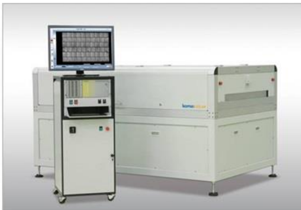
Slika 13. Xinspect 4000S – stroj za elektro-luminiscentno testiranje [21]
