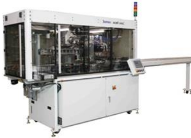
Slika 10. Komax Xcell 3400 – stroj za lemljenje ćelija u nizove [20]
