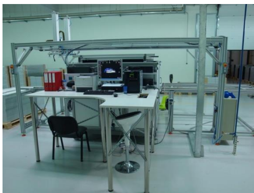
Slika 14. QuickSun 540LA – stroj za testiranje U – I karakteristika [19]
