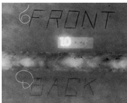
Slika 35. Utjecaj izgrebane olovne folije na rezultirajuću radiografsku snimku [4]
