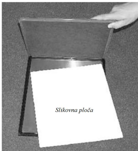
Slika 39. Otvorena CR kazeta sa slikovnom pločom [3]
