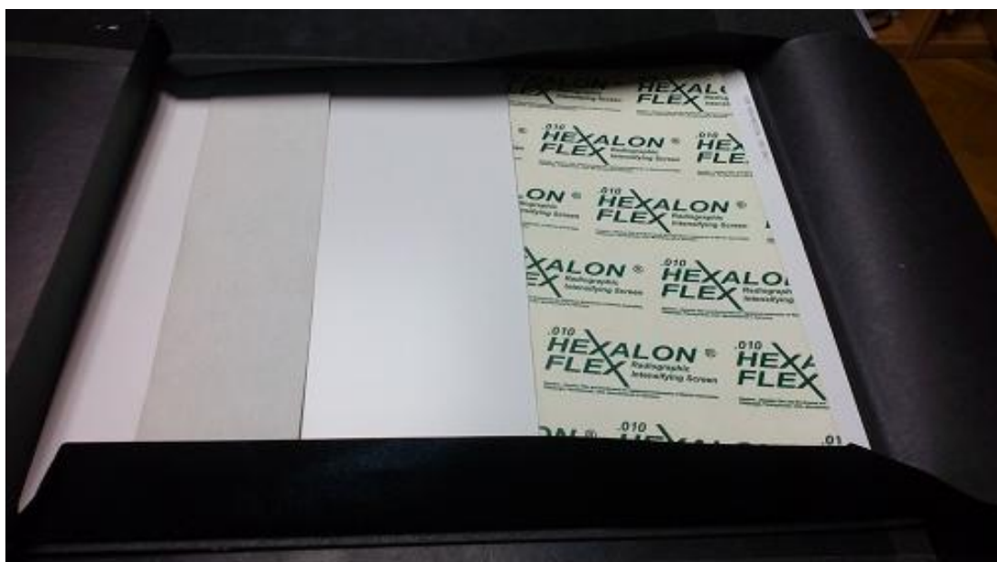
Slika 48. Korištene folije (tanja folija je lijevo, a deblja desno)
