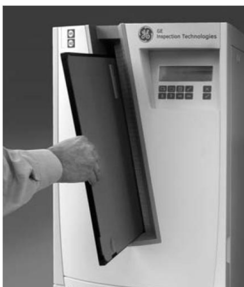
Slika 47. Automatizirani CR skener [3]
