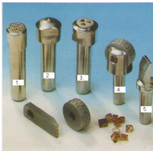
Slika 13. Prikaz alata za obradu rezne površine brusa [9]
