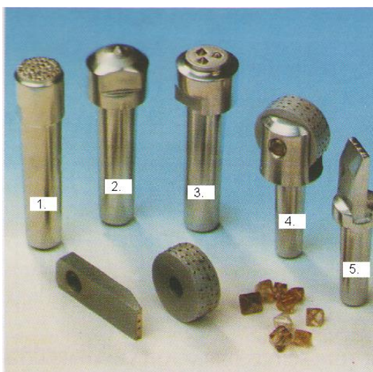
Slika 13. Prikaz alata za obradu rezne površine brusa [9]
