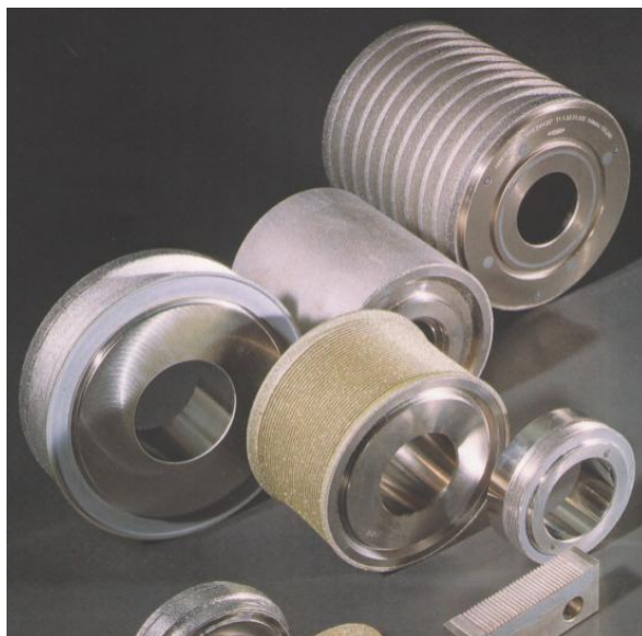
Slika 15. Rolice s dijamantnom prevlakom [10]
