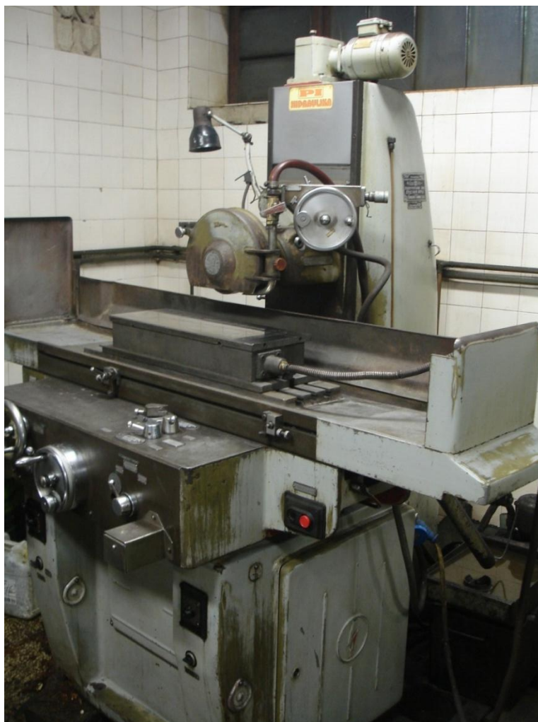
Slika 31. Brusilica za ravno obodno brušenje, Stanko Import
