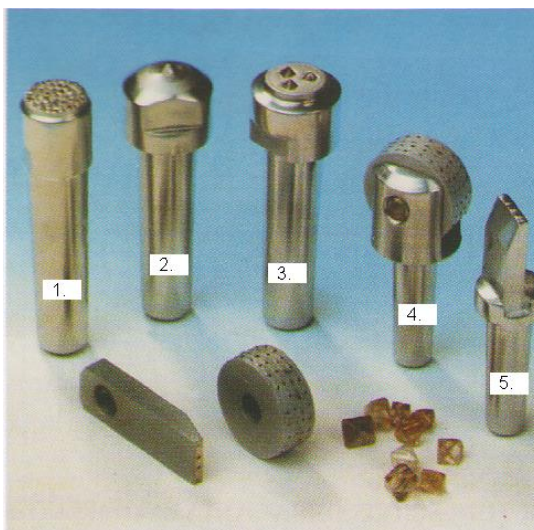
Slika 13. Prikaz alata za obradu rezne površine brusa [9]
