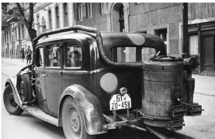
Slika 2. Generatorska jedinica smještena na zadnjem kraju automobila [13]
