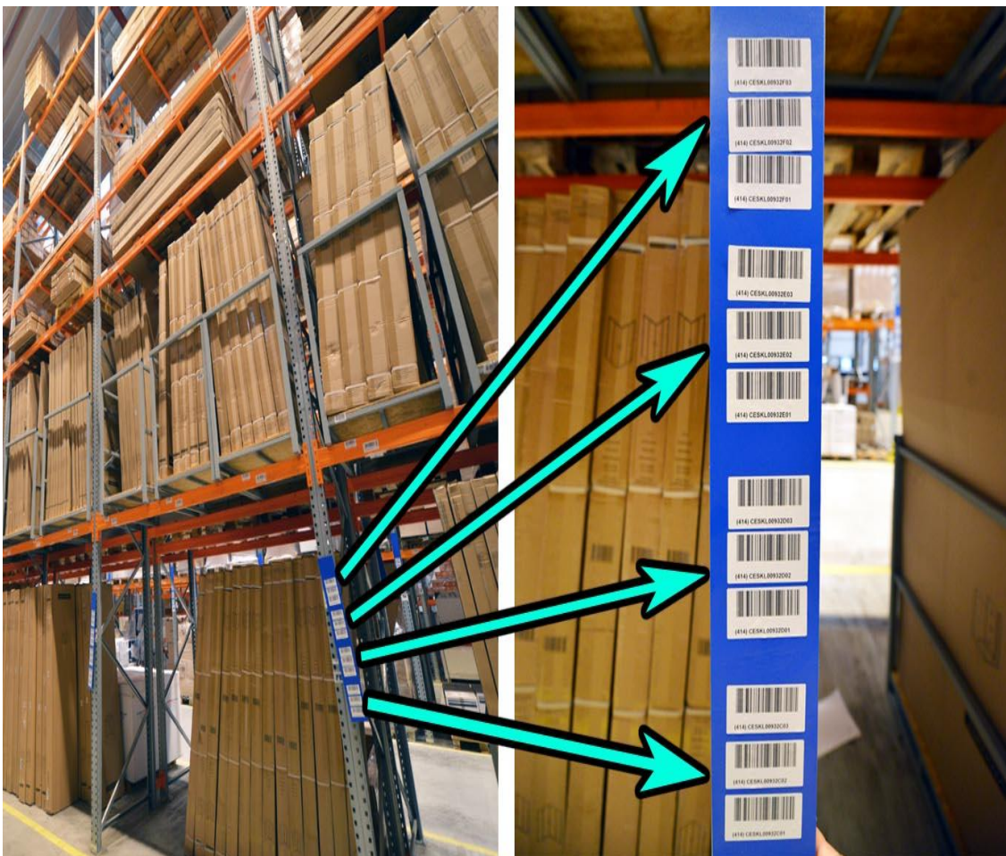
Slika 63. Skladišne lokacije označene barcode naljepnicom s viših razina
