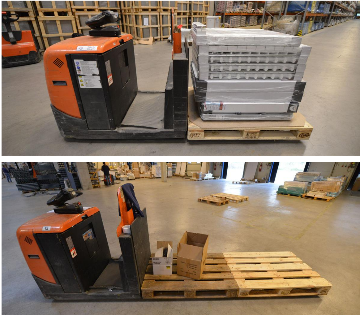
Slika 50. Usporedba električnog viličara za komisioniranje s kratkim i dugačkim vilicama u skladištu poduzeća Feroterm
