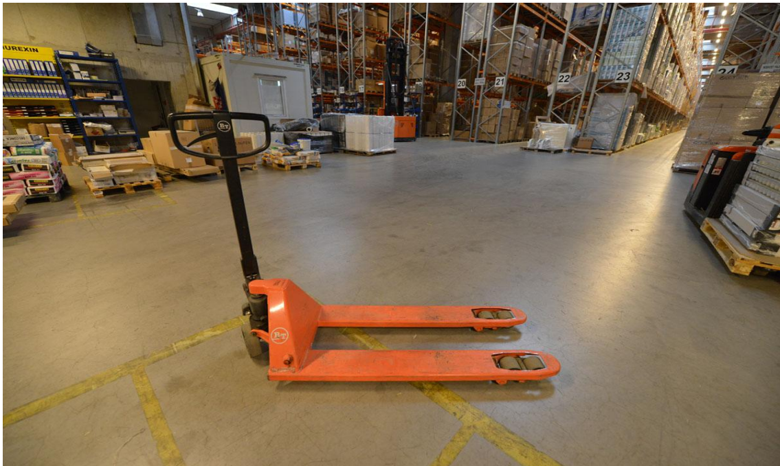
Slika 46. Ručni niskopodizni paletni viličar u skladištu poduzeća Feroterm
