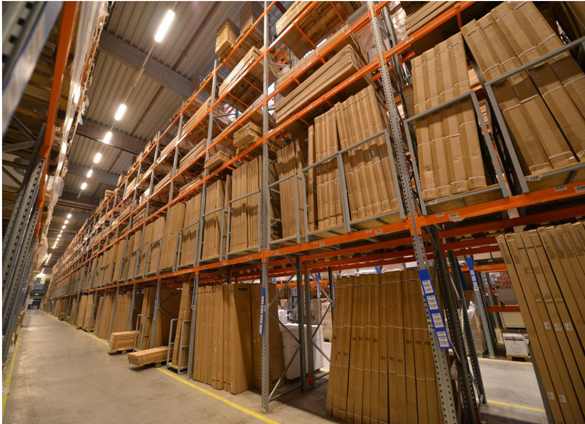
Slika 45. Dvostruki paletni regali izvedeni za pohranu dimenzijama specifične robe u skladištu poduzeća Feroterm
