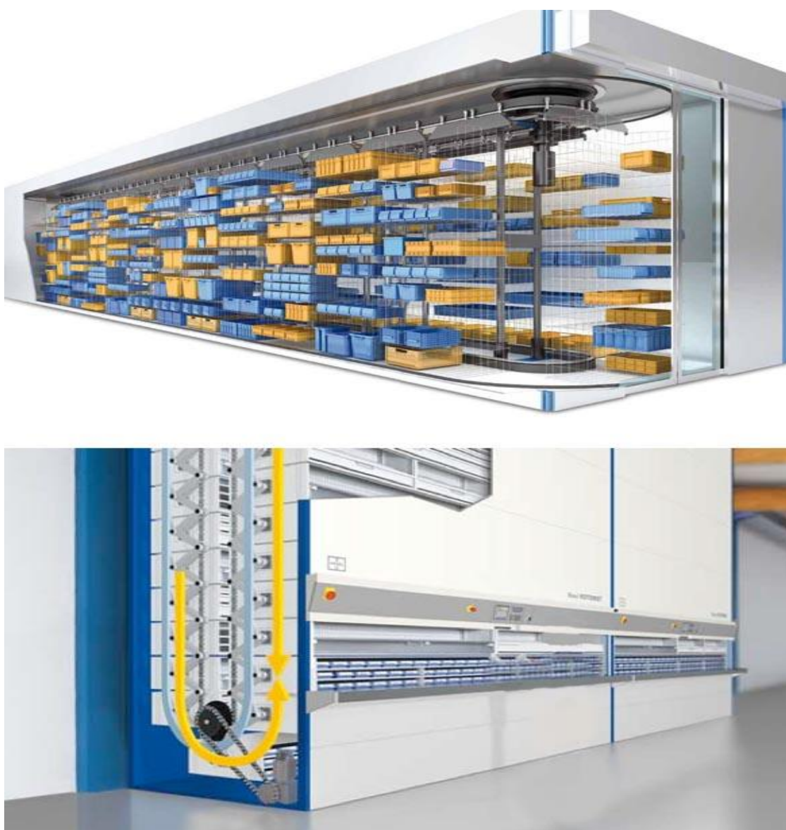
Slika 33. Horizontalna i vertikalna izvedba okretnih regala [33] [34]
