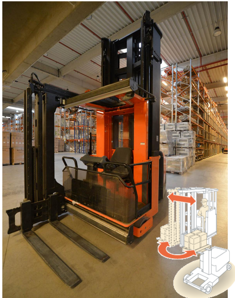
Slika 52. Visokopodizni viličar komisioner s zakretnim vilicama u skladištu poduzeća Feroterm
