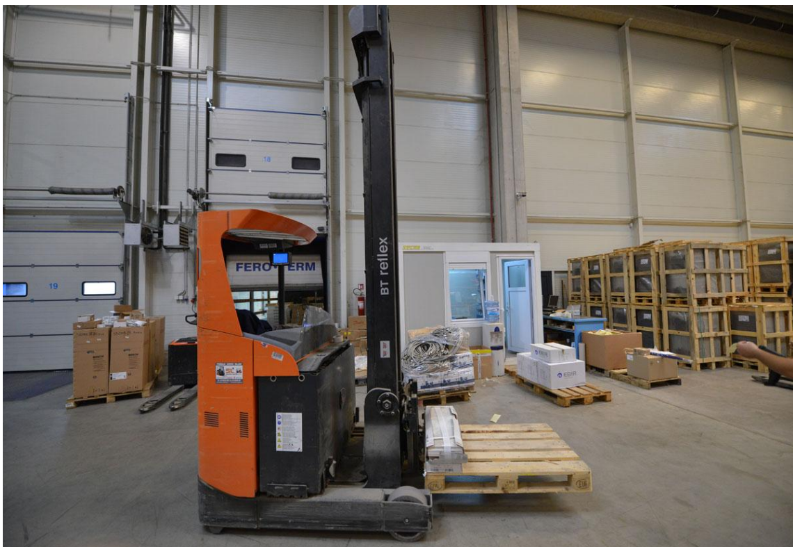
Slika 48. Električni regalni viličar u skladištu poduzeća Feroterm
