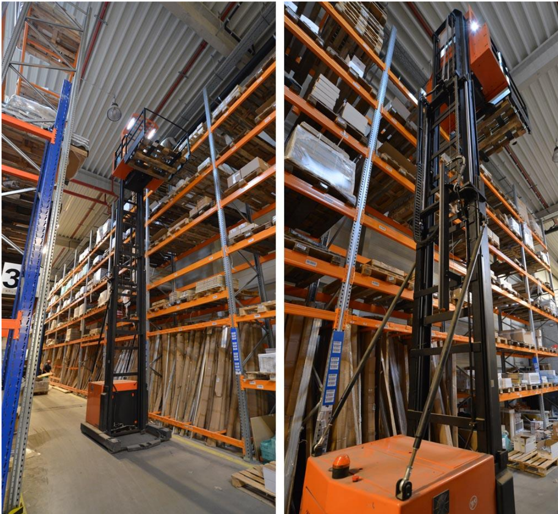
Slika 51. Visokopodizni viličar komisioner u skladištu poduzeća Feroterm
