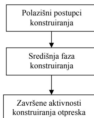
Slika 5.3. Tijek konstruiranja polimernog otpreska<sup>15</sup>
