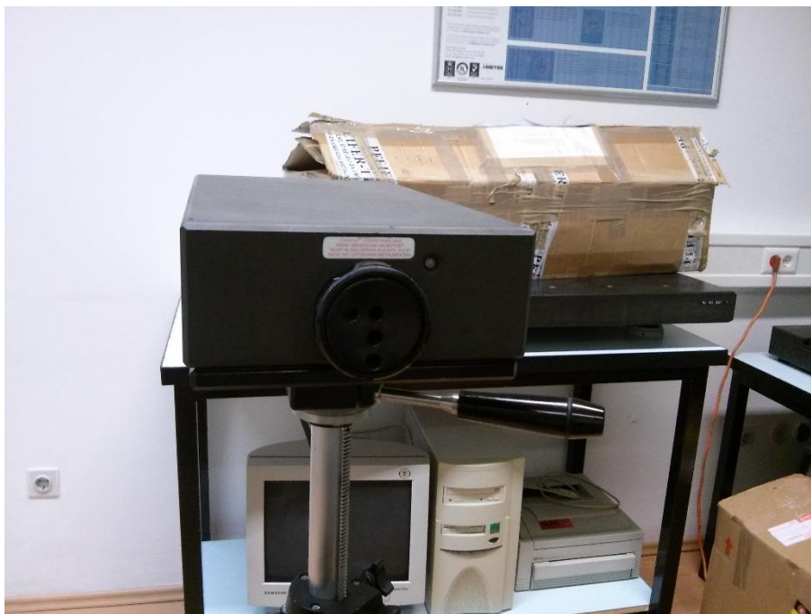
Slika 58 – Laserski interferometar, Izvor svjetlosti/detektor
