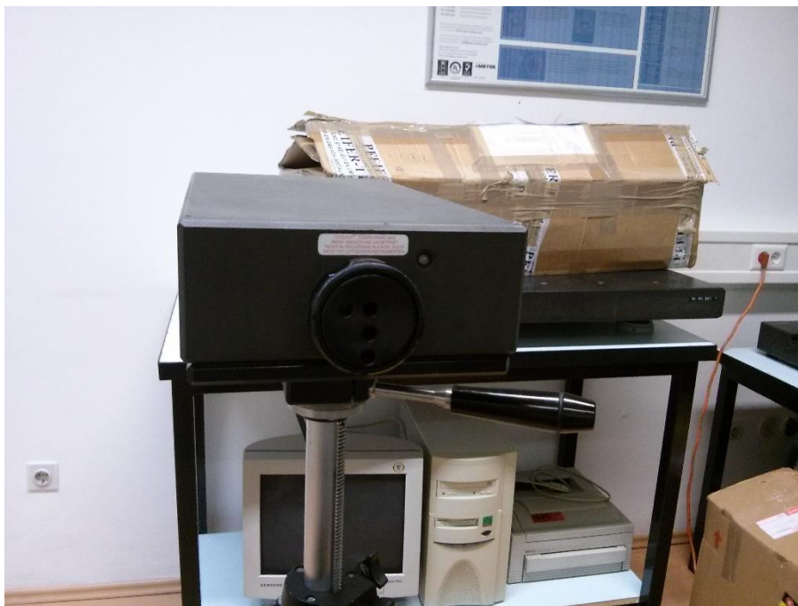
Slika 58 – Laserski interferometar, Izvor svjetlosti/detektor
