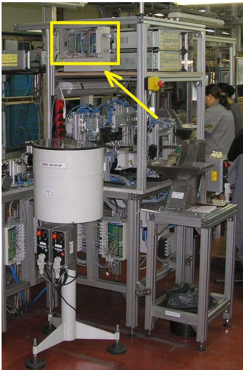
Slika 11. Lokacija napajачkih modula na automatu
