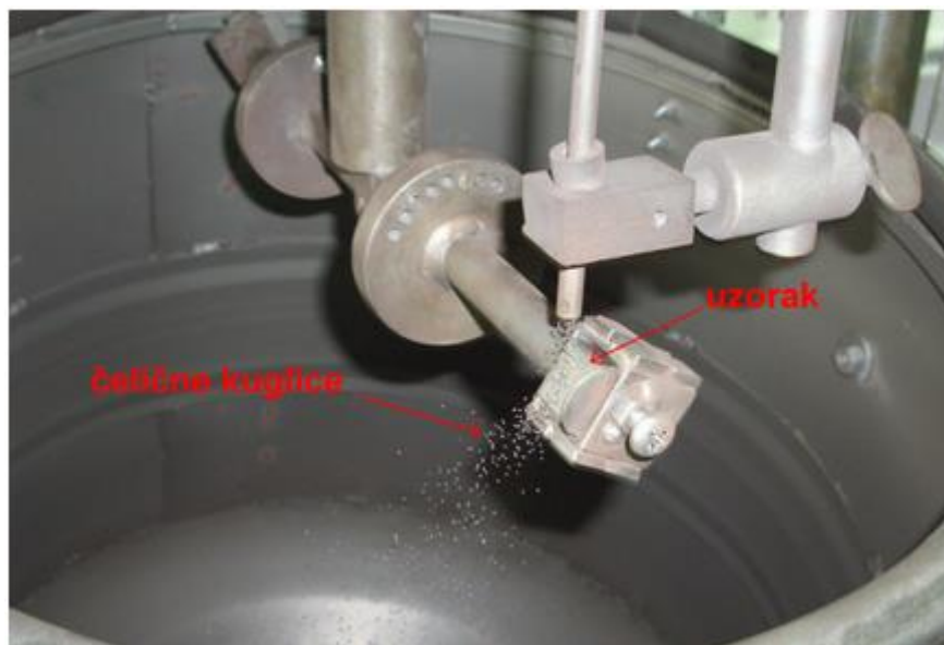
Slika 47. Ispitivanje otpornosti na erozijsko trošenje
