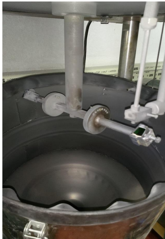
Slika 46. Detalj A na uređaju za ispitivanje erozijskog trošenja
