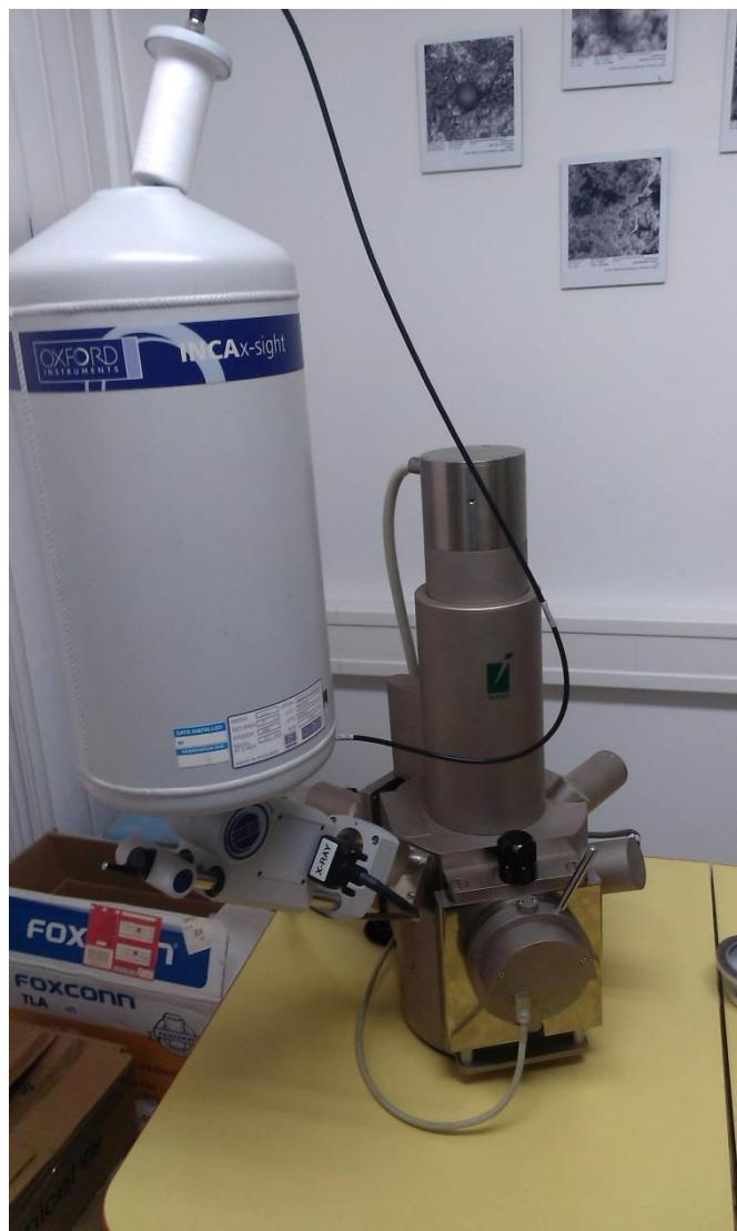
**Slika 73. SEM elektronski mikroskop Tescan Vega 5136 MN.**
