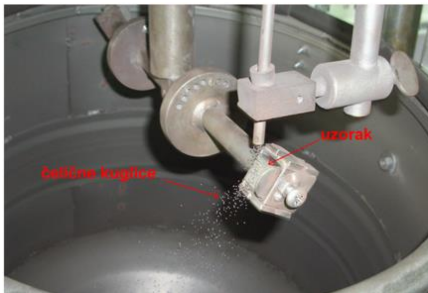
Slika 47. Ispitivanje otpornosti na erozijsko trošenje
