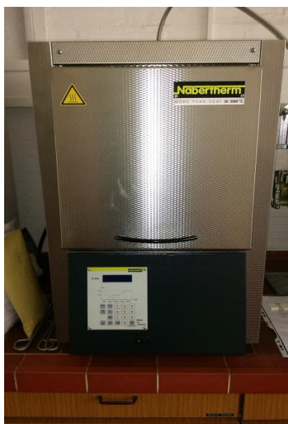
Slika 25. Peć u kojoj su uzorci kalcinirani
