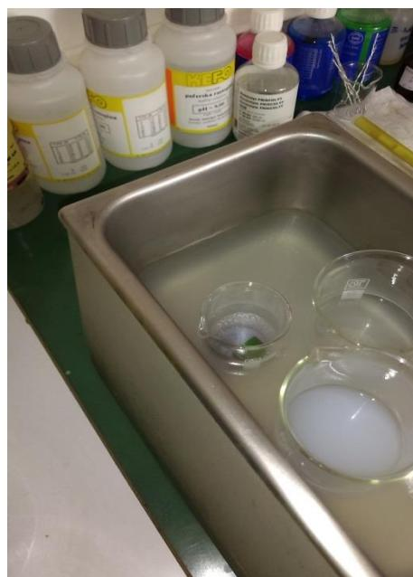
**Slika 20. Uzorak u ultrazvučnoj kupelji**
