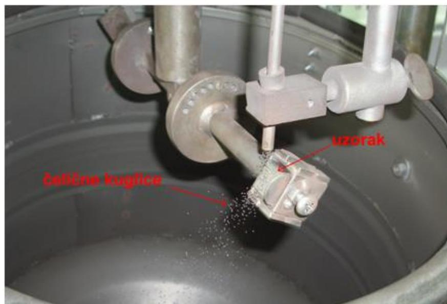
Slika 47. Ispitivanje otpornosti na erozijsko trošenje
