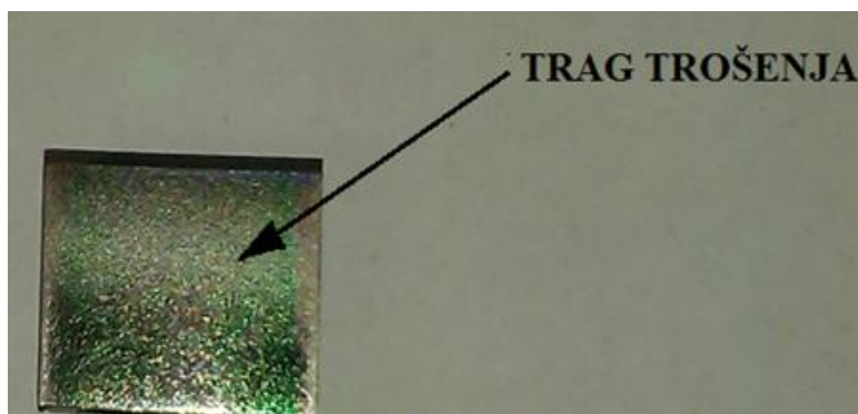
Slika 51. Izgled uzorka nakon provedenog postupka erozijskog trošenja
