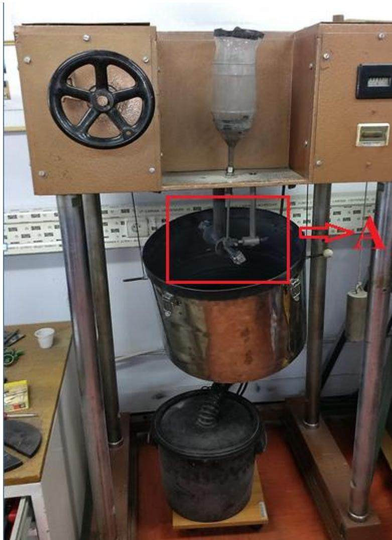
Slika 44. Uredaj za ispitivanje otpornosti na erozijsko trošenje
