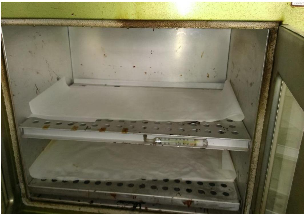
**Slika 21. Uređaj za sušenje uzoraka**
