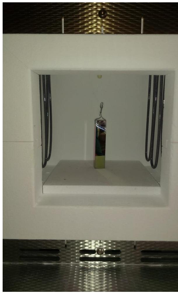
**Slika 26. Uzorak prilikom postupka kalciniranja**
