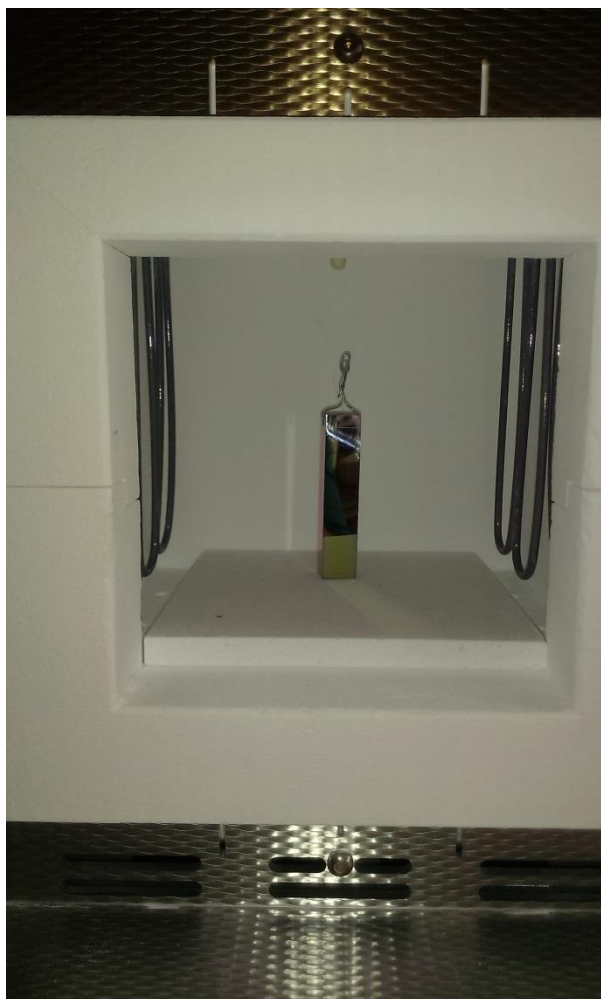
Slika 26. Uzorak prilikom postupka kalciniranja
