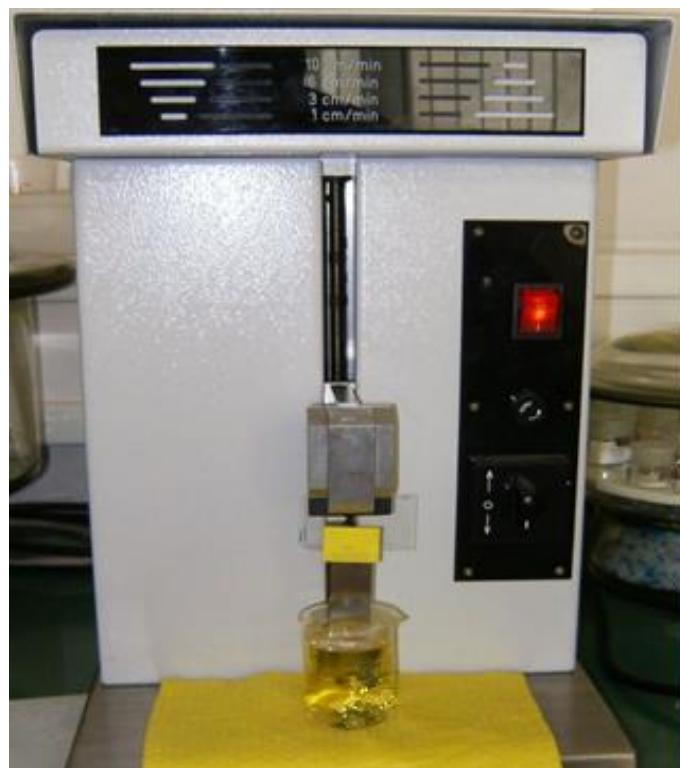
**Slika 22. Uredaj za uranjanje i izranjanje uzorka**
