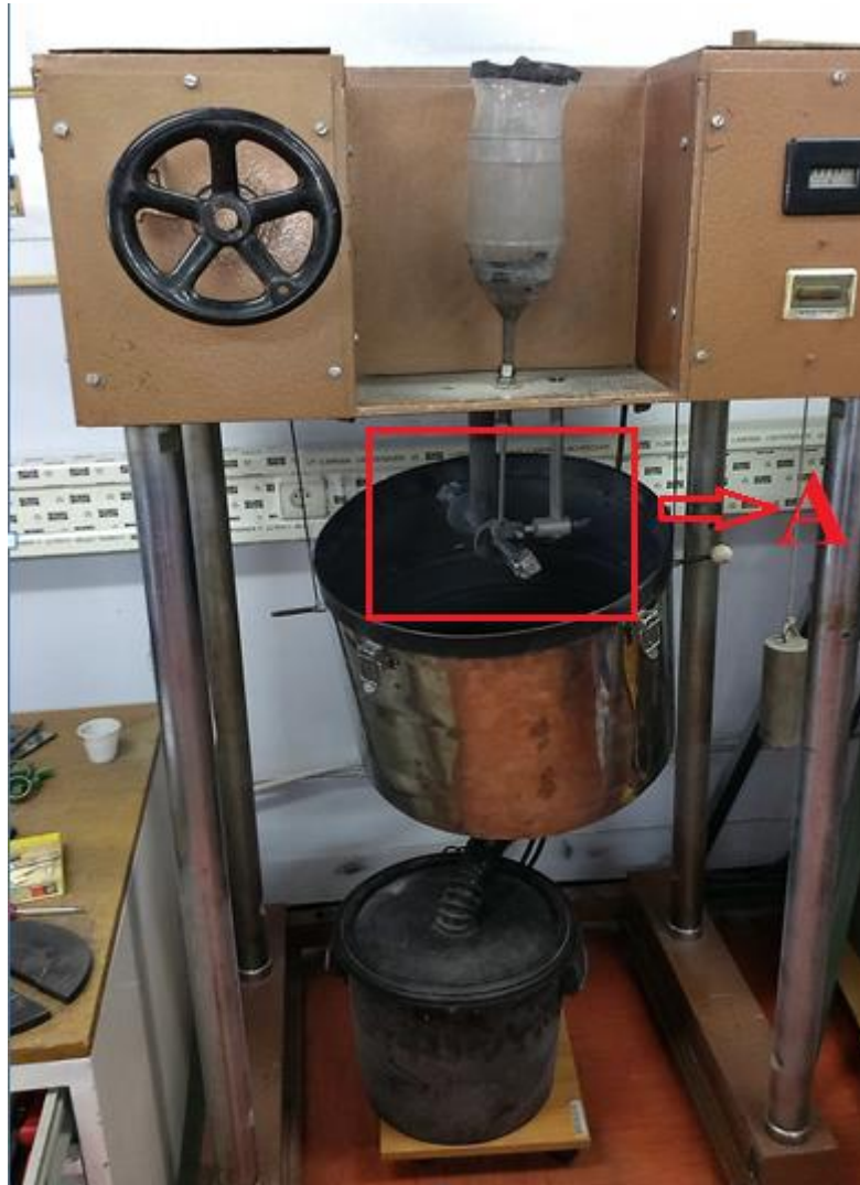
Slika 44. Uređaj za ispitivanje otpornosti na erozijsko trošenje
