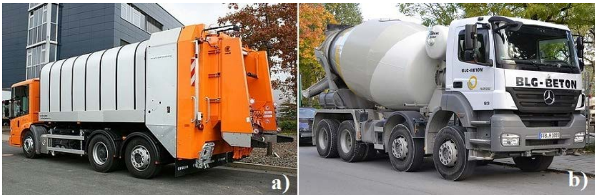
Slika 2. a) Kamion s sandukom za prijevoz i prešanje otpada, b) automješalica za beton [3]
