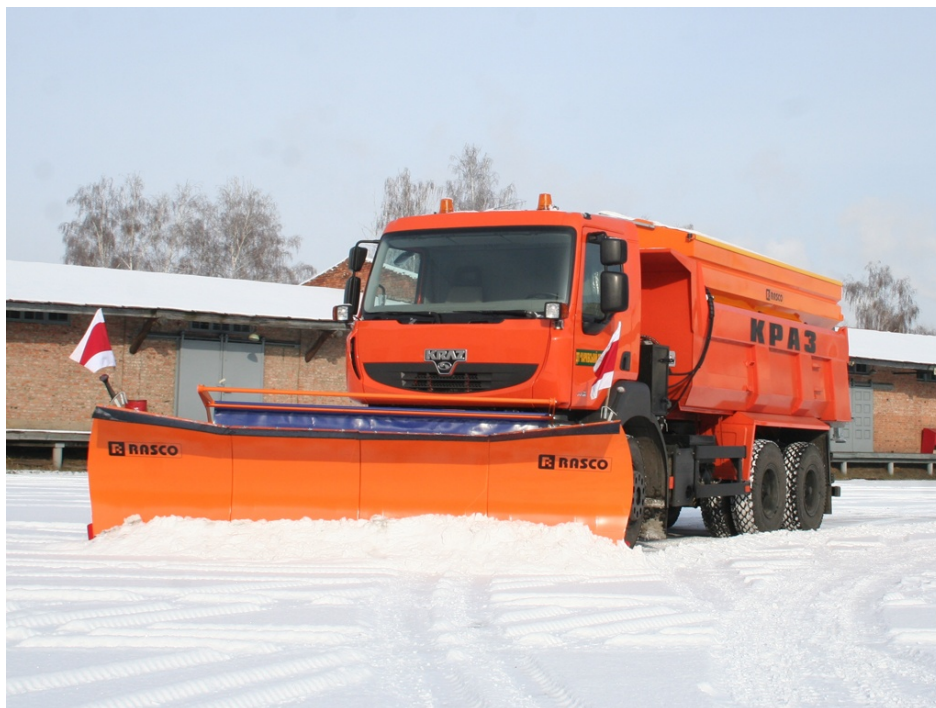
Slika 3. Kamion s snježnim plugom i posipačom [4]
