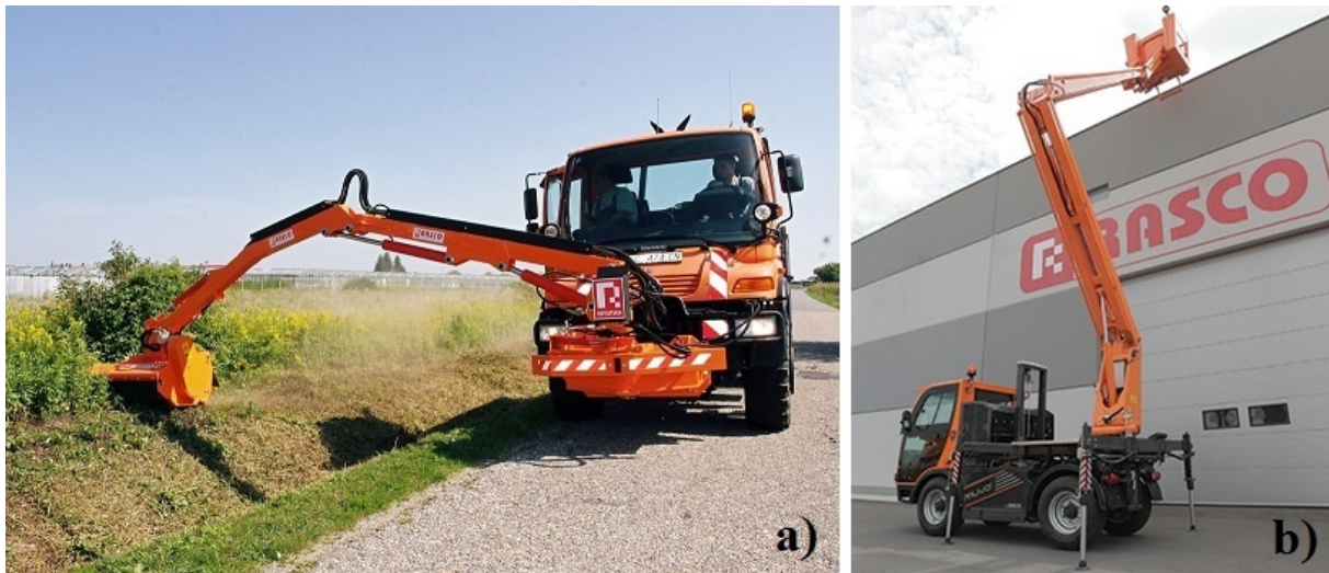
Slika 4. a) Kamion s prednjom kranskom kosilicom, b) kamion s platformom za podizanje ljudi [4]
