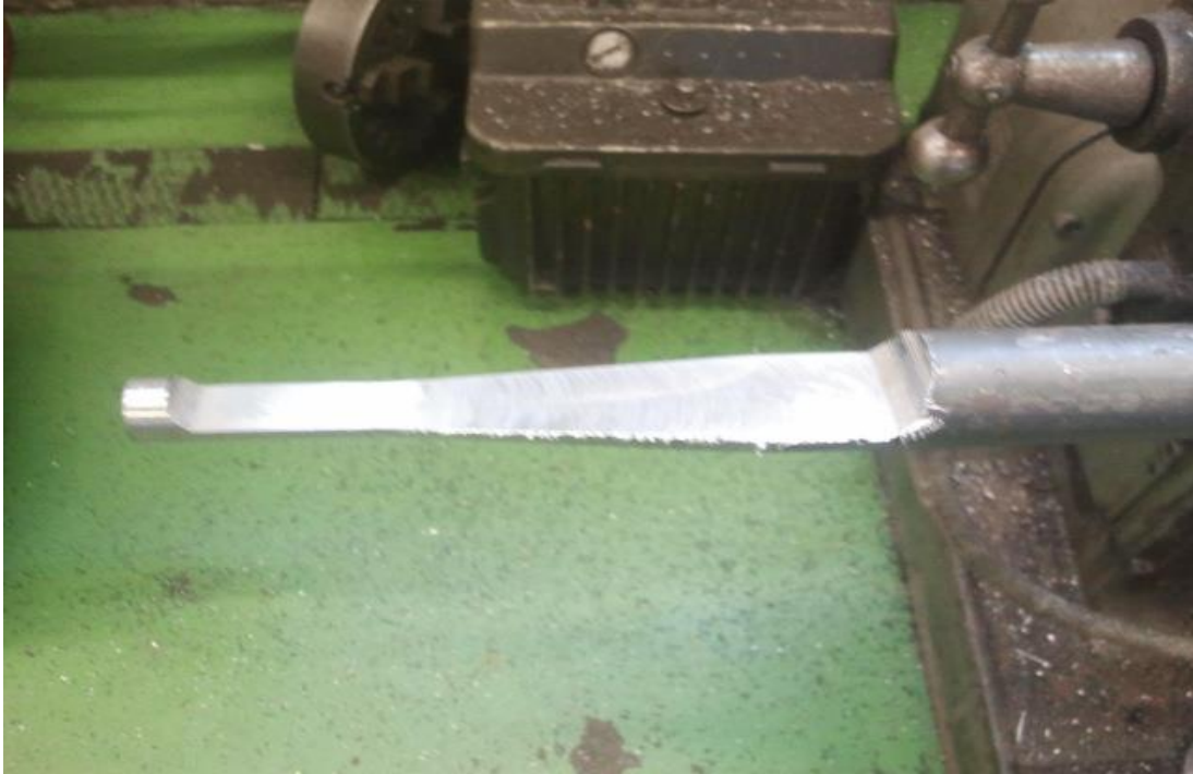
Slika 29. Djelomično obrađen uljevni sustav
