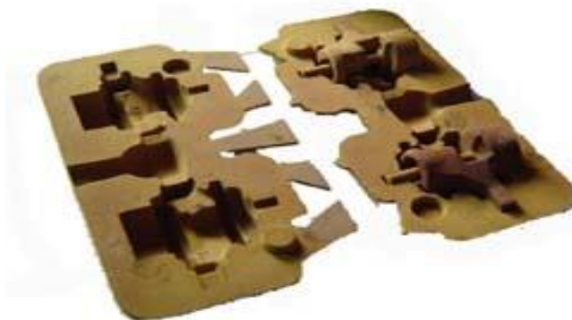
Slika 20. Sklapanje školjkastog kalupa
