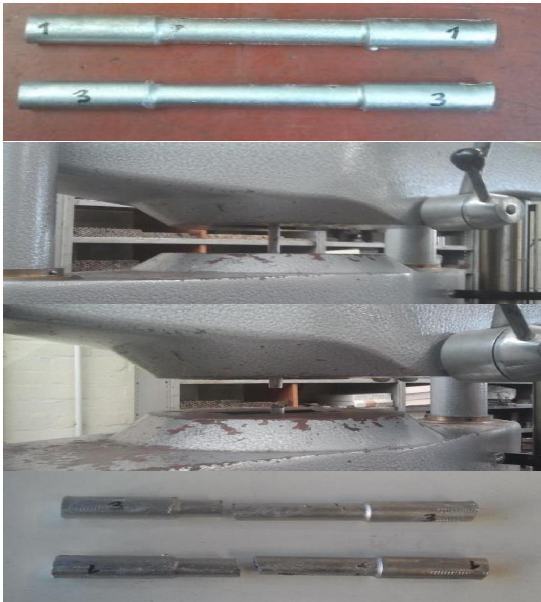
Slika 50. Epruvete, prije, za vrijeme i nakon kidanja
