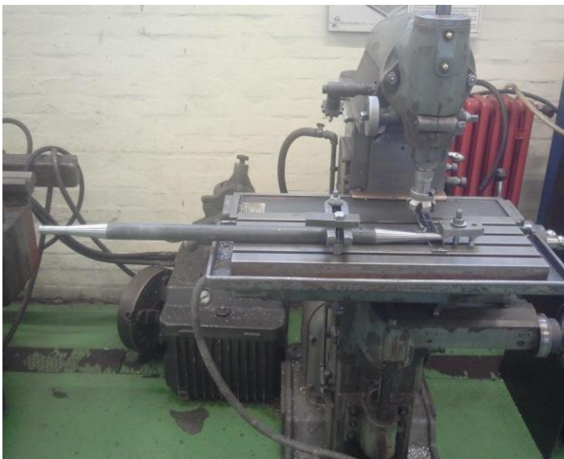
Slika 28. Glodanje čelične šipke na polovinu presjeka
