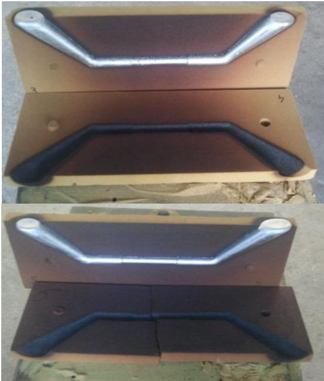
Slika 45. Odljevci i školjke tokom hlađenja
