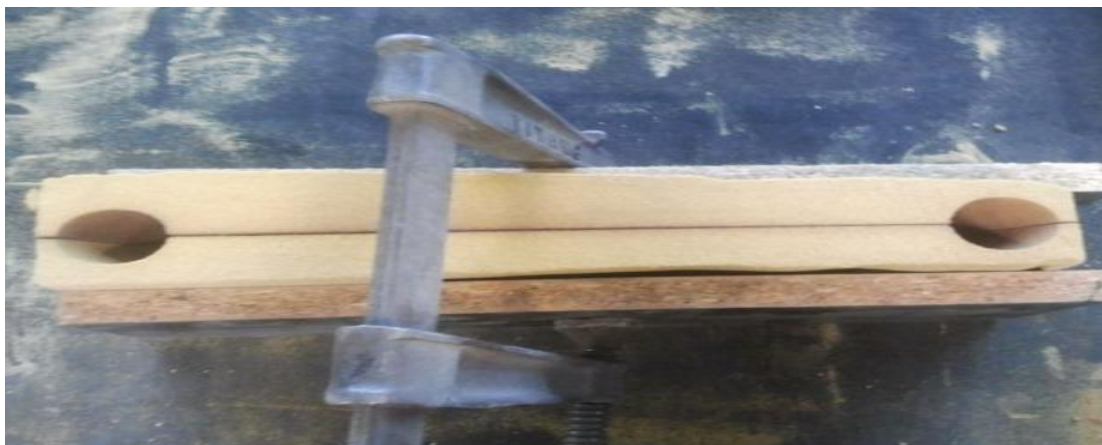
Slika 41. Oblaganje i stezanje kalupa
