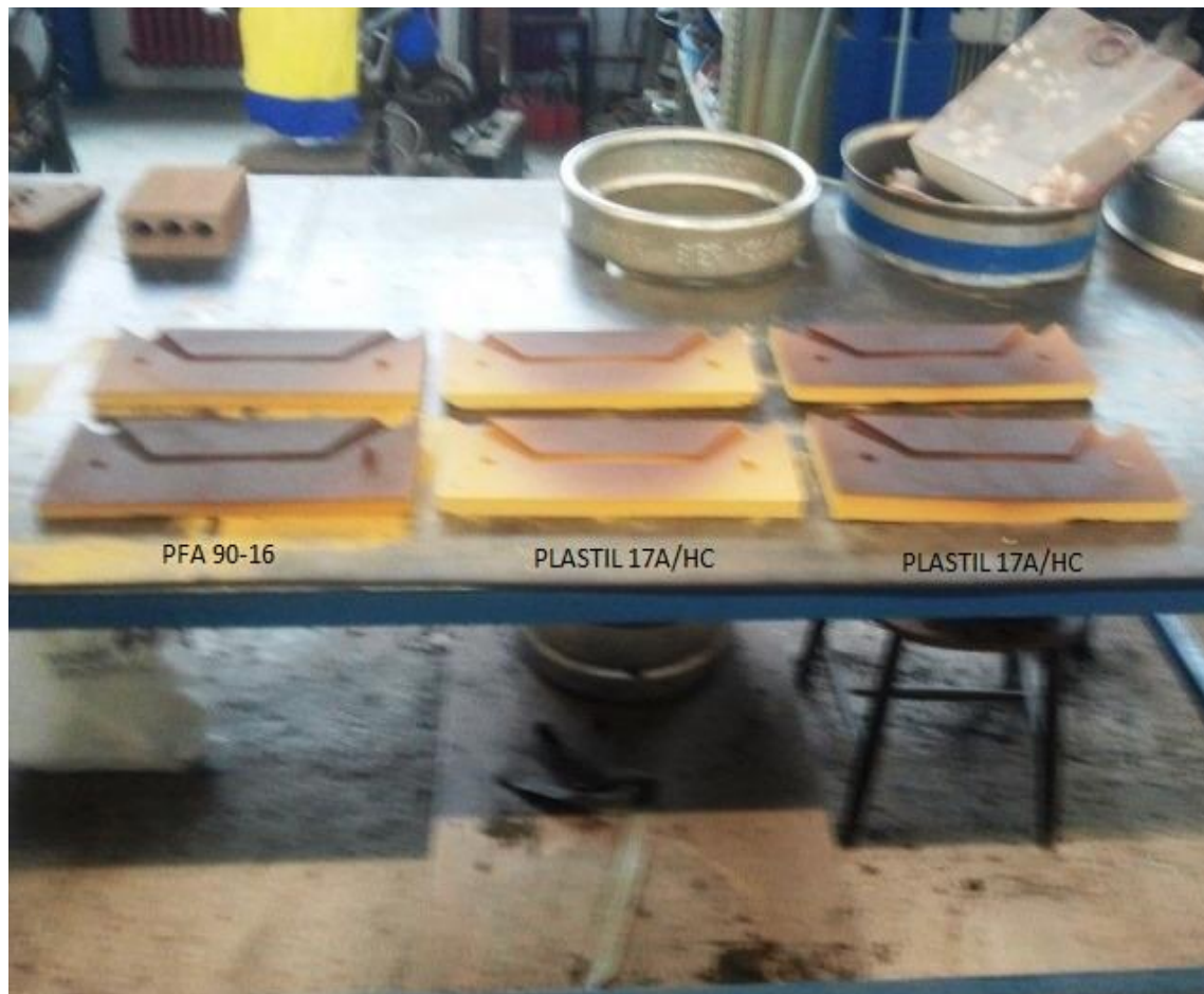
Slika 40. Izrađene školjke spremne za spajanje
