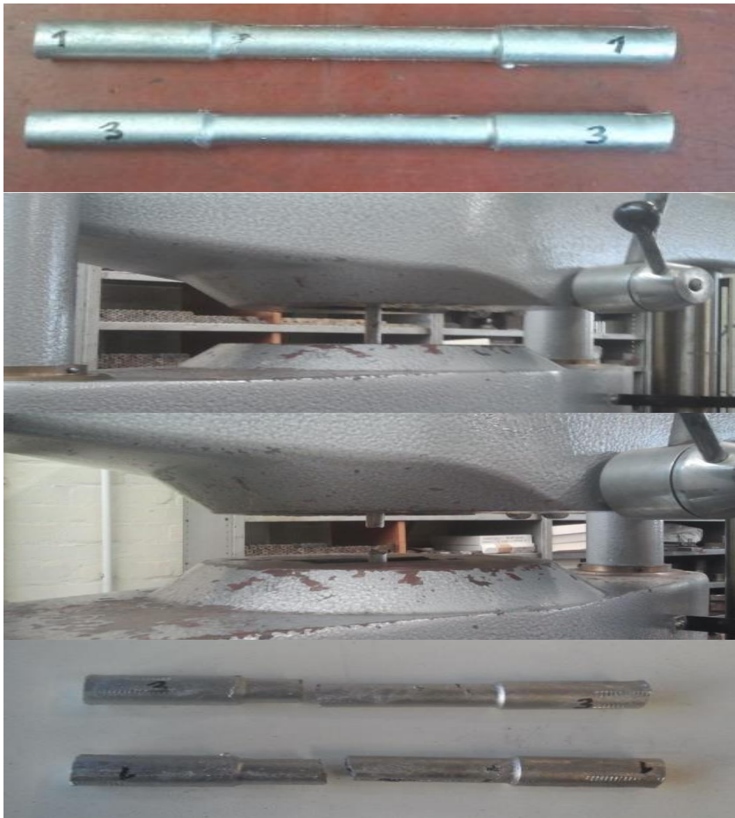
Slika 50. Epruvete, prije, za vrijeme i nakon kidanja
