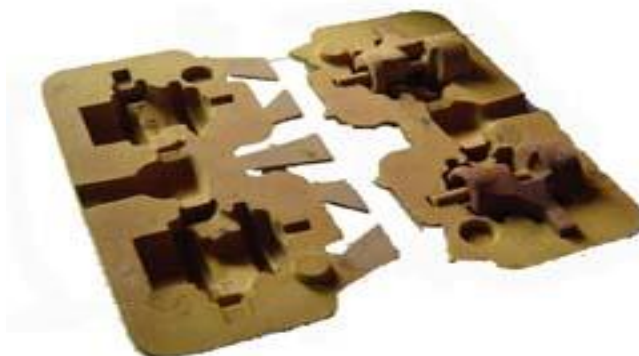
Slika 20. Sklapanje školjkastog kalupa
