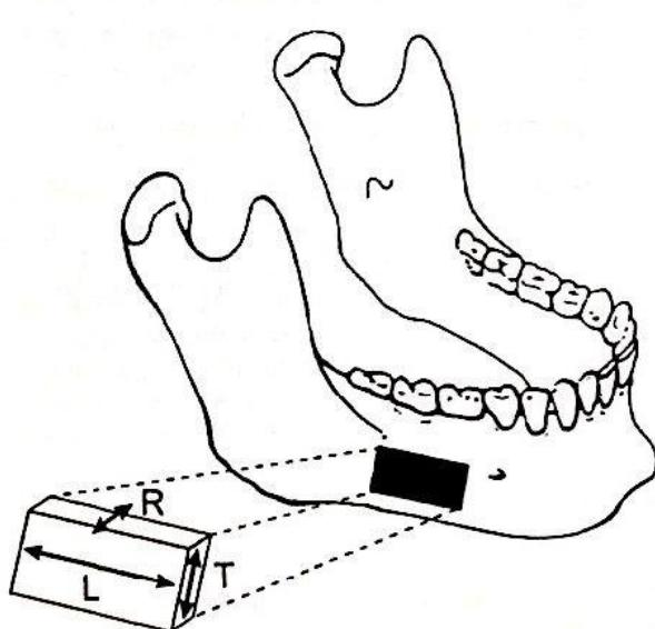
Slika 15. Longitudinalni, tangencijalni i radijalni smjer [15]
