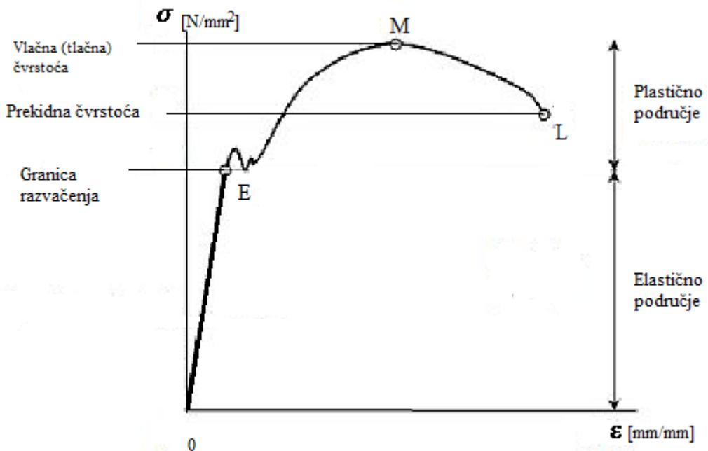
Slika 12. Dijagram naprezanja-istezanja
