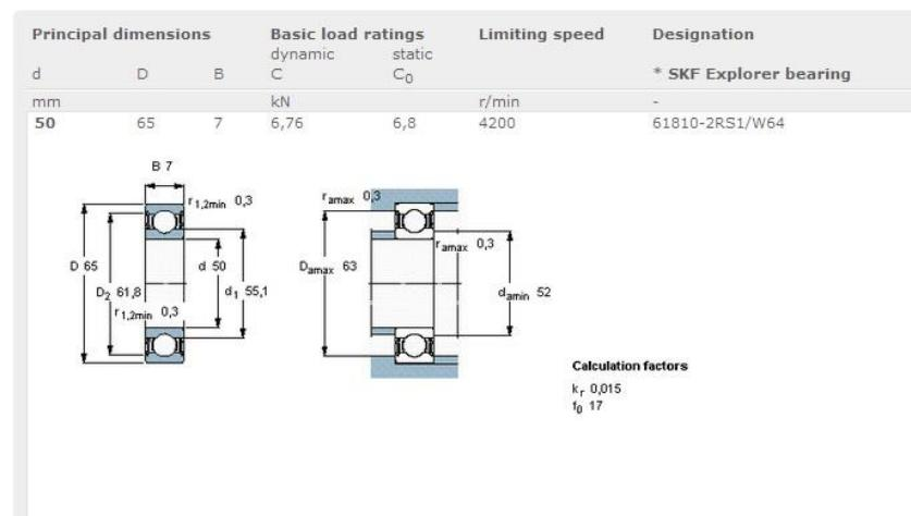
Slika 16. Radijalni ležaj vratila za prijenos snage
