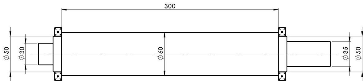
Slika 20. Konstrukcijske mjere vratila za prijenos snage
