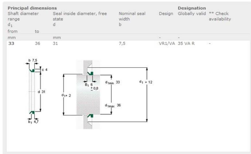
Slika 19. Aksijalna brtva vratila za prijenos snage
