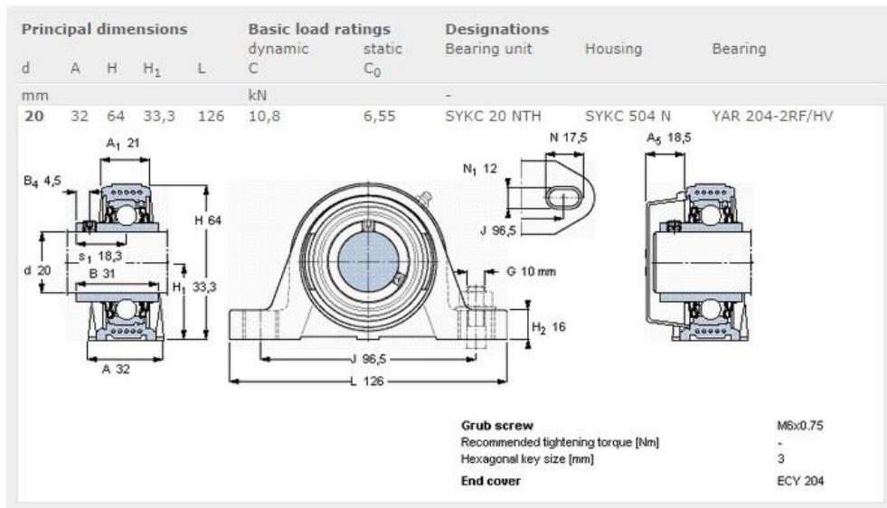
Slika 28. Rješenje ležaja s kućištem
