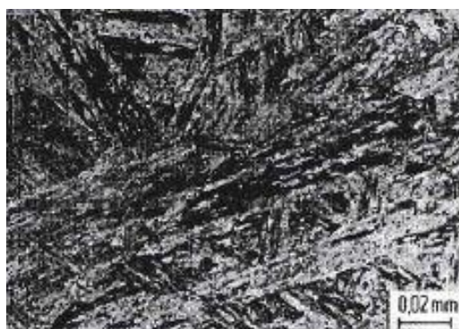
Slika 7. Mikrostruktura martenzitnog nehrđajućeg čelika [2]
