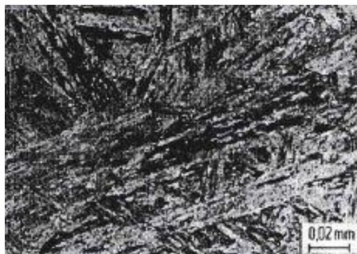
Slika 7. Mikrostruktura martenzitnog nehrđajućeg čelika [2]
