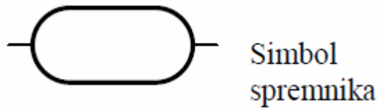
Slika 11: Simbol spremnika zraka (tlačne posude)
