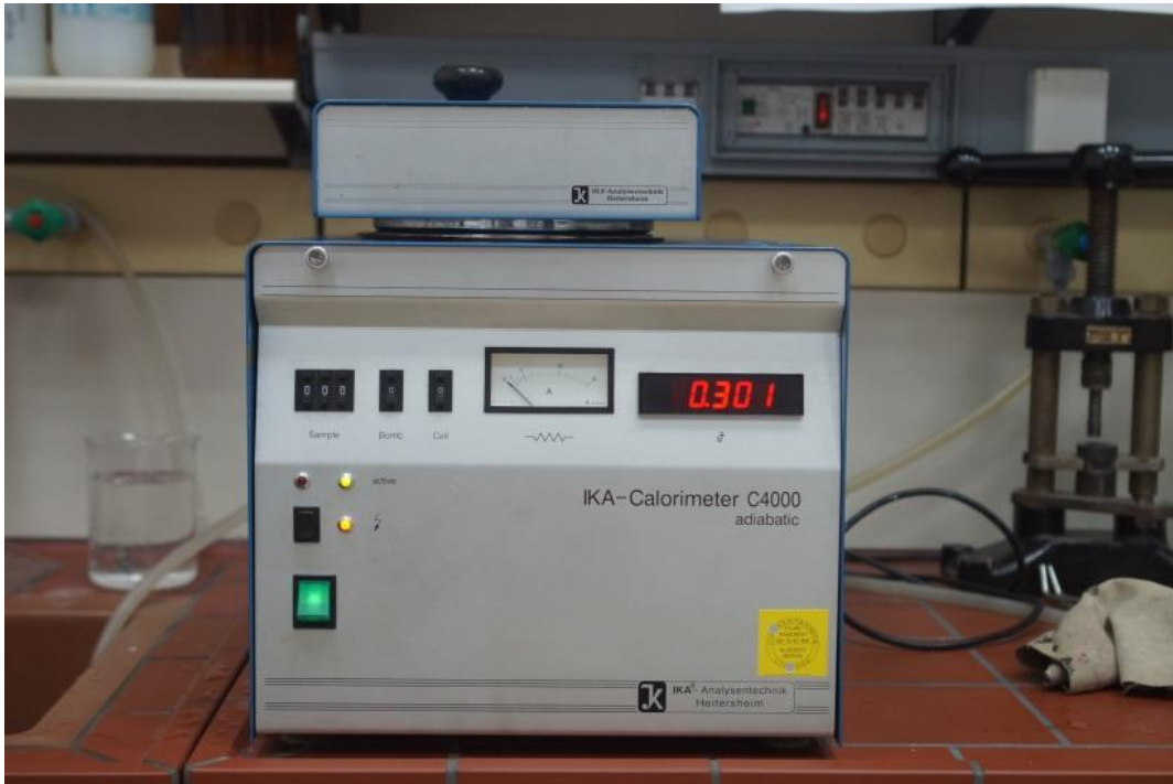
Slika 9: Kalorimetar u radu (32)
