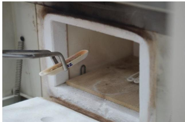
Slika 10: Spaljivanje uzorka peleta
