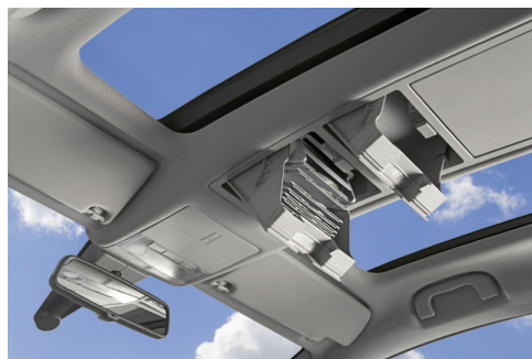
Slika 5.15. Krov automobila izrađen od mješavine ABS/PA [27]
