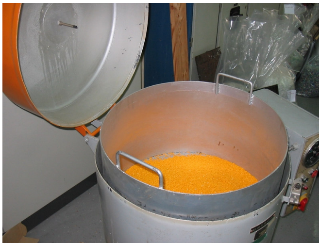
Slika 6.3. Materijal u sušilici
