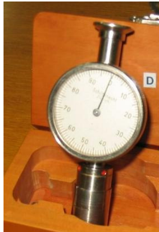
Slika 6.20. Uređaj za mjerenje tvrdoće Shore D
