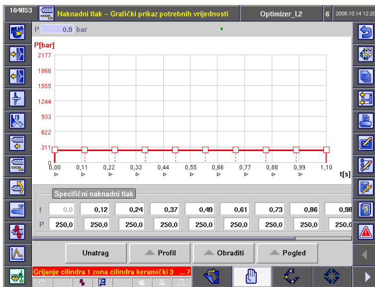
Slika 6.11. Grafički prikaz tlaka i vremena trajanja naknadnog tlaka
