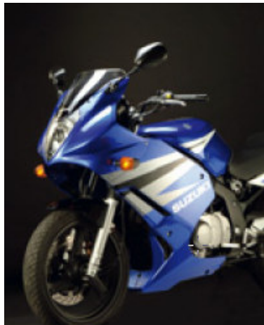
Slika 5.10. Dijelovi karoserije motocikla od ABS-a [13]
