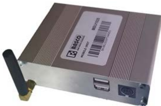
Slika 4.3. GPS-GPRS mobilna jedinica [2]
