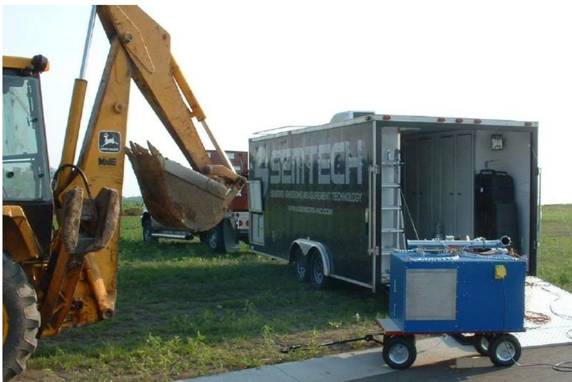
Slika 10.2. Primjer mobilnog mjernog laboratorija za određivanje emisije štetnih tvari motora velikih dimenzija
