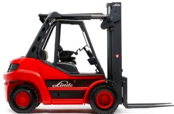
Slika 4.1. Viličar Linde H80D pogonjen Dieselovim motorom snage 85kW [6]
